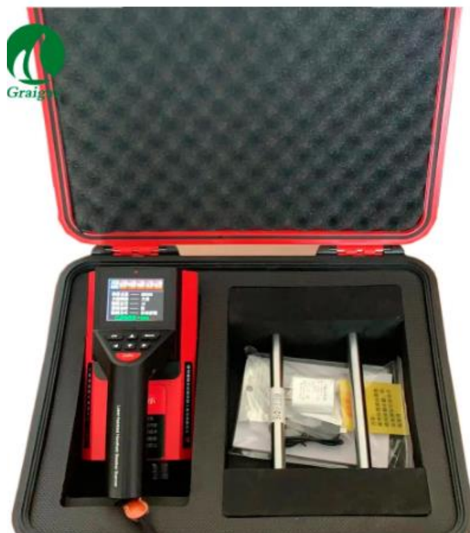
Figura 17. Escáner de acero de refuerzo
