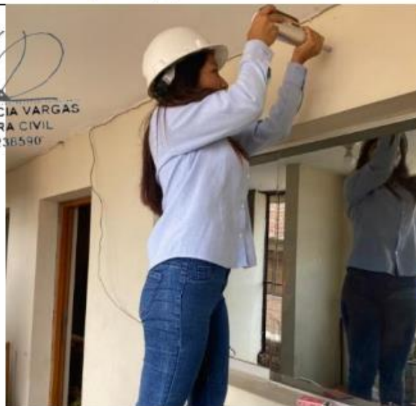
Imagen 2 – Toma de datos [Índice de rebote en viga peraltada].
