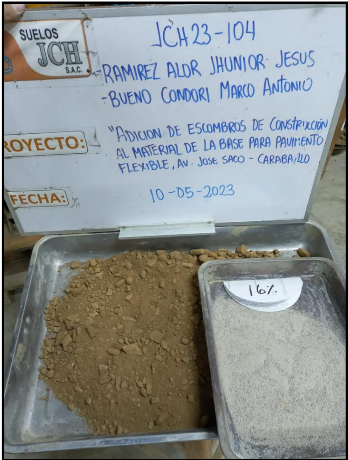
Figura 27. Material granular + 16% de concreto reciclado.
