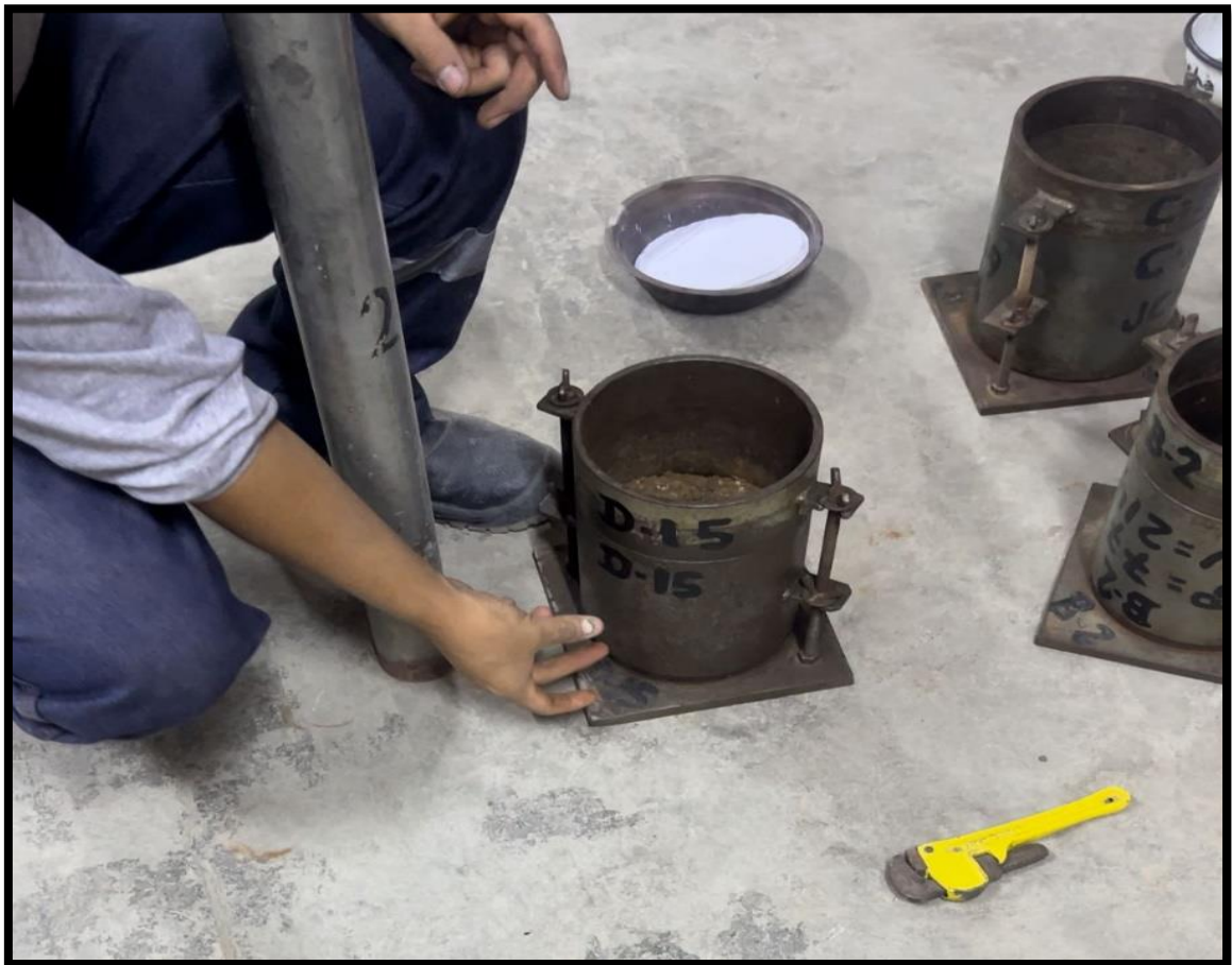
Figura 7. Ensayo de Proctor modificado.
