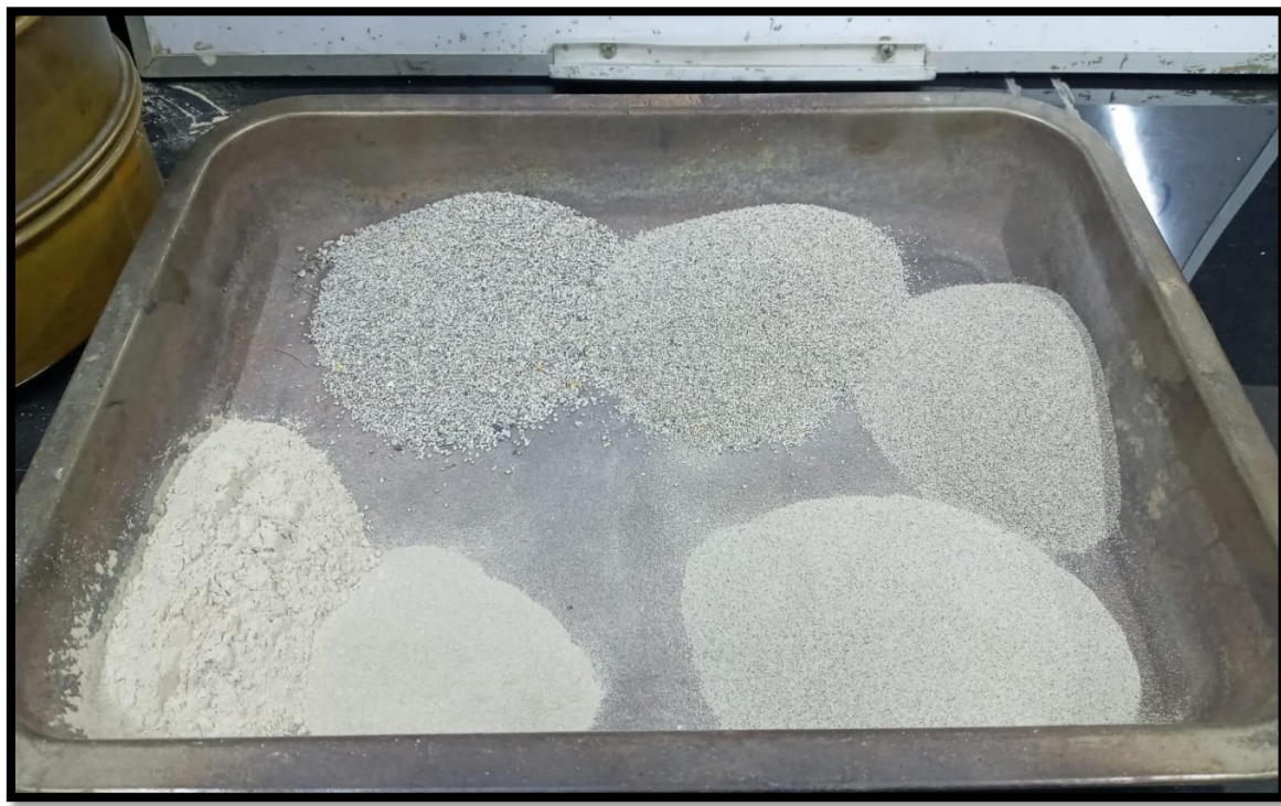
Figura 24. Tamizado de los escombros de construcción.
