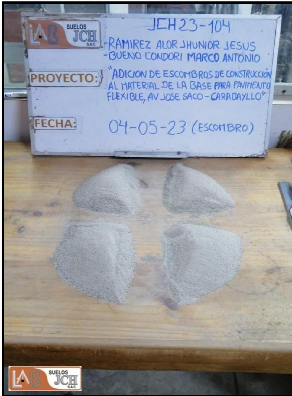
Figura 21. División en 4 porciones de los escombros.
