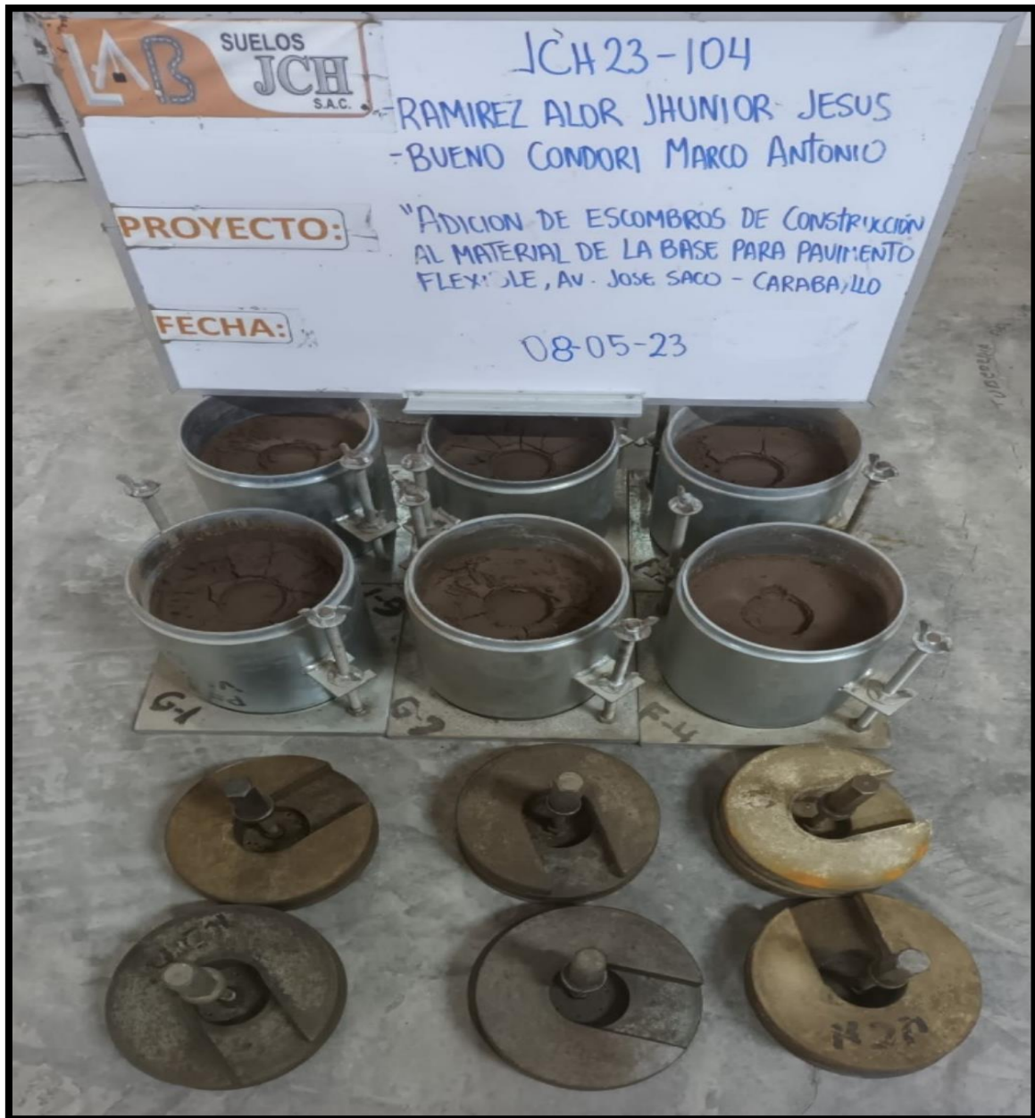
Figura 42. Ensayo de CBR a la base con los escombros de construcción.
