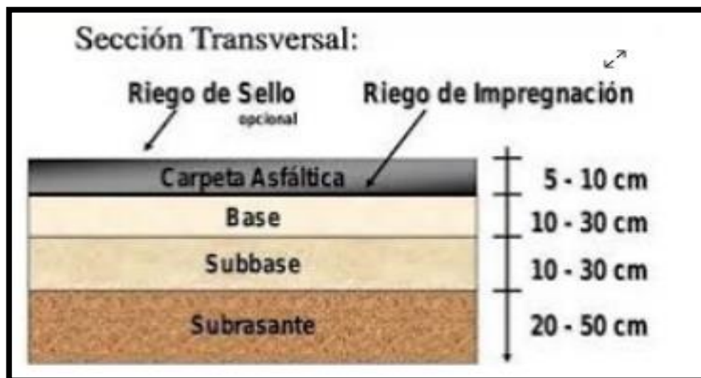
Figura 1. Sección transversal de pavimento flexible.
