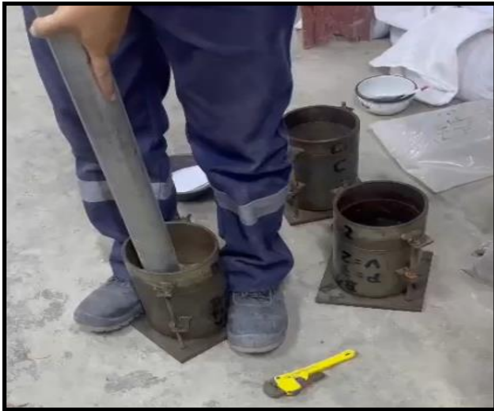
Figura 37. Aplicando cantidad de golpes del Proctor Modificado.
