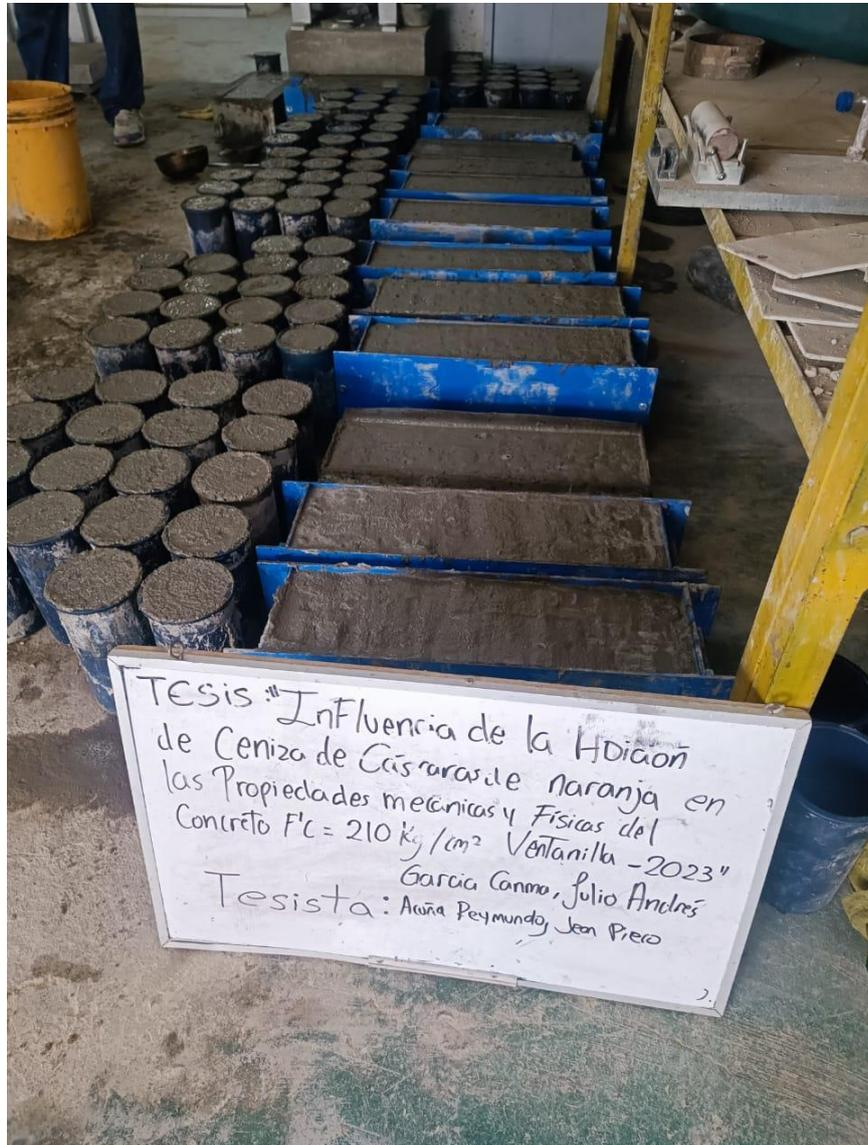
*Figura 39. Probetas y vigas para los ensayos mecánicos.*
