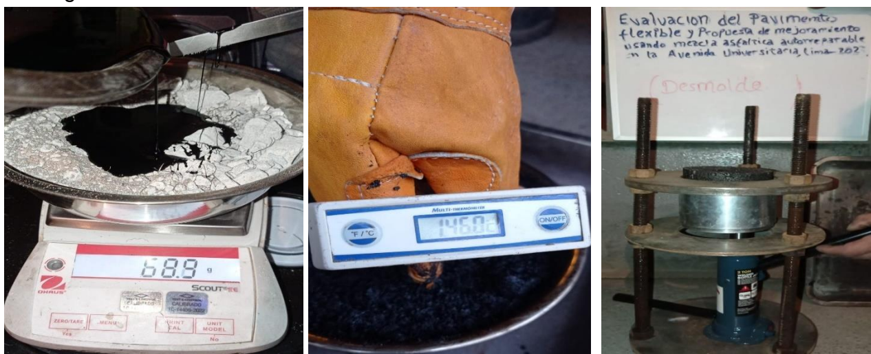
Figura 38, Procedimiento de preparación de mezcla asfáltica, Fuente: propia.
