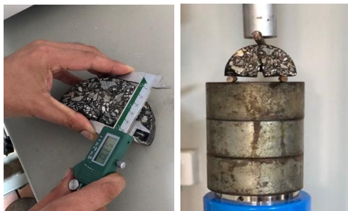
Figura 57, Ensayo de flexión triaxial, Fuente: Propia.
