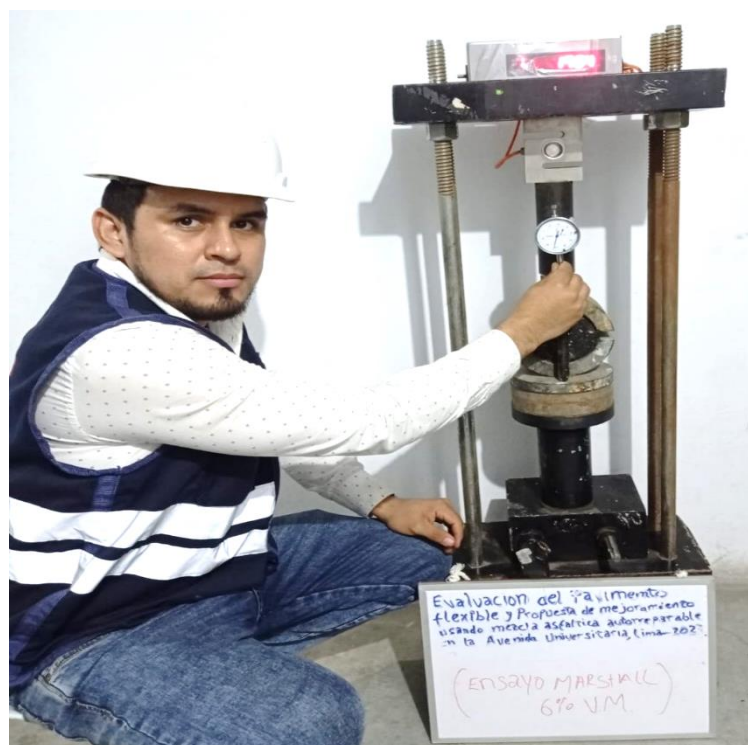
Figura 40, Ensayo de estabilidad Marshall, Fuente: propia.
