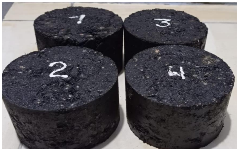
Figura 39, Briquetas recién desmoldadas, Fuente: propia.
