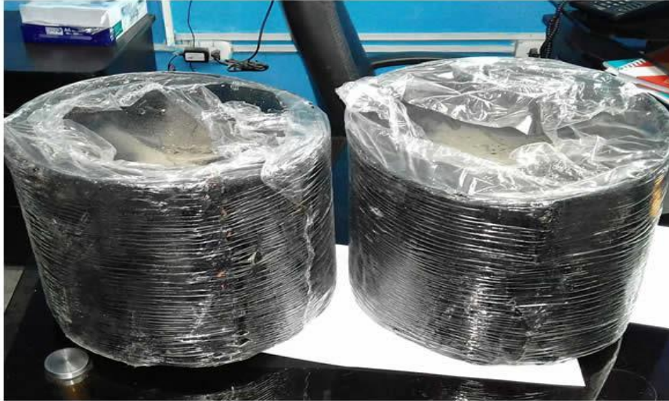
Figura 11, Cemento Asfáltico a Temperatura Ambiente, Fuente: Minaya Y Ordoñez, Diseñando pavimentos con aditivos, ICG.
