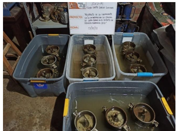
Figura 32: Ensayos de CBR
