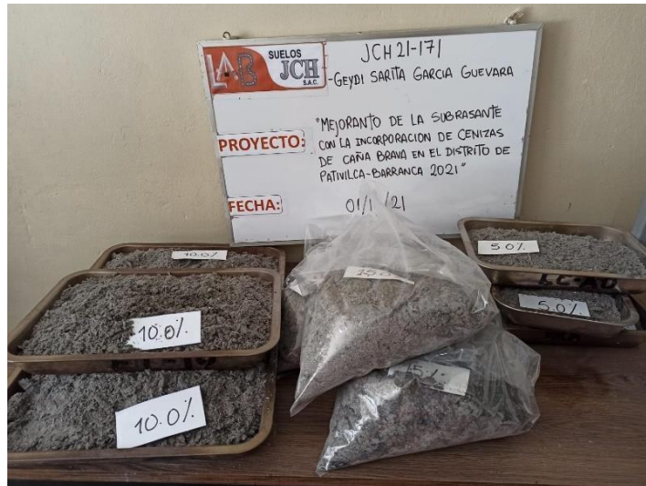
Figura 2. Ensayo de Proctor modificado, CBR con la incorporación de ceniza
