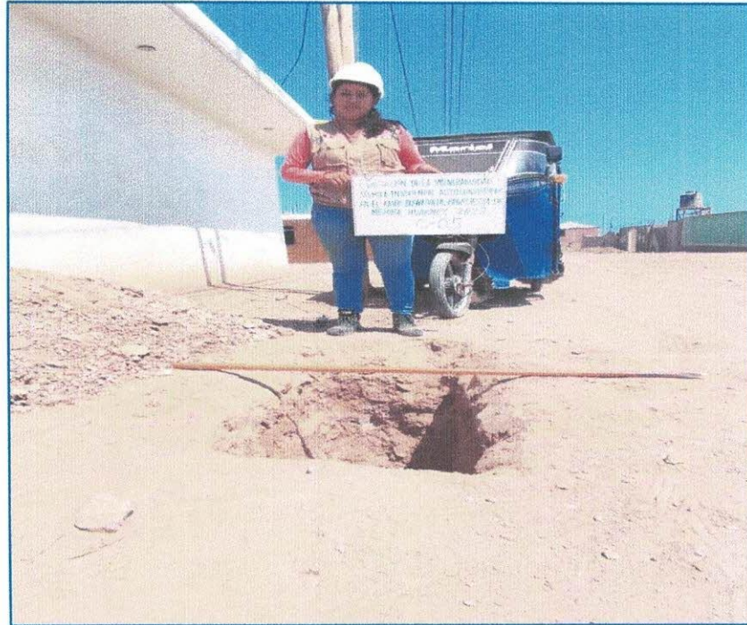
Imagen 33: se verifica la ubicación de la calicata C-05
