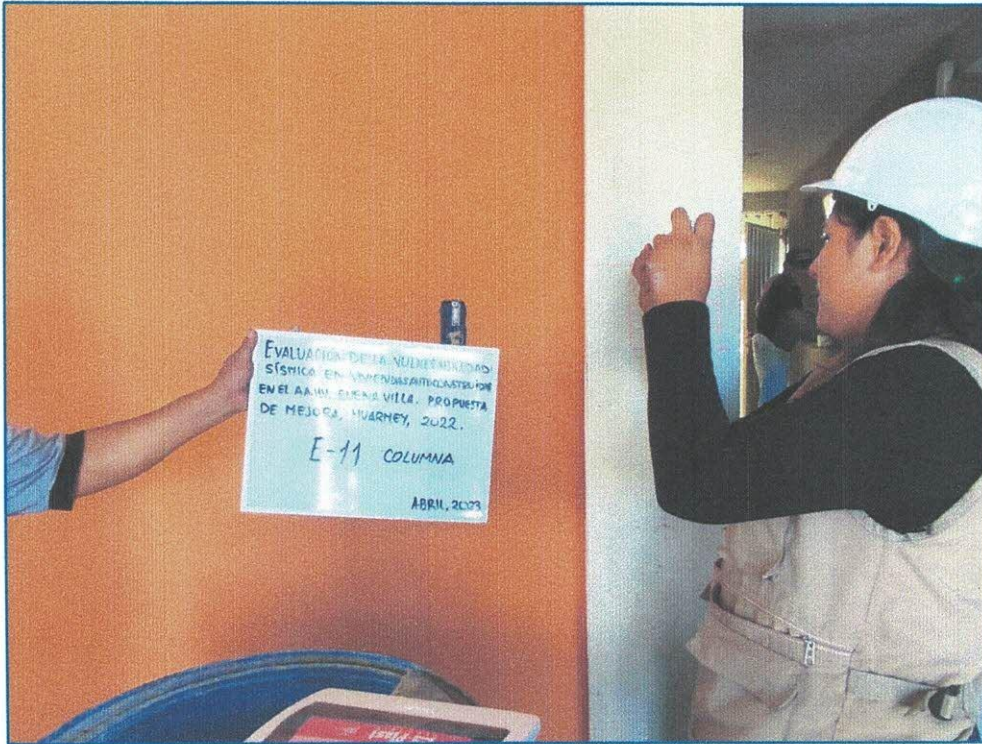
Imagen 15: Ensayo de Esclerometria en vivienda Mz Q– Lt 01-AA.HH. Buena Villa, Huarney.
