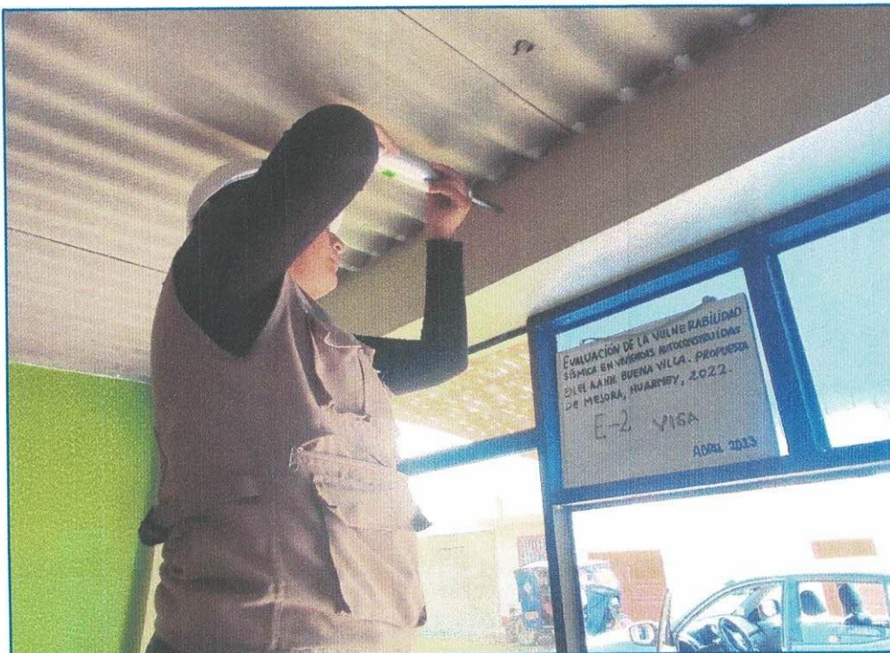
Imagen 06: Ensayo de Esclerometria en vivienda Mz P– Lt 13-AA.HH. Buena Villa, Huarmey.
