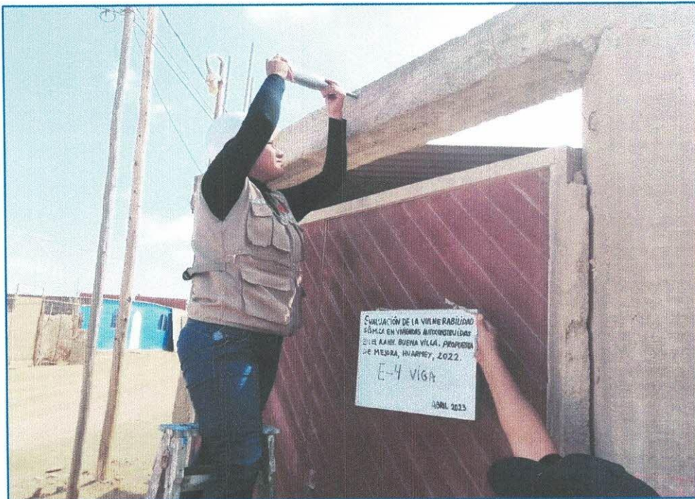
Imagen 08: del Ensayo de Esclerometria en vivienda Mz Q– Lt 08 -AA.HH. Buena Villa, Huarmey.
