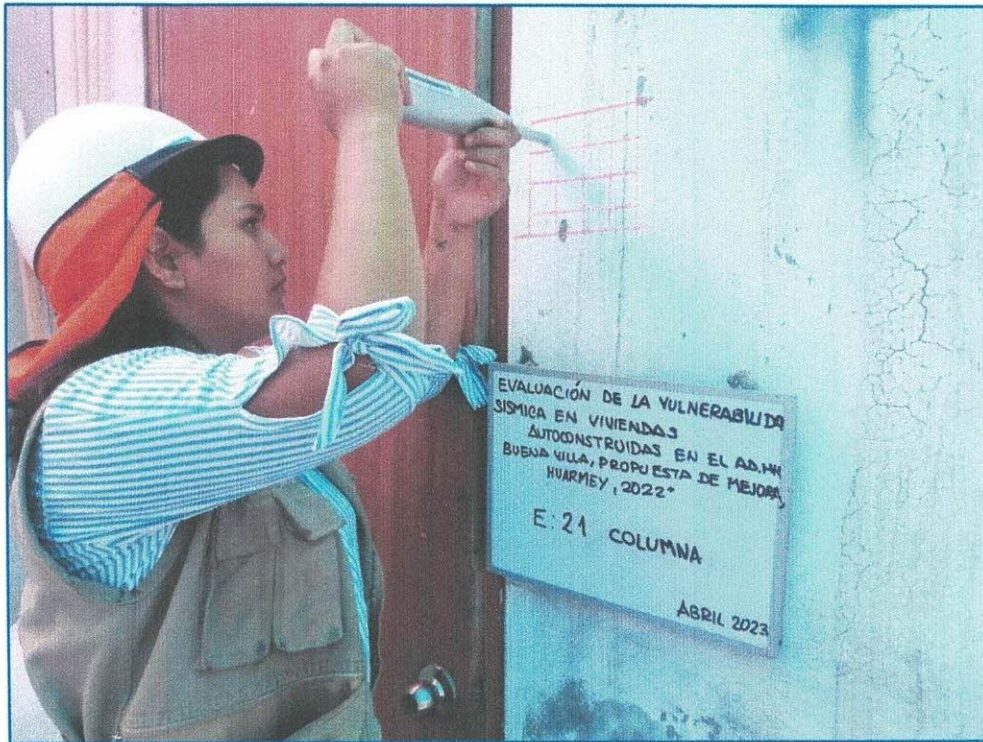
Imagen 25: Ensayo de Esclerometria en vivienda Mz O– Lt 02-AA.HH. Buena Villa, Huarmey.
