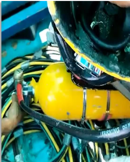
El Tanque de aire comprimido no fue recargado
