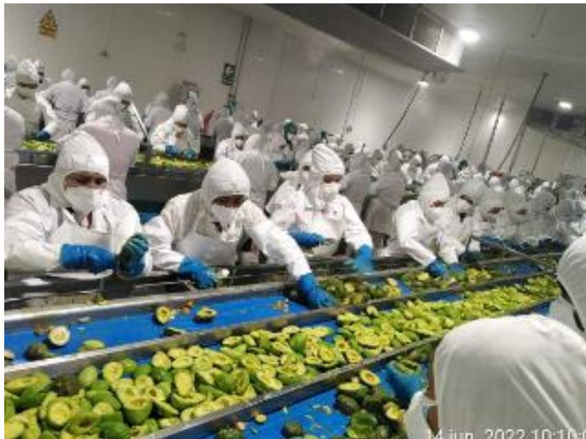
**Figura 1.** *Proceso manual de despepado y pelado de palta.*
