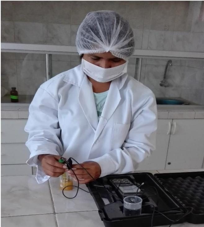
Figura 8: medición del pH de la bebida energizante
