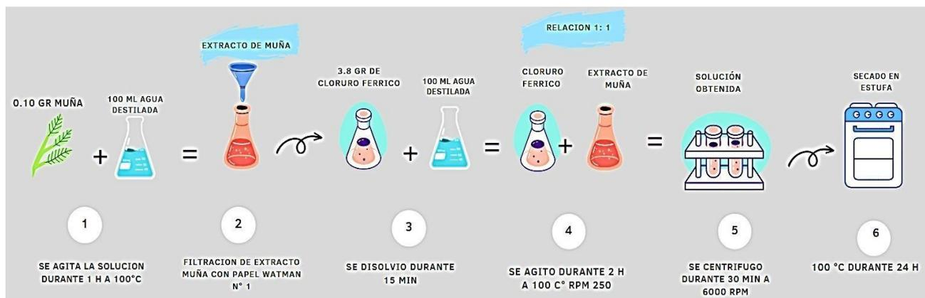
Figura 5. Procedimiento para la obtención de nanopartículas de hierro
