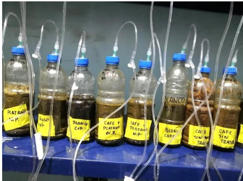
*Figura 9. Sistema de codigestión anaerobia*
