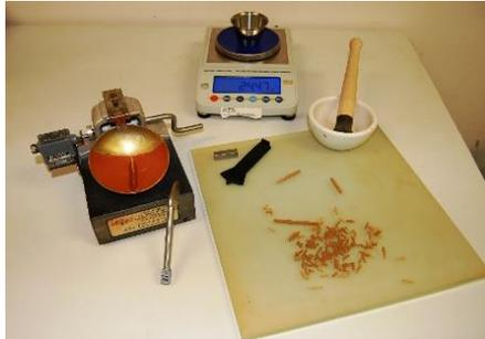
**Figura N° 3:** Herramientas de ensayo de límite de atterberg
