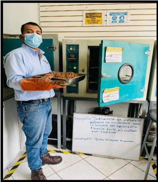
**Figura N°39:** Ensayo de contenido de humedad
