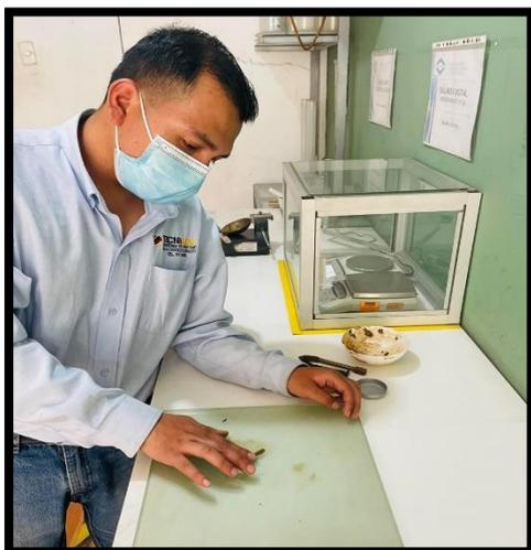
**Figura N° 32:** Ensayo de límite de atterberg
