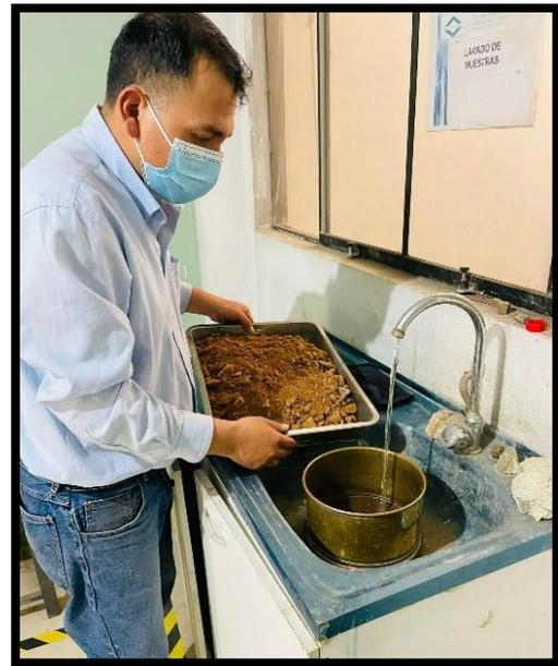
**Figura N°40:** Lavado de muestra de la muestra patrón
