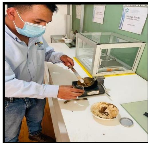
**Figura N°33:** Ensayo de límite de atterberg
