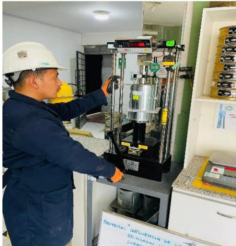
**Figura N°37:** Ensayo de CBR
