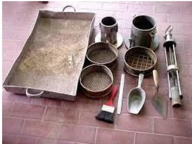
**figura N°04: Herramientas del ensayo del Proctor modificado**
