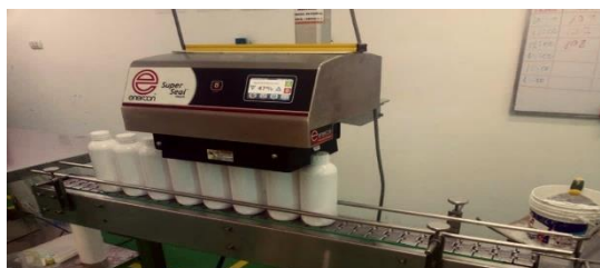
Figura 17. Faja transportadora con máquina de inducción
