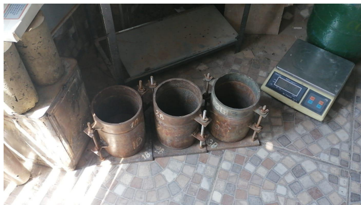
Figura 34: muestra en tres moldes CBR estandarizados
