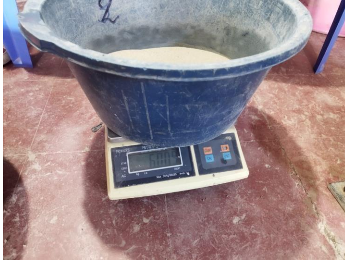
Figura 17: pesado de la muestra
