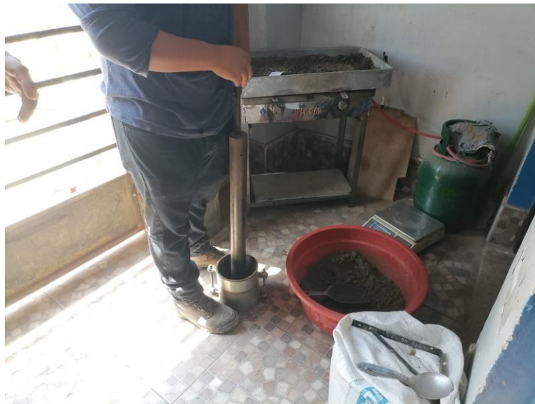
Figura 62: muestra en tres moldes CBR estandarizados
