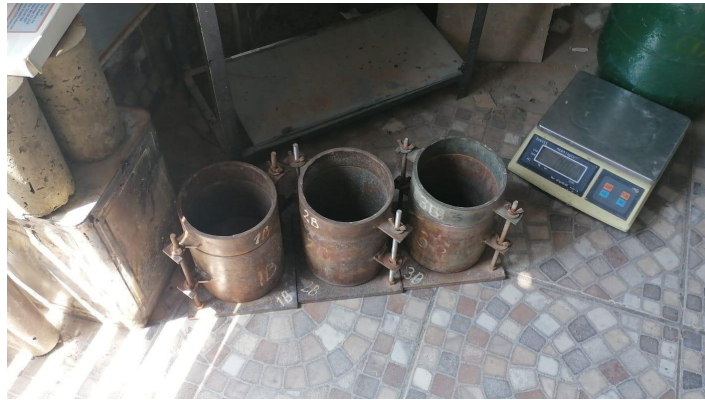
Figura 62: muestra en tres moldes CBR estandarizados
