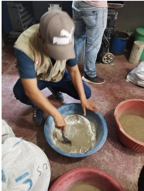
Figura 44: mezcla la cal más el cloruro de sodio con el suelo
