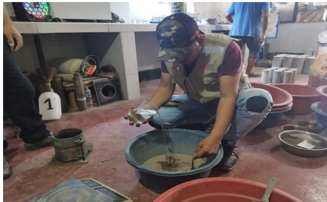
Figura 33: Añadir agua a una muestra de suelo para alcanzar la humedad
