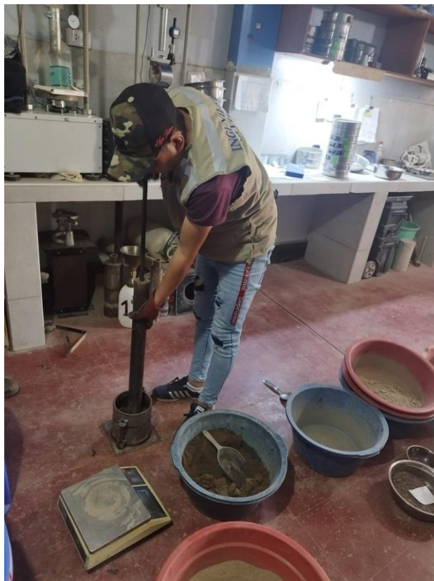
Figura 51: compactación de las capas
