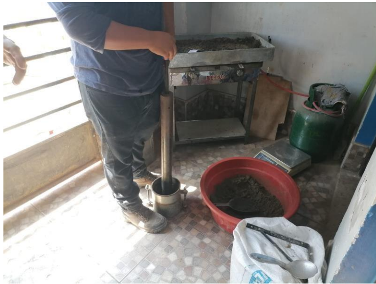
Figura 35: muestra en tres moldes CBR estandarizados
