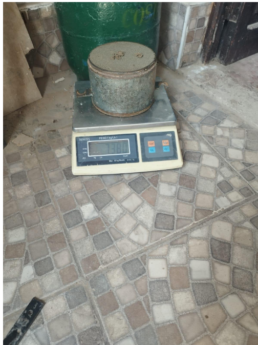
Figura 18: peso del molde sin collar
