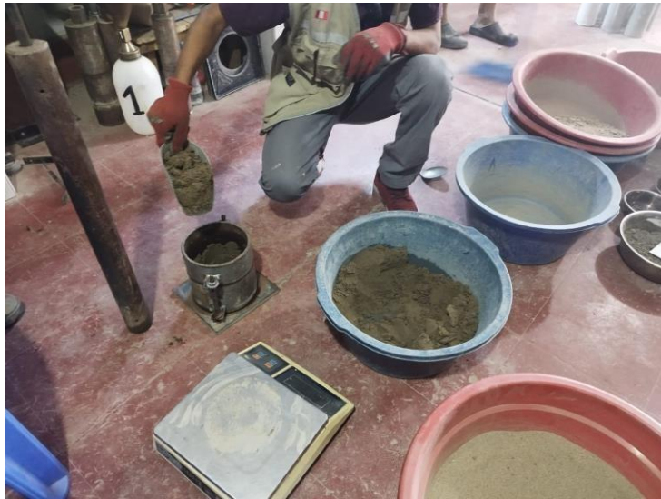
Figura 50: compactación de las capas
