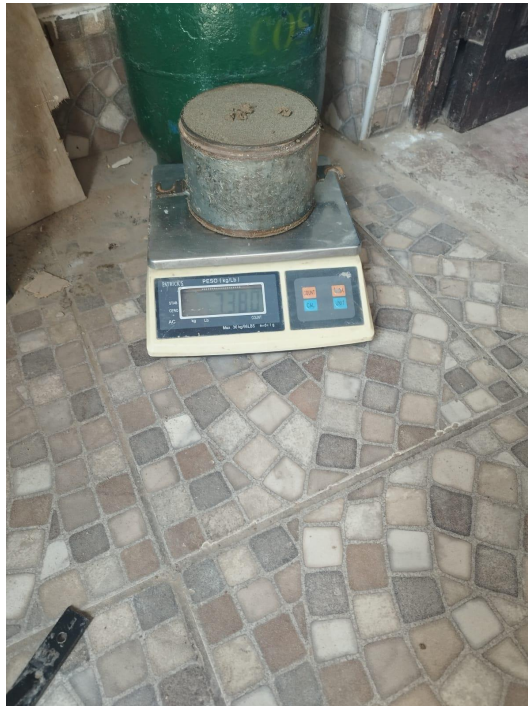
Figura 46: peso del molde sin collar
