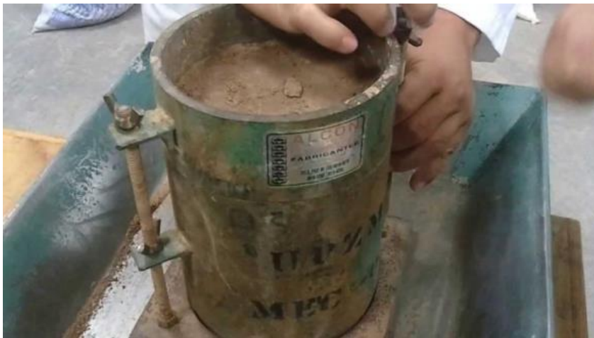
Figura 24: la última capa compactada
