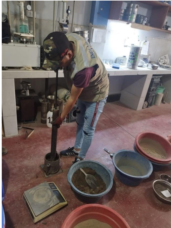
Figura 21: compactación de las capas
