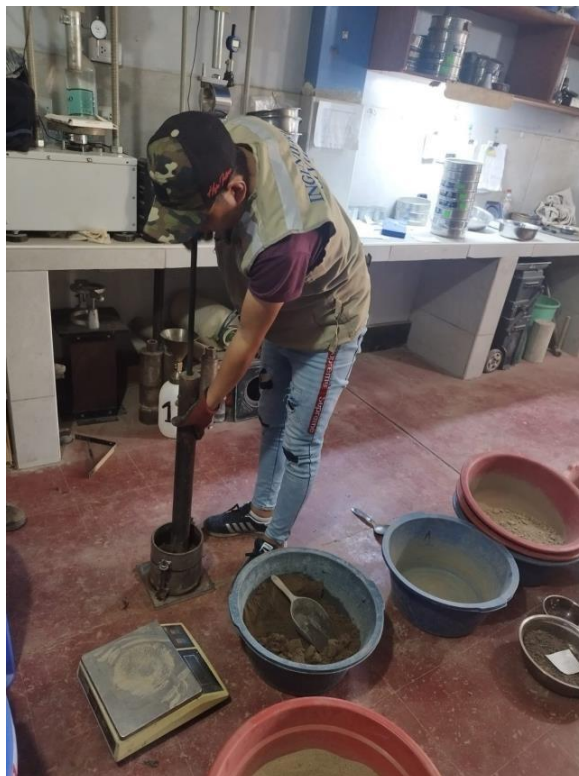
Figura 49: compactación de las capas
