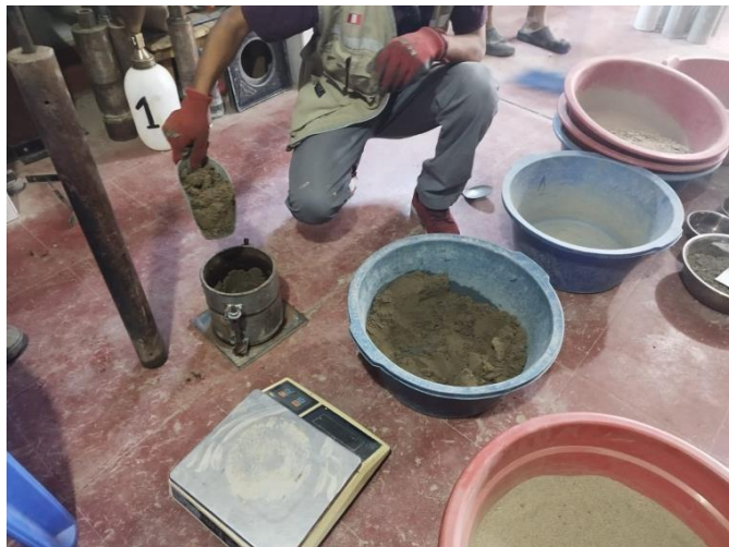
Figura 22: compactación de las capas
