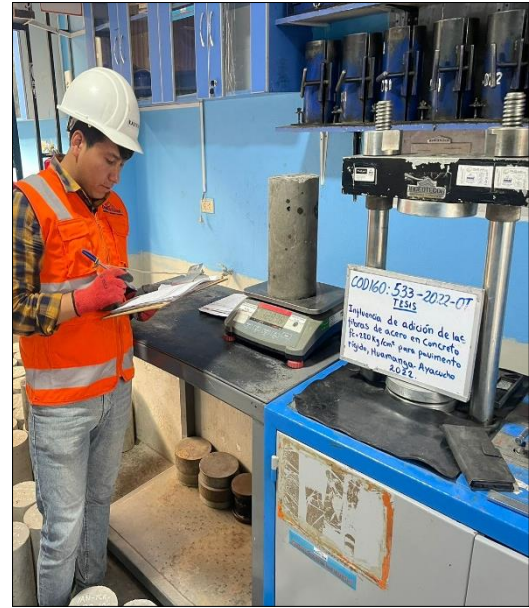
Figura N° 92: Apunte de medidas y peso de la probeta cilíndrica (con edad de 07 días)
