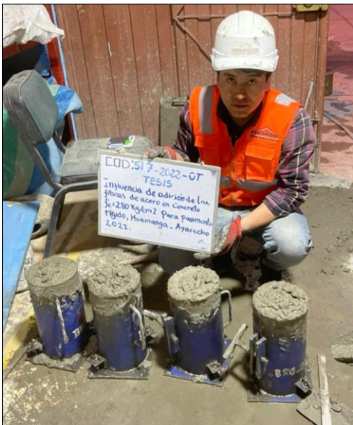
Figura N° 61: Muestra de la elaboración de las probetas cilíndricas
