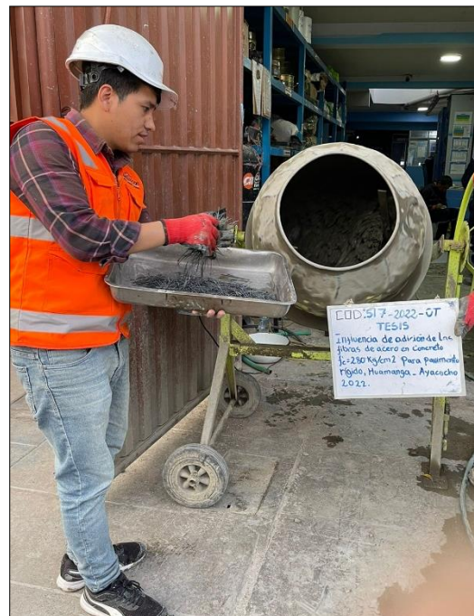
Figura N° 54: incorporación de acero en movimiento de Mezcladora, según diseño de mezcla (5% de fibras de acero).
