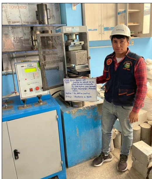
Figura N° 72: Colocación de la probeta prismática (sin fibras de acero) a la máquina para el ensayo de Resistencia a la flexión
