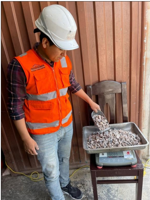
Figura N° 47: Peso del A.G según diseño de mezcla (3% de fibras de acero).
