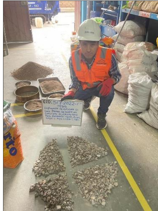
Figura Nº 08: Cuarteo del A.G Fuente: Elaboración propia
