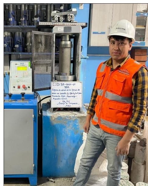
Figura N° 102: Rotura de la probeta cilíndrica con 7% de fibras de acero (con edad de 28 días)
