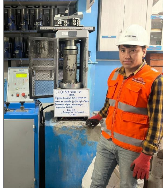
Figura N° 100: Rotura de la probeta cilíndrica con 3% de fibras de acero (con edad de 28 días)
