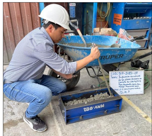
Figura N° 64: Aplicación de 30 golpes en cada capa con varilla lisa de 5/8"
