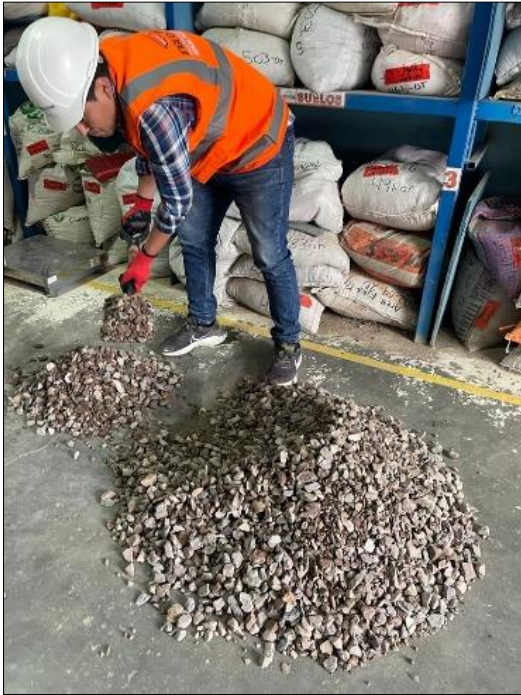
Figura Nº 07: Homogenización del A.G Fuente: Elaboración propia
