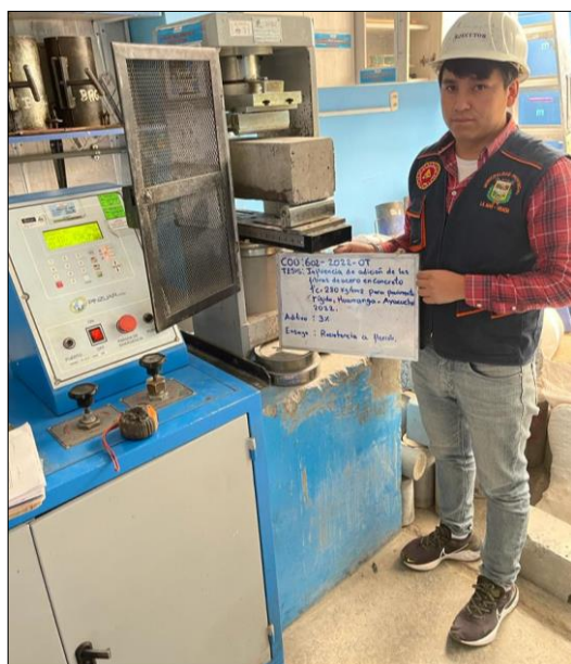
Figura N° 77: Colocación de la probeta prismática (con 3% de fibras de acero) a la máquina para el ensayo de Resistencia a la flexión
