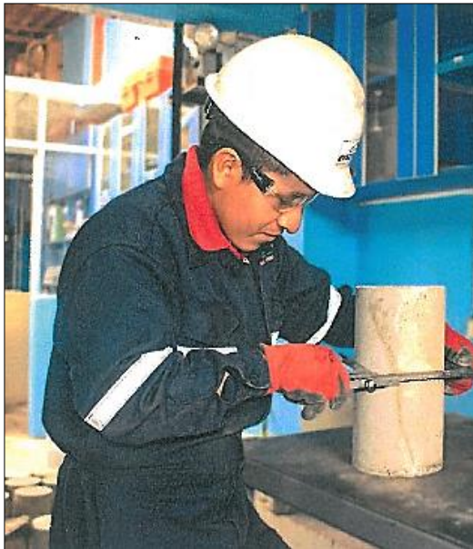
Figura N° 95: Toma de medidas de la probeta cilíndrica con 5% de fibras de acero (con edad de 14 días)
