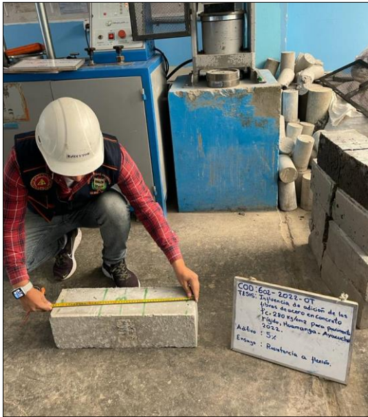
Figura N° 80: Toma de medidas de la probeta prismática (con 5% de fibras de acero)
