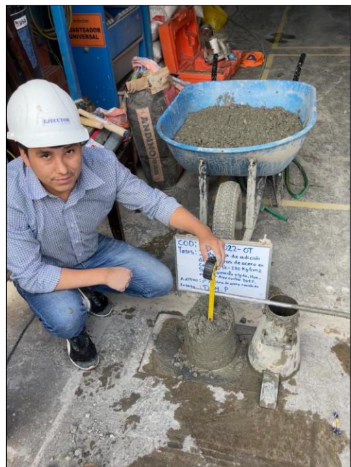
Figura N° 107: Medición del asentamiento de concreto en 5 1/4" (7% de fibras de acero).
