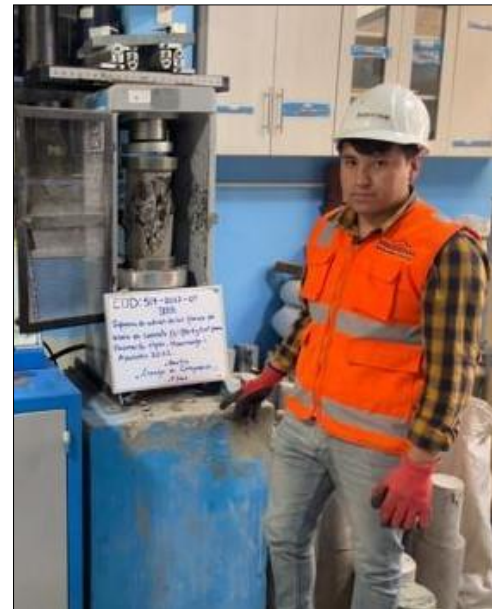
Figura N° 94: Rotura de la probeta cilíndrica (con edad de 07 días)
