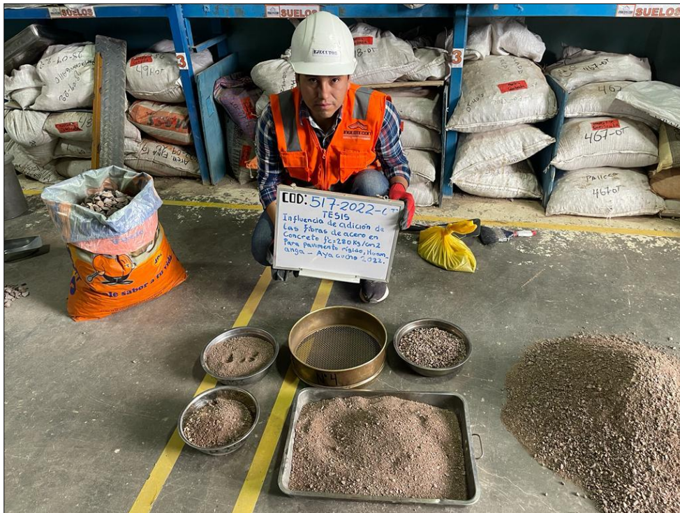
Figura 16: Determinación de material más fino que el tamiz No. 200 de A.F
