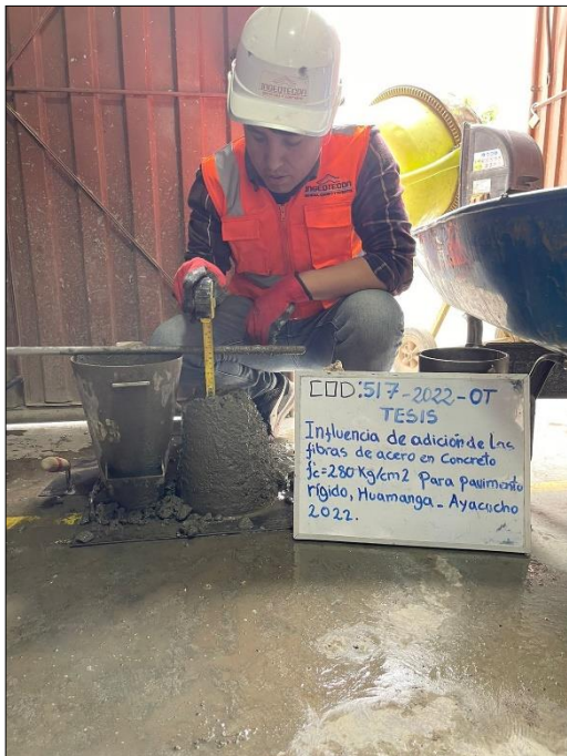
Figura N° 104: Medición del asentamiento de concreto en 4 1/2" (mezcla neutra).
