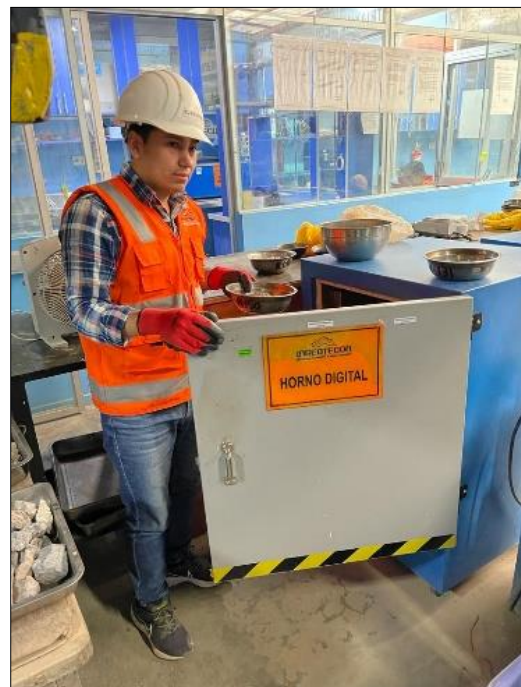
Figura Nº 10: Secado en horno digital del A.G Fuente: Elaboración Propia
