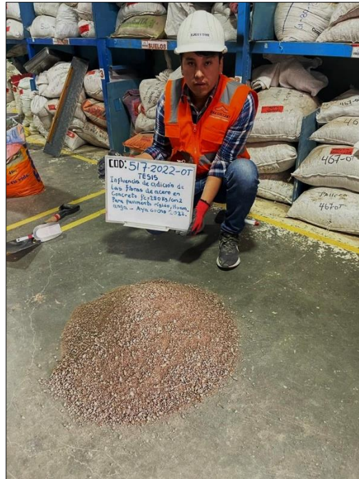
Figura Nº 12: homogenizado de A.F Fuente: Elaboración propia
