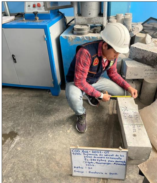
Figura N° 75: Toma de medidas de la probeta prismática (con 3% de fibras de acero)
