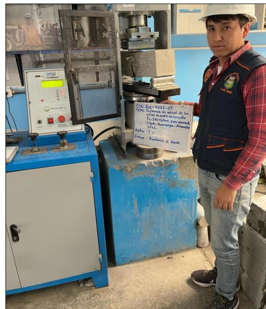
Figura N° 88: Rotura de la probeta prismática (con 7% de fibras de acero) a los tercios de la luz
