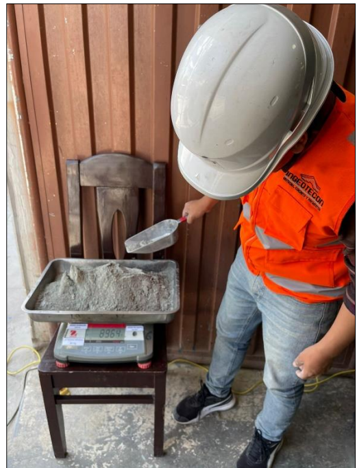
Figura N° 52: Peso del cemento según diseño de mezcla (5% de fibras de acero).
