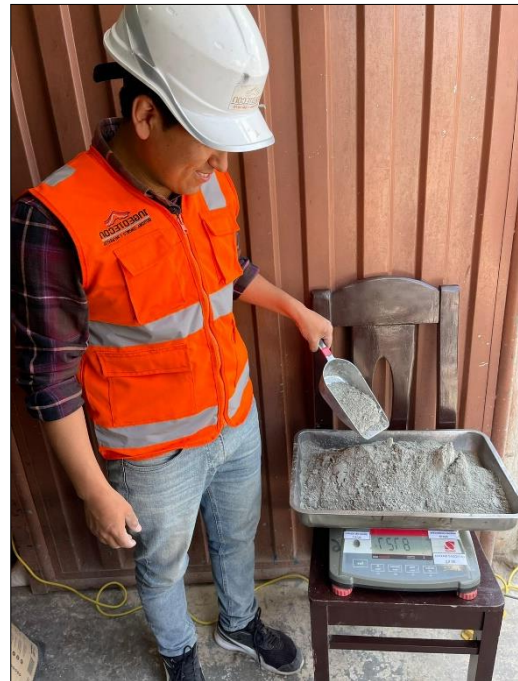
Figura N° 48: Peso del cemento según diseño de mezcla (3% de fibras de acero).
