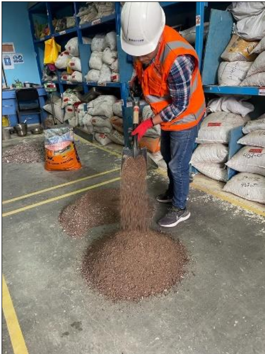
Figura Nº 11: Homogenización de A.F Fuente: Elaboración propia
