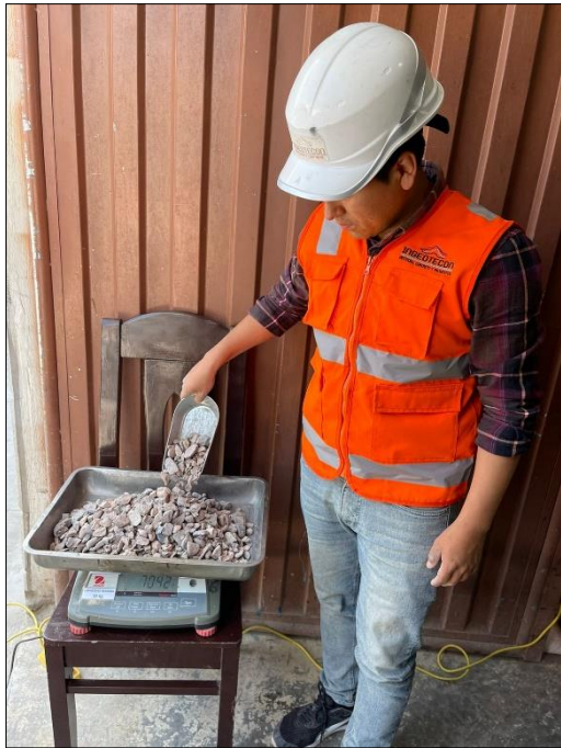
Figura N° 51: Peso del A.G según diseño de mezcla (5% de fibras de acero).
