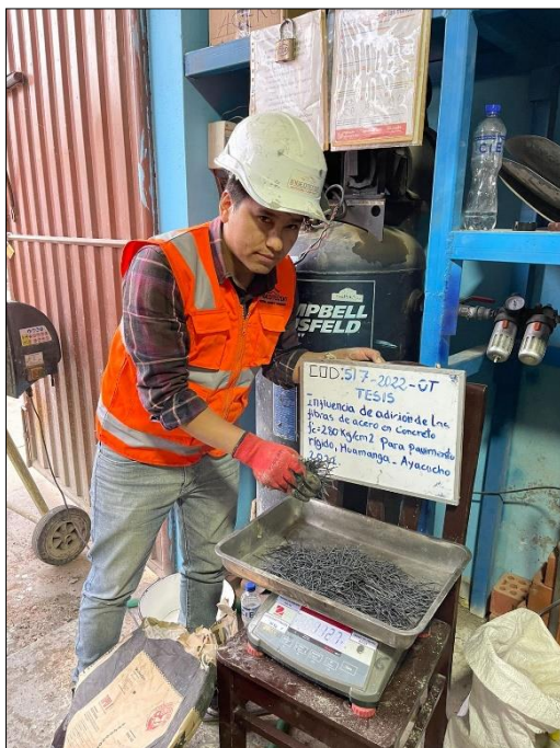
Figura N° 53: Peso del acero según diseño de mezcla (5% de fibras de acero).
