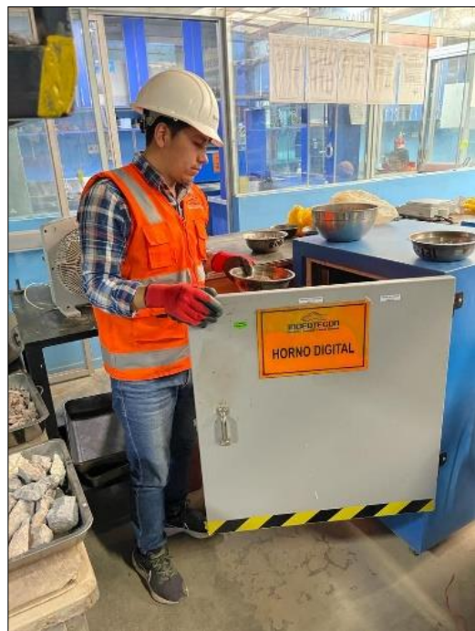
Figura Nº 14: Secado en horno digital del A.F Fuente: Elaboración Propia
