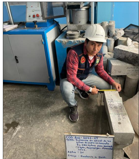
Figura N° 76: Toma de medidas de la probeta prismática (con 3% de fibras de acero)
