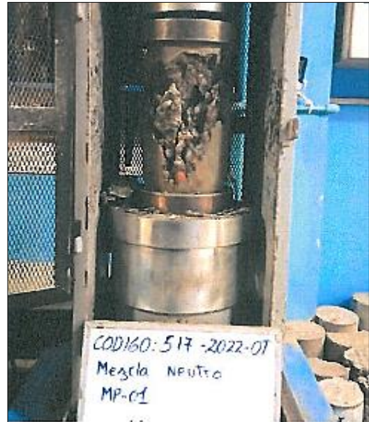
Figura N° 96: Rotura de la probeta cilíndrica sin fibras de acero (con edad de 14 días)
