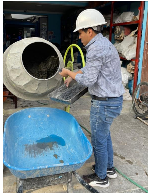
Figura N° 58: incorporación de acero en movimiento de Mezcladora, según diseño de mezcla (7% de fibras de acero).
