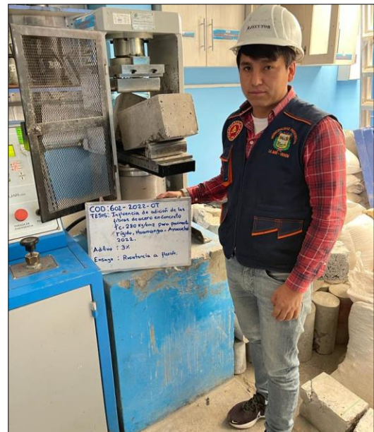
Figura N° 78: Rotura de la probeta prismática (con 3% de fibras de acero) a los tercios de la luz
