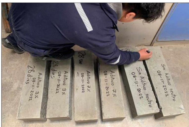
Figura N° 67: Apunte de datos y su colocación en la poza, para su curado
