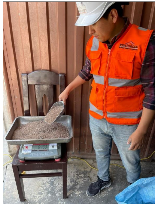
Figura N° 44: Peso del A.F según diseño de mezcla (sin fibras de acero).
