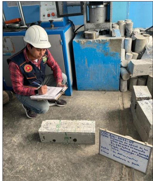
Figura N° 71: Apunte de medidas de la probeta prismática (sin fibras de acero)
