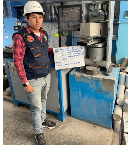
Figura N° 83: Rotura de la probeta prismática (con 5% de fibras de acero) a los tercios de la luz
