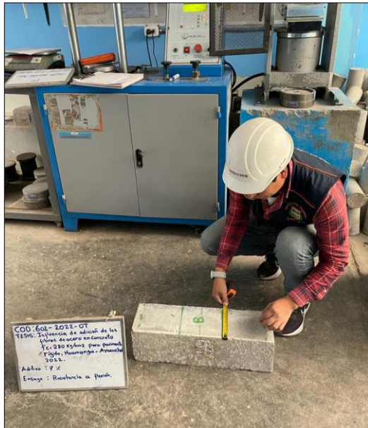
Figura N° 85: Toma de medidas de la probeta prismática (con 7% de fibras de acero)
