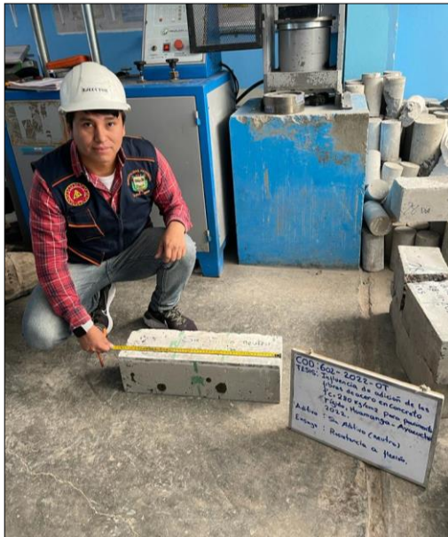
Figura N° 70: Toma de medidas de la probeta prismática (sin fibras de acero)
