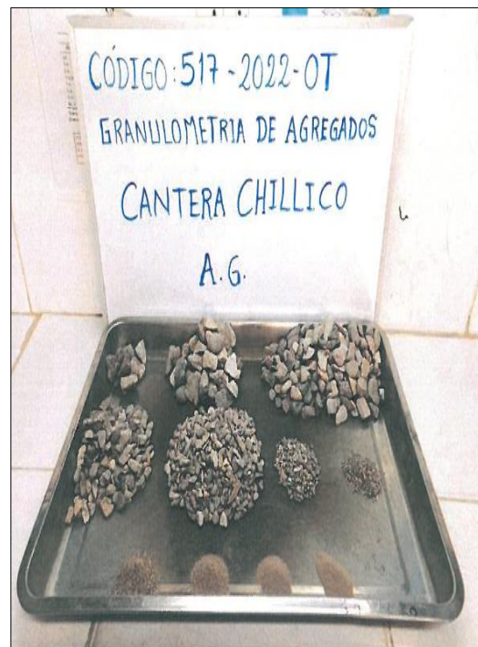
Figura 22: Resultado del tamizaje del A.G
