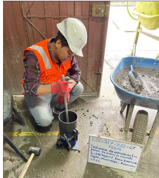
Figura N° 60: Aplicación de 25 golpes en cada capa con varilla lisa de 5/8"
