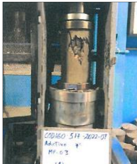
Figura N° 98: Rotura de la probeta cilíndrica con 7% de fibras de acero (con edad de 14 días)
