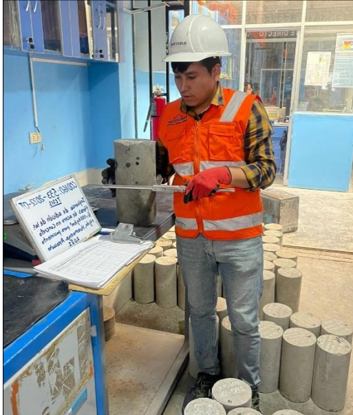
Figura N° 99: Toma de medidas de la probeta cilíndrica sin fibras de acero (con edad de 28 días)
