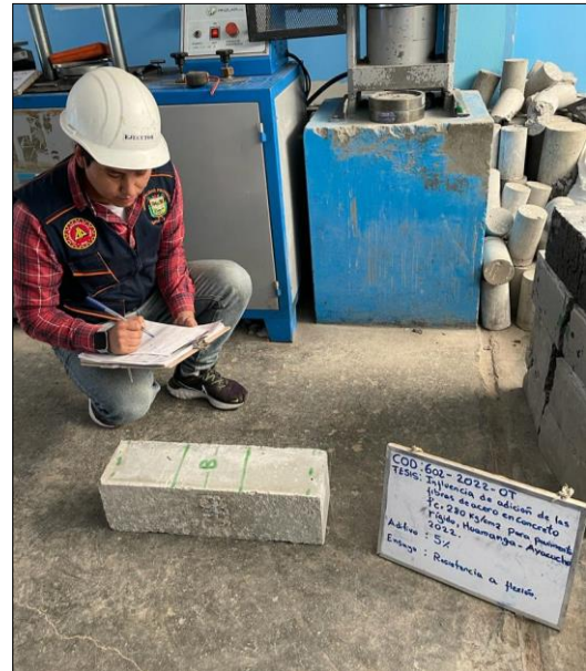
Figura N° 81: Apunte de medidas de la probeta prismática (con 5% de fibras de acero)
