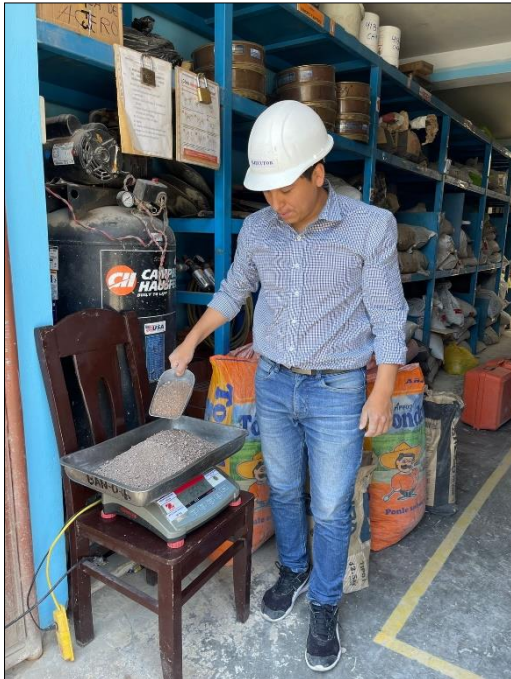
Figura N° 55: Peso del A.F según diseño de mezcla (7% de fibras de acero).
