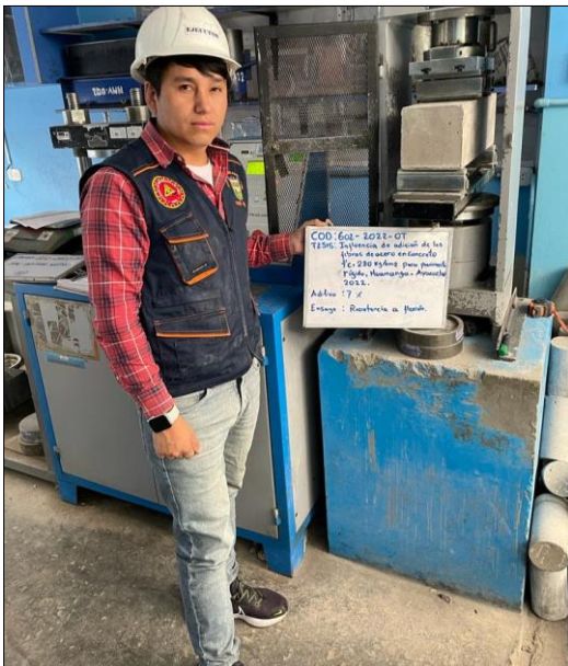
Figura N° 87: Colocación de la probeta prismática (con 7% de fibras de acero) a la máquina para el ensayo de Resistencia a la flexión
