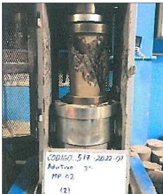
Figura N° 97: Rotura de la probeta cilíndrica con 3% de fibras de acero (con edad de 14 días)
