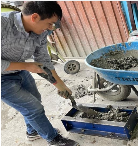
Figura N° 63: vaciado de mezcla en dos capas
