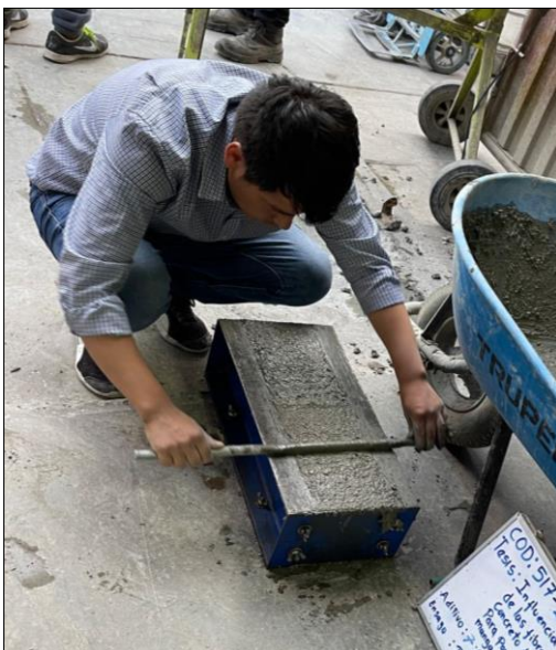
Figura N° 65: Enrasamiento de la muestra
