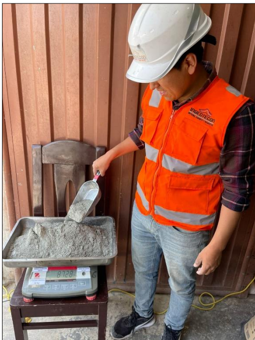
Figura N° 45: Peso del cemento según diseño de mezcla (sin fibras de acero).
