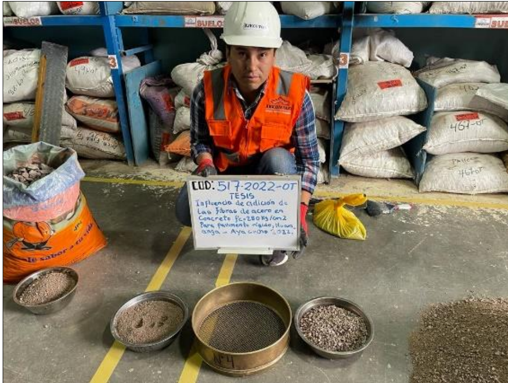
Figura 15: Determinación de material más fino que el tamiz No. 200 de A.G
