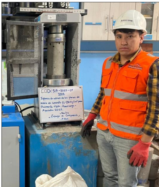
Figura N° 93: Colocación de la probeta cilíndrica (con edad de 07 días) a la máquina para el ensayo de Resistencia a la compresión
