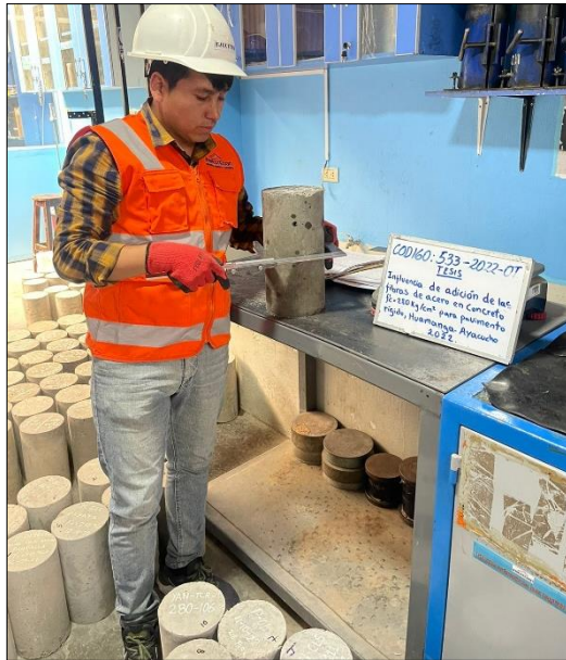
Figura N° 91: Toma de medidas de la probeta cilíndrica (con edad de 07 días)
