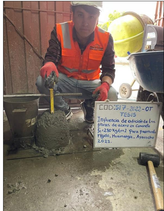
Figura N° 105: Medición del asentamiento de concreto en 4 1/2" (3% de fibras de acero).
