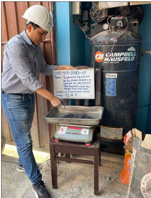
Figura N° 57: Peso del acero según diseño de mezcla (7% de fibras de acero).
