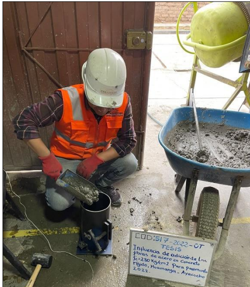
Figura N° 59: vaciado de mezcla en tres capas
