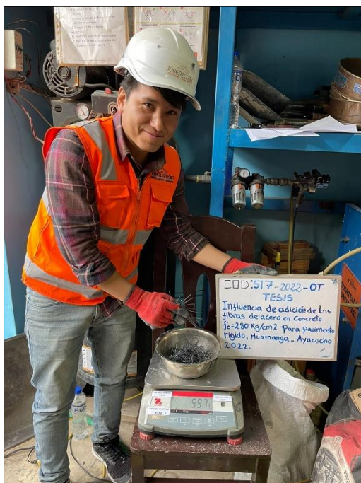
Figura N° 49: Peso del acero según diseño de mezcla (3% de fibras de acero).
