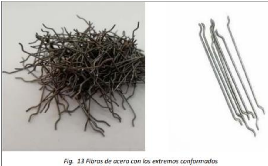
Figura N° 01:1: Fibras de acero con los extremos conformados
