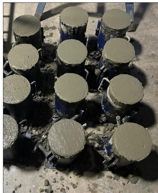
Figura N° 62: Muestra de la elaboración de las probetas cilíndricas
