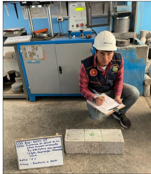
Figura N° 86: Apunte de medidas de la probeta prismática (con 7% de fibras de acero)
