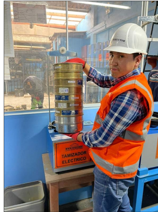
Figura 20: Colocado de tamices de A.G
