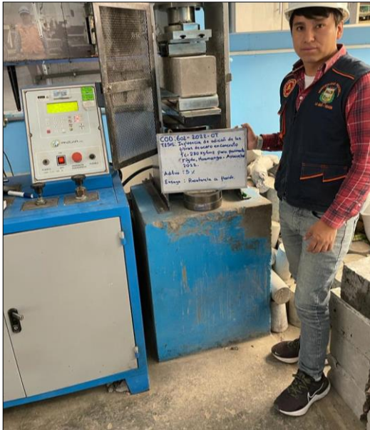
Figura N° 82: Colocación de la probeta prismática (con 5% de fibras de acero) a la máquina para el ensayo de Resistencia a la flexión
