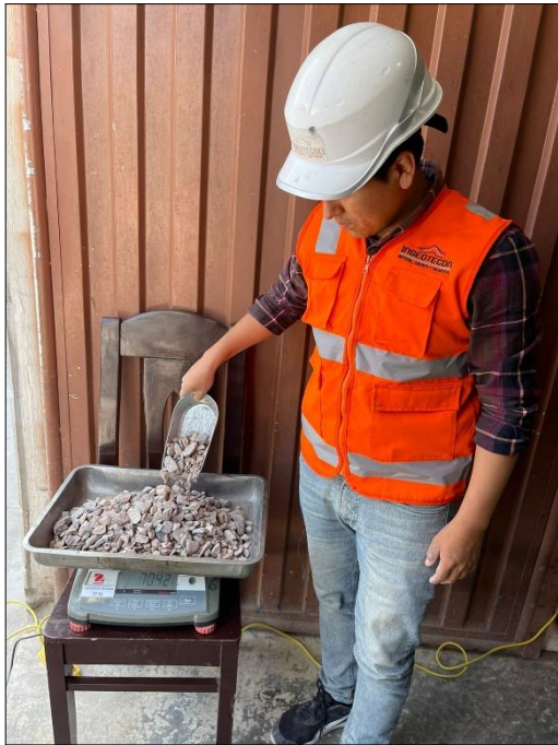
Figura N° 43: Peso del A.G según diseño de mezcla (sin fibras de acero).
