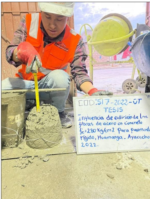
Figura N° 106: Medición del asentamiento de concreto en 4 5/8" (5% de fibras de acero).
