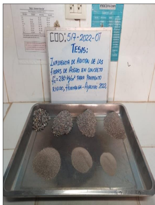
Figura 28: Resultado del tamizaje del A.F
