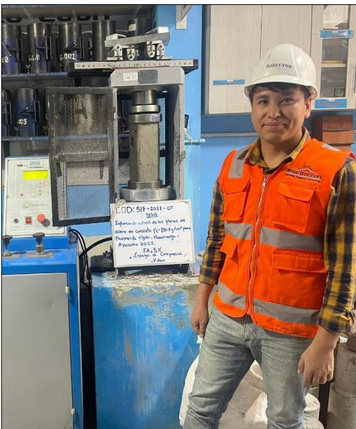
Figura N° 101: Rotura de la probeta cilíndrica con 5% de fibras de acero (con edad de 28 días)
