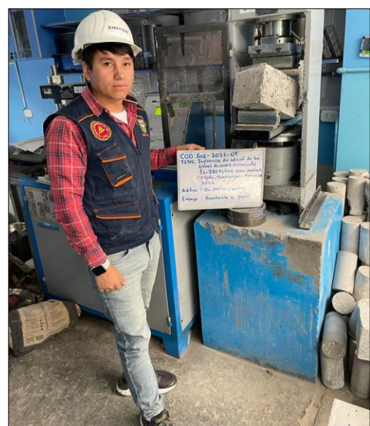
Figura N° 73: Rotura de la probeta prismática (sin fibras de acero) a los tercios de la luz
