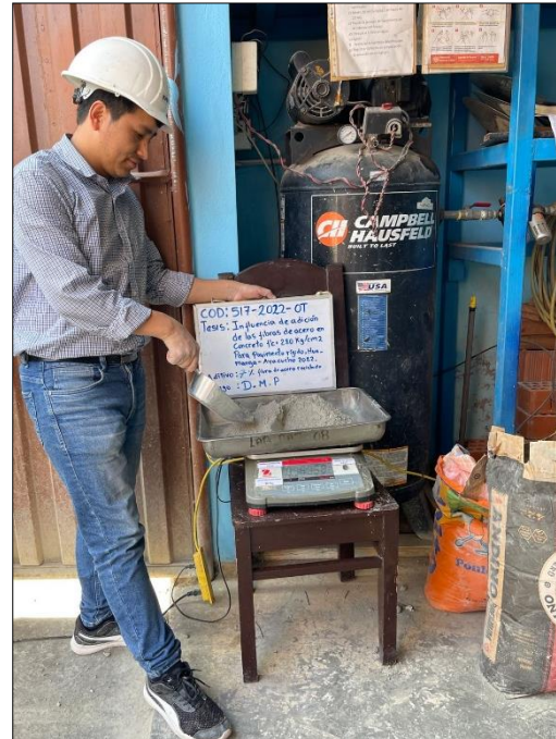
Figura N° 56: Peso del cemento según diseño de mezcla (7% de fibras de acero).
