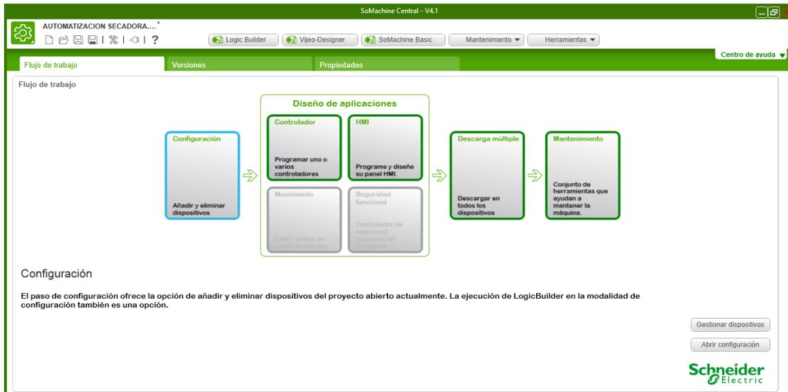
**Anexo 22: En la parte superior del programa se muestran 3 ventanas para proceder con la programación del PLC utilizamos Somachine Basic, donde podremos configurar todo lo concerniente al PLC, sus entradas y salidas tanto digitales como analógicas.**
