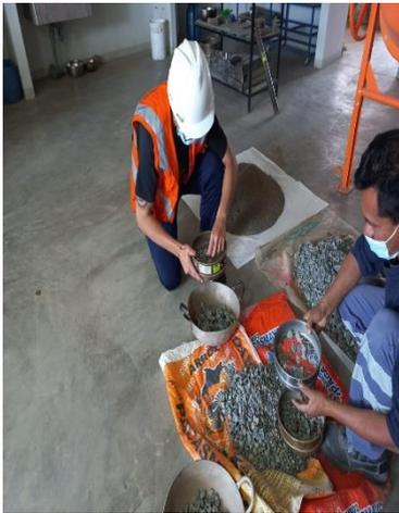
Figura 9. Tamizaje de agregados
