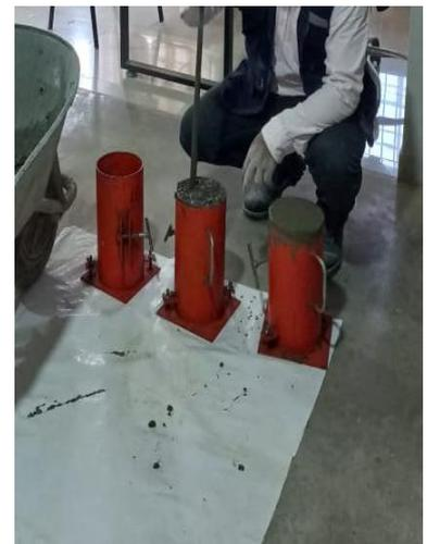
Figura 19. Probetas
