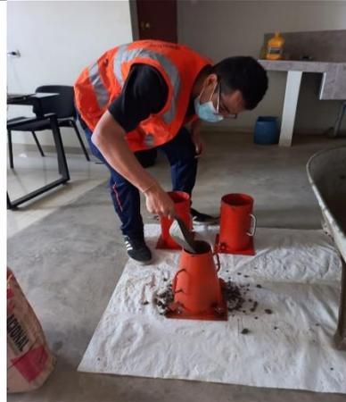
Figura 8. Llenado probeta para el SLUMP
