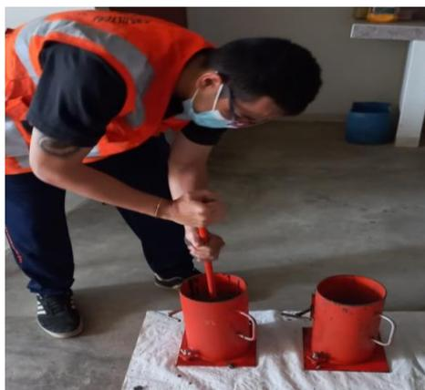
Figura 16: Chuseada probeta
