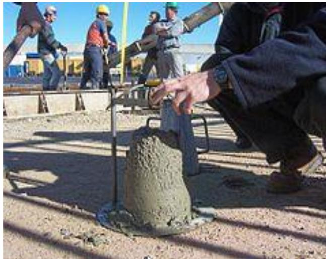
*Figura 6.* Medición de la trabajabilidad del concreto mediante el cono de Abrams.
