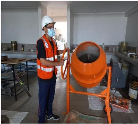
Figura 3. Mezclado con la ayuda de la mezcladora eléctrica
