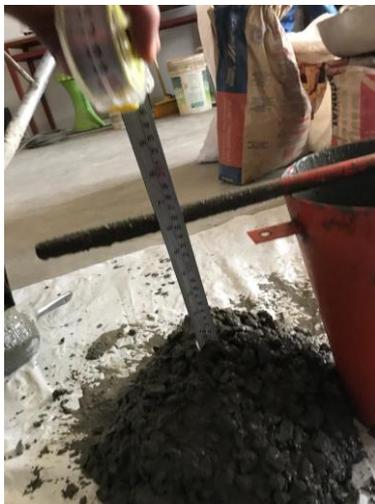
Figura 20. Medición del Asentamiento
