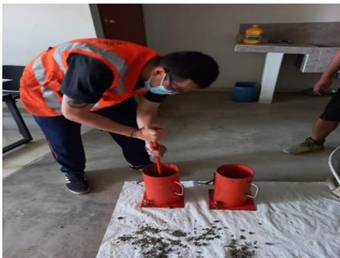
Figura 5. Chuseada al molde de la probeta
