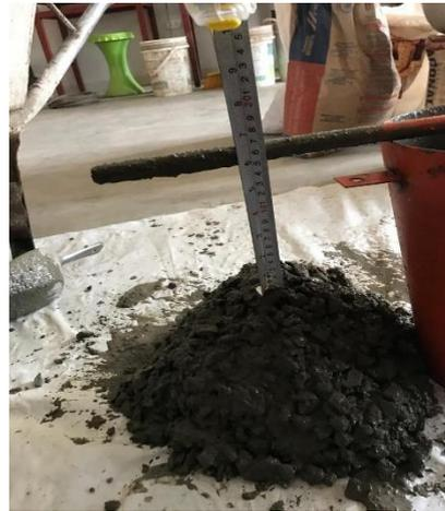
Figura 10. Medición del asentamiento
