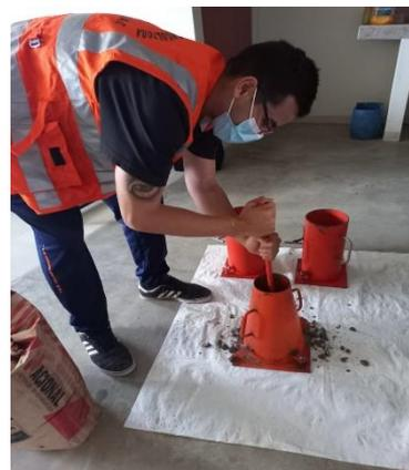
Figura 12. Chuseado Uniforme Slump
