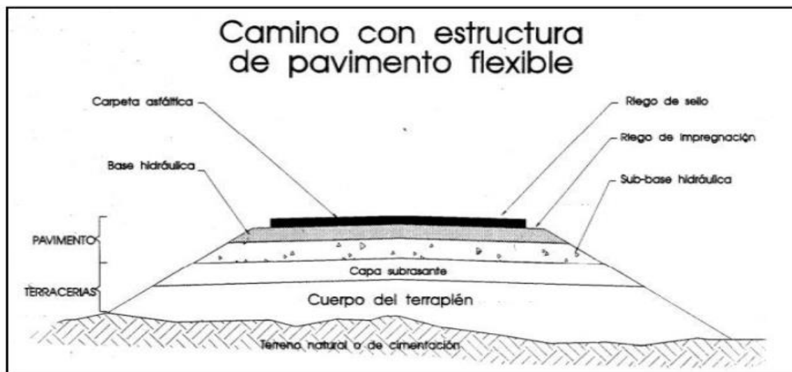
Figura 2. Partes del pavimento flexible
