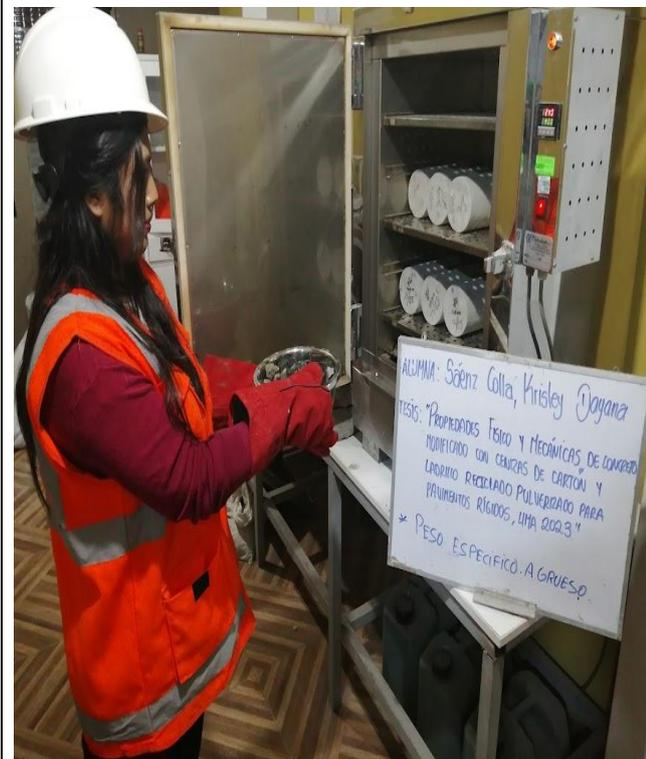
Fotografía 3. Agregado grueso en el horno
