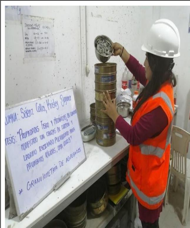
Fotografía 1. Tamizado de los Agregados
