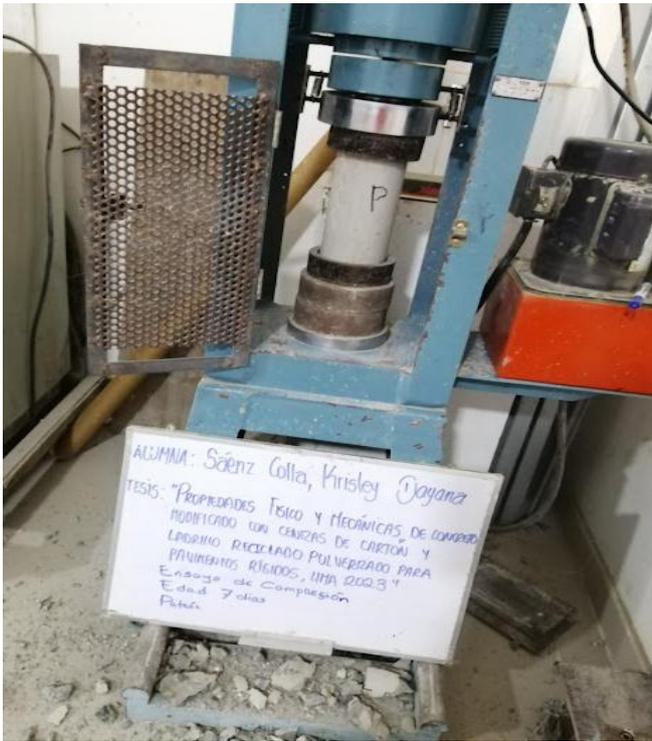
Fotografía 5. Ensayo de compresión 7 días
