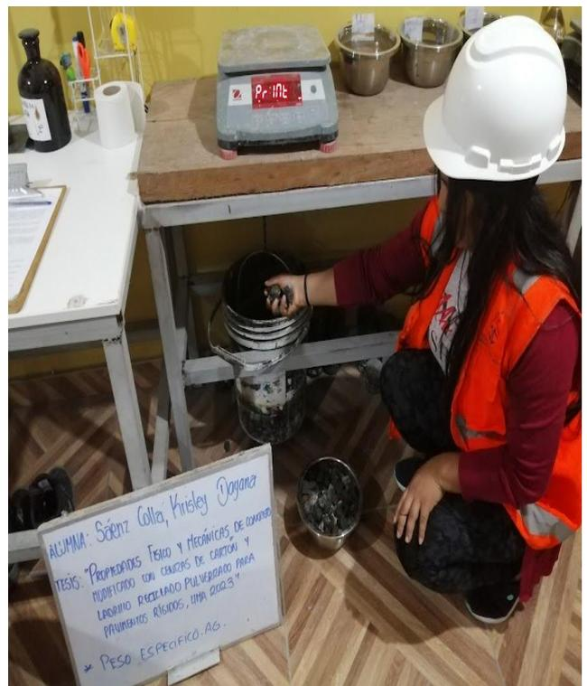
Fotografía 4. Peso específico del AG.
