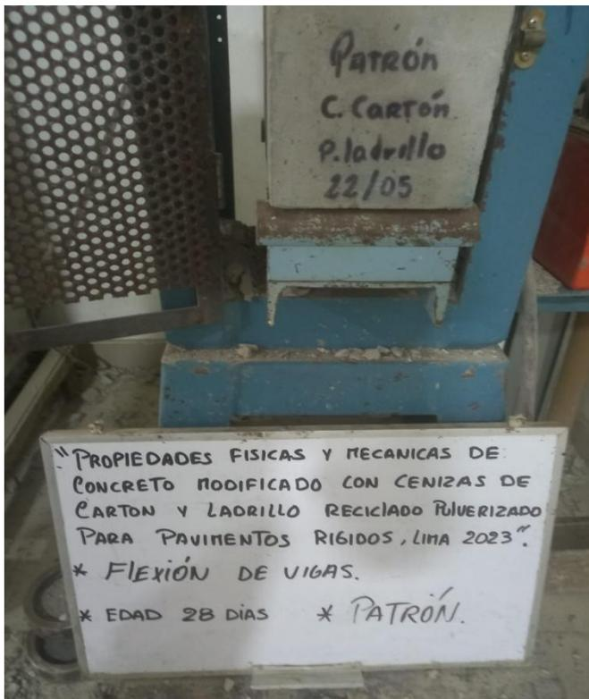
Fotografía 7. Ensayo de flexión
