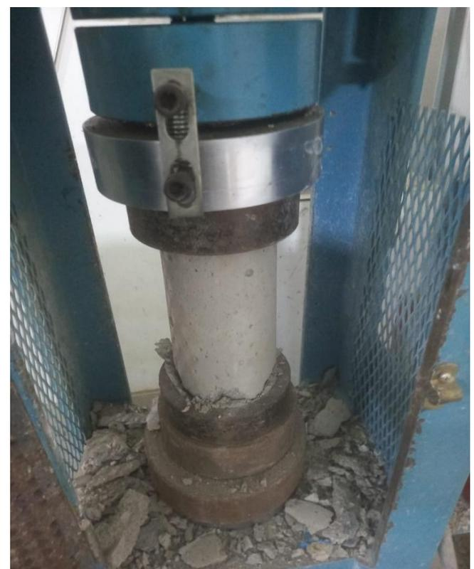
Fotografía 8. Ensayo de compresión 28 días
