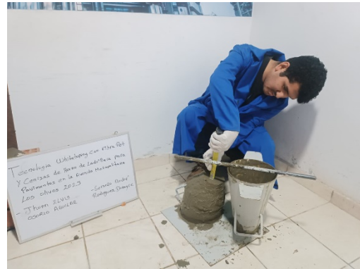
Figura 26. Asentamiento de cono de Abrams
