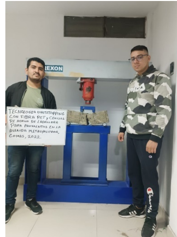
Figura 22. Rotura de viga con adición de ceniza a los 28 días FC - 2.9
