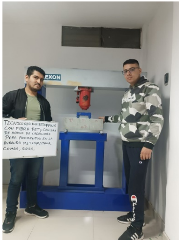
Figura 21. Rotura de viga con adición de pet a los 28 días F-2
