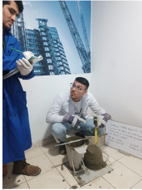
Figura 25. Asentamiento de cono de Abrams
