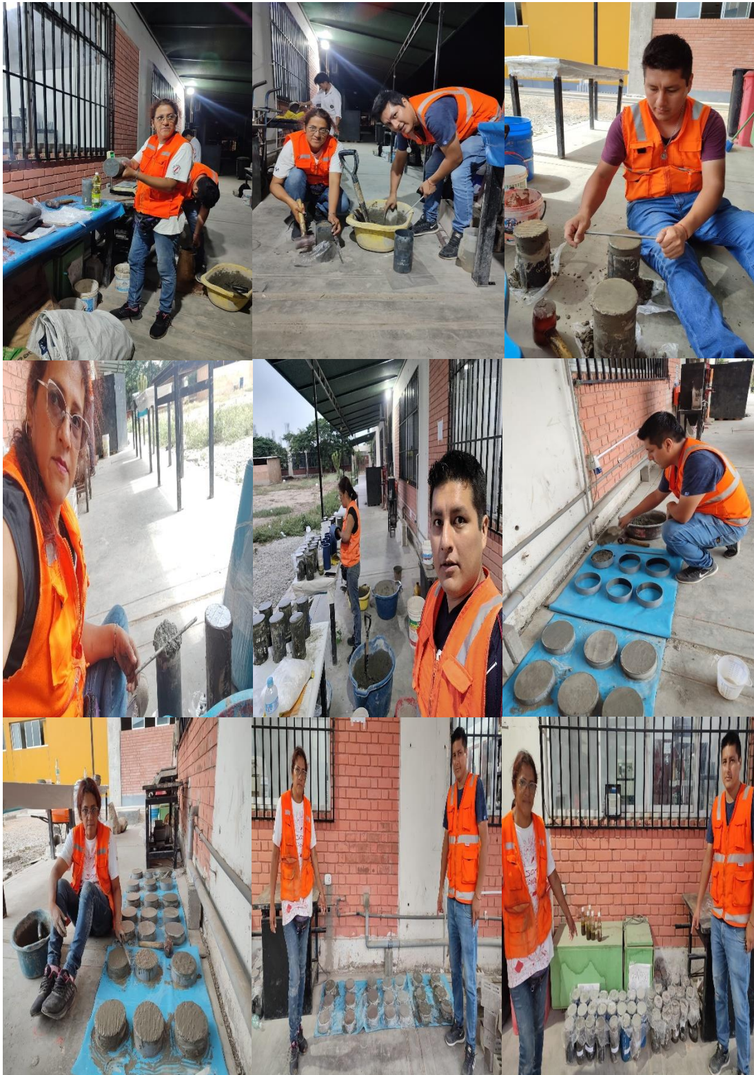
Figura 24 Conformación de probetas
