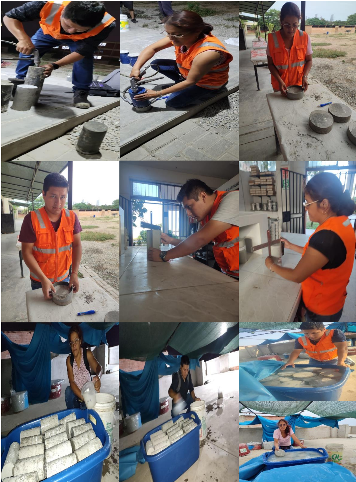
Figura 25 Desmoldaje, control de calidad y curado de probetas
