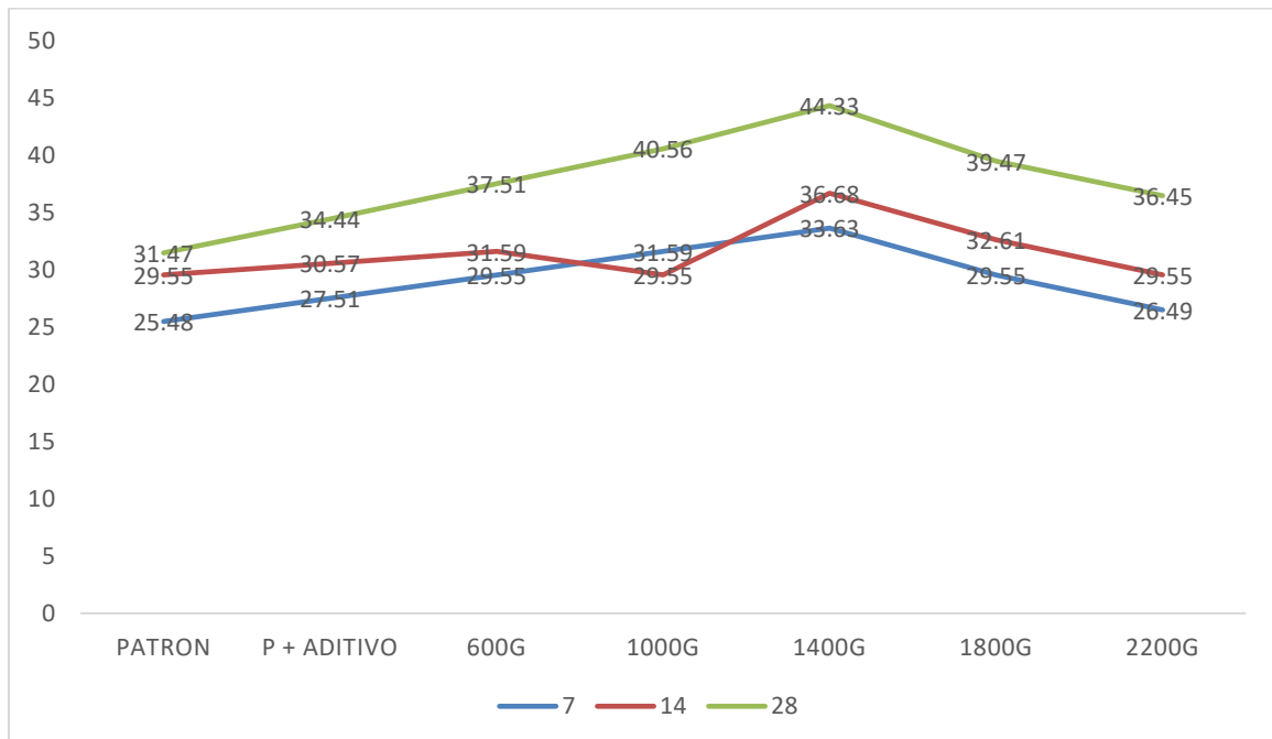
Figura 16 Curva del Ensayo de Resistencia a la Tracción a 7, 14 y 28 días
