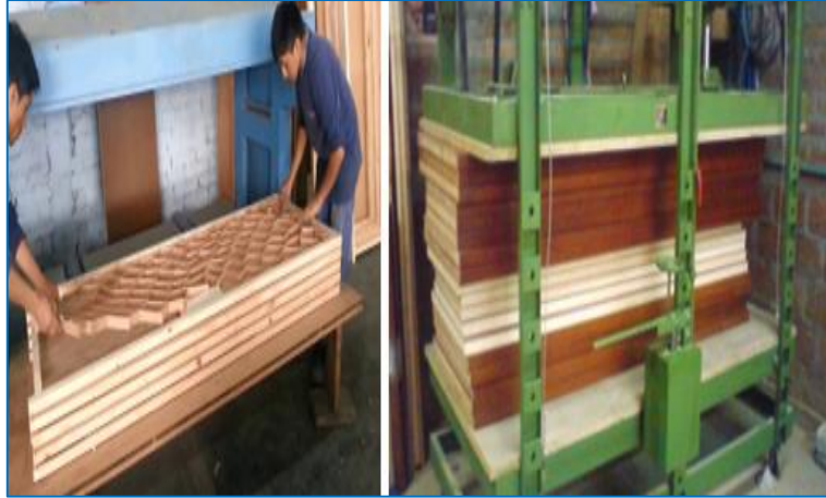
Figura 14. Área de armado y prensado
