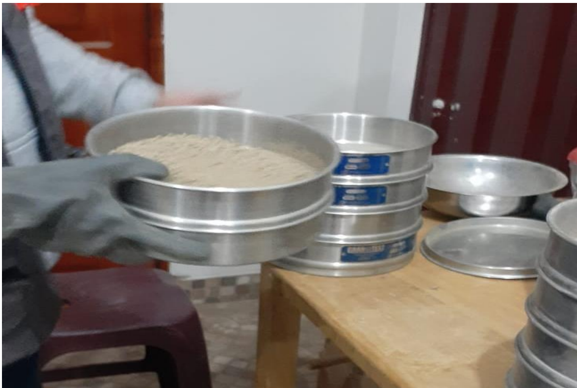
Fotografía 30: Se aprecia al jefe de laboratorio que esta realizando la zarandeada con la finalidad de hacer pasar las partículas al plato.
