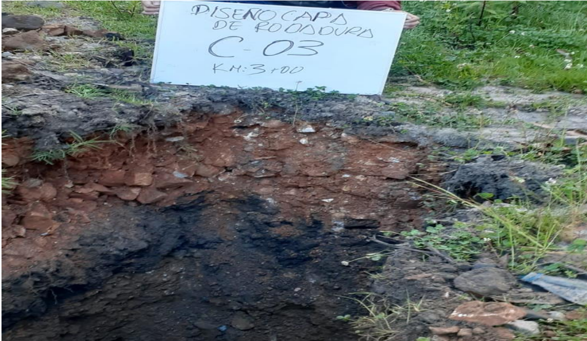
fotografía 25: se aprecia la excavación de la calicata 3 a una profundidad de 1.55m
