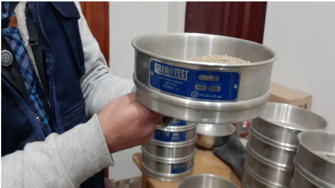
Fotografía 32: se aprecia tamiz y plato o fondo
