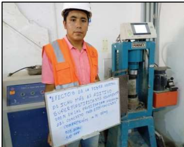
Figura 26. Ensayo a la compresión del concreto Fuente: Propia
