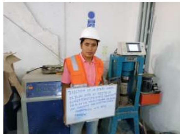
Fotografía 16. Ensayo de resistencia a compresión
