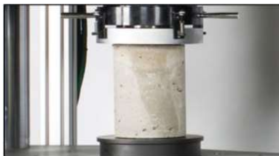
Figura 10. Prueba de esfuerzo a compresión Fuente: https://cutt.ly/E46dfY4
