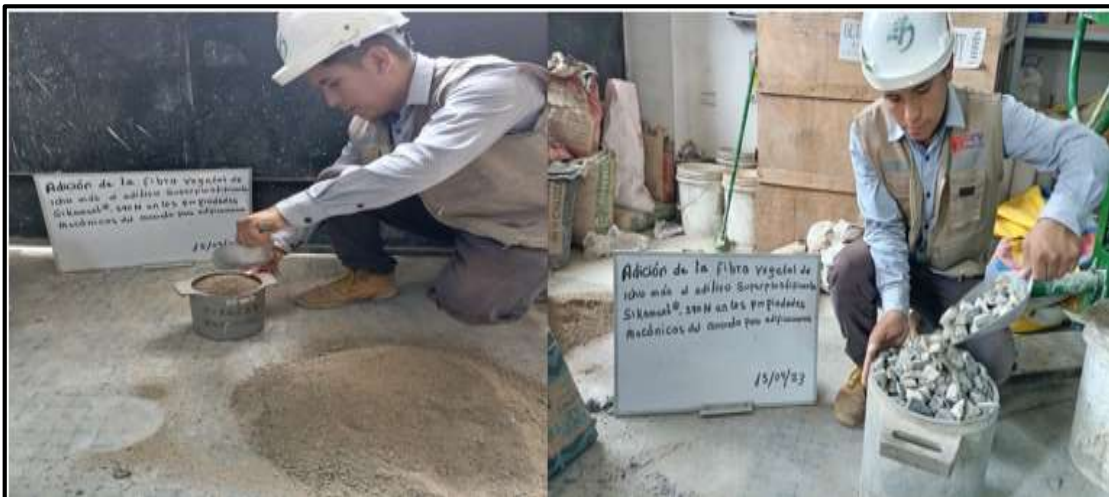
Figura 22. Ensayo del peso unitario suelto de los agregados. Fuente: Propia
