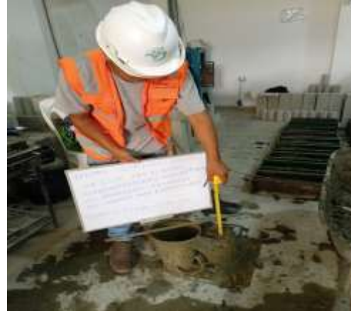
Fotografía 14. Asentamiento del concreto
