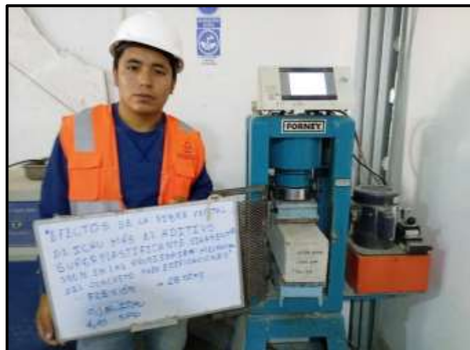
Figura 28. Ensayo de flexión con vigas de concreto Fuente: Propia
