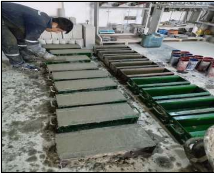
Figura 25. Vaciado y curado de vigas y probetas de concreto Fuente: Propia
