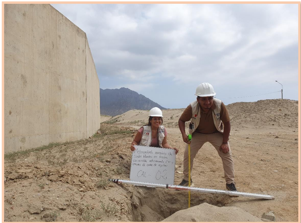
Realización de Calicatas en inicio del tramo
