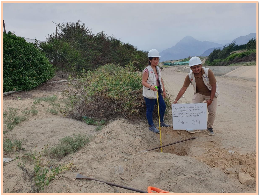
Realización de Calicatas en el km 17+500
