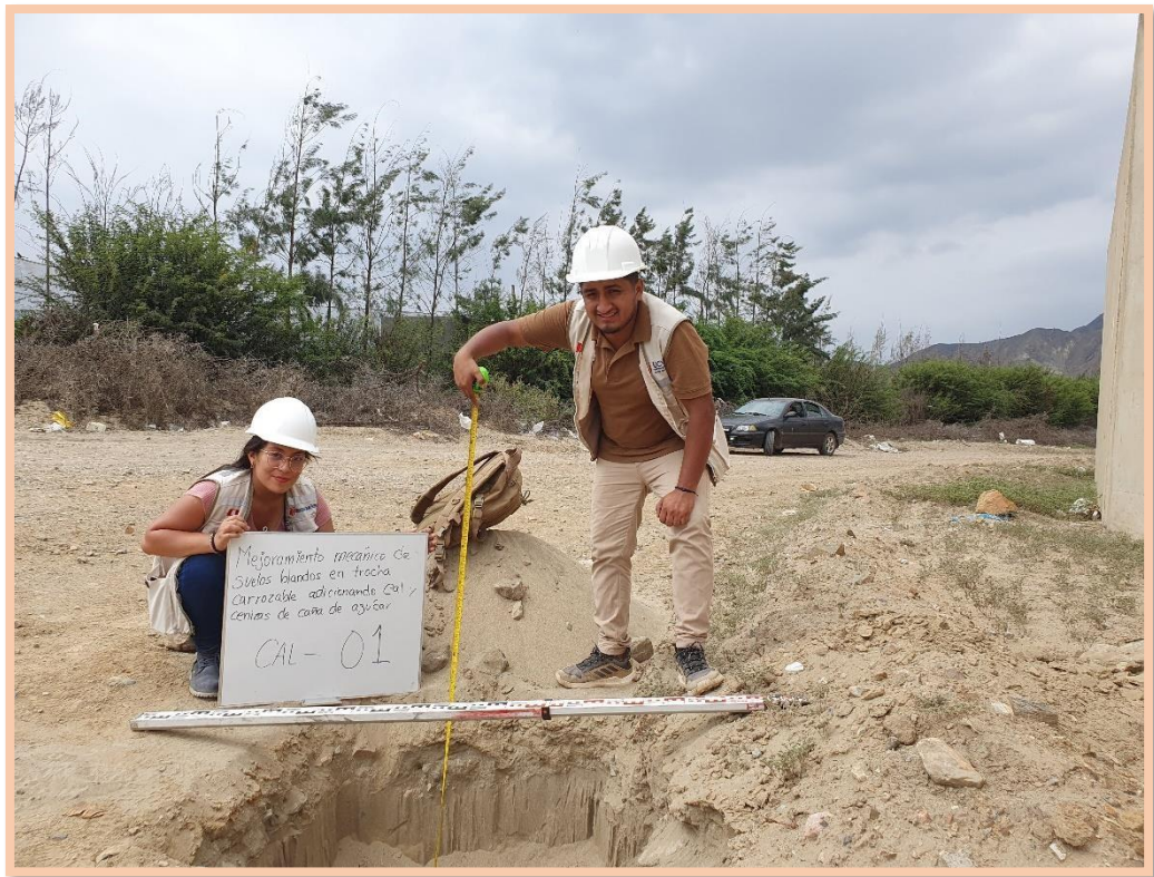
Realización de Calicatas en inicio del tramo
