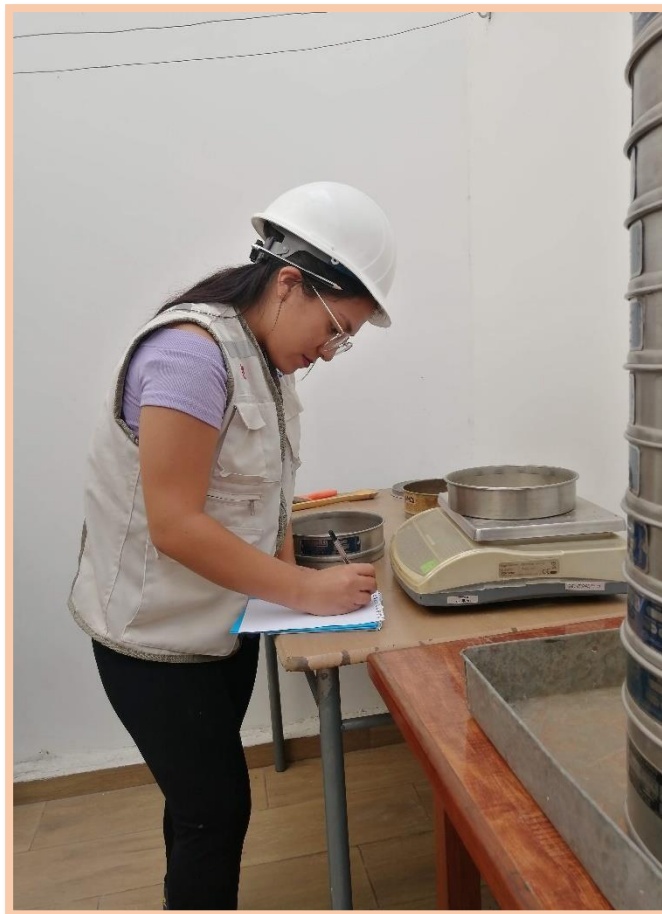
Se hace las respectivas anotaciones para los cálculos del estudio de granulometría
