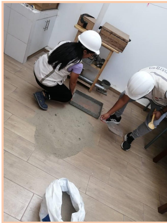
Se empezó realizando el cuarteo a una parte de la muestra obtenida
