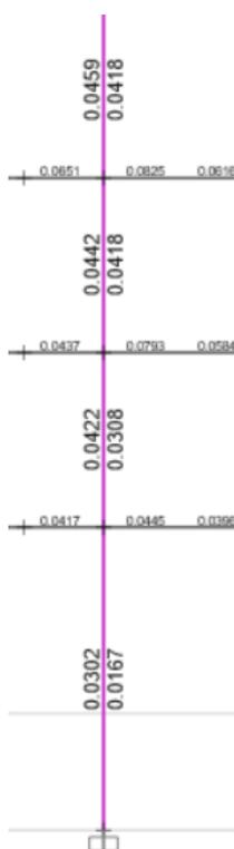
Figura 16. Áreas de refuerzo por corte establecido por ETABS 21.
