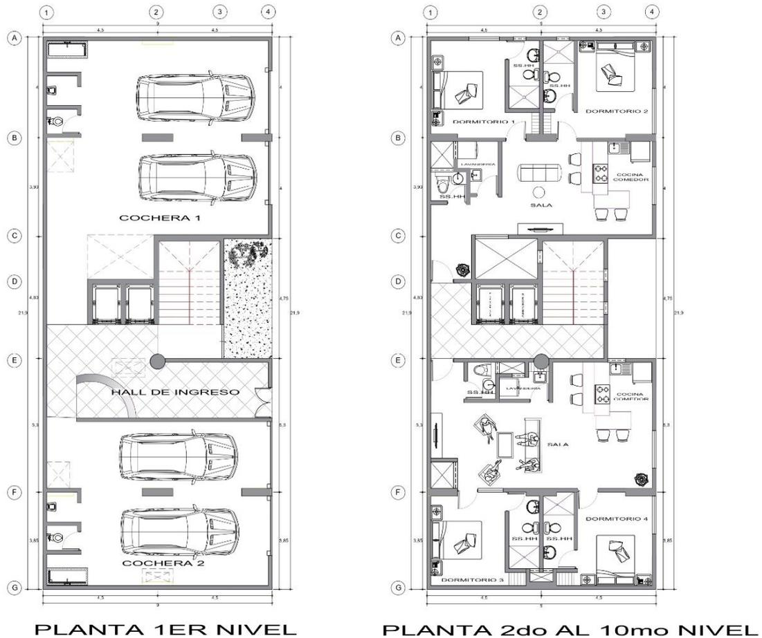
Figura 5. Distribución del Diseño Arquitectónico propuesto.
