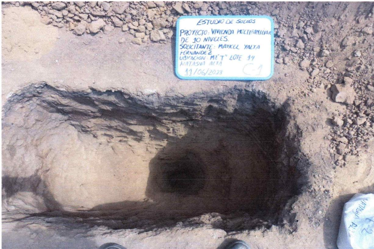
Calicata N° 01: Excavación y extracción de muestras de calicata, para ser trasladadas y analizadas en laboratorio, con una profundidad 3.00 metros.
