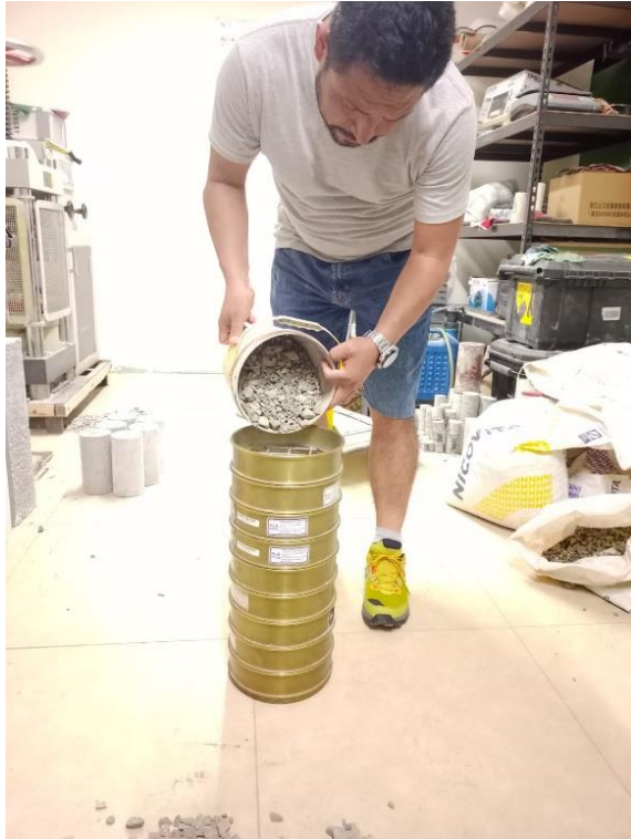
Figura 18: Granulometría del agregado grueso.
