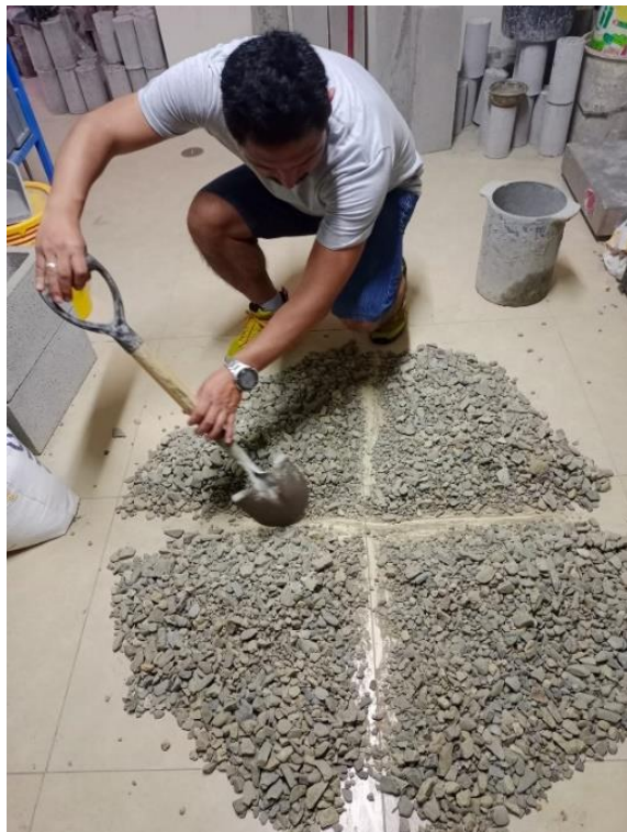
Figura 15: Cuarteo del agregado grueso.
