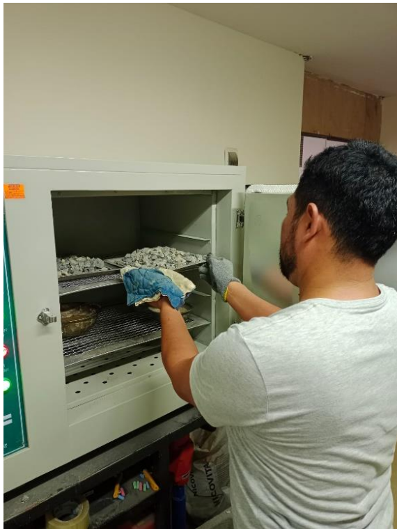
Figura 17: Contenido de humedad del agregado grueso.
