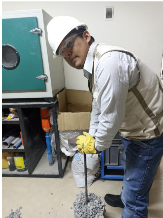
Figura 13. Compactación con la varilla para el agregado grueso.
