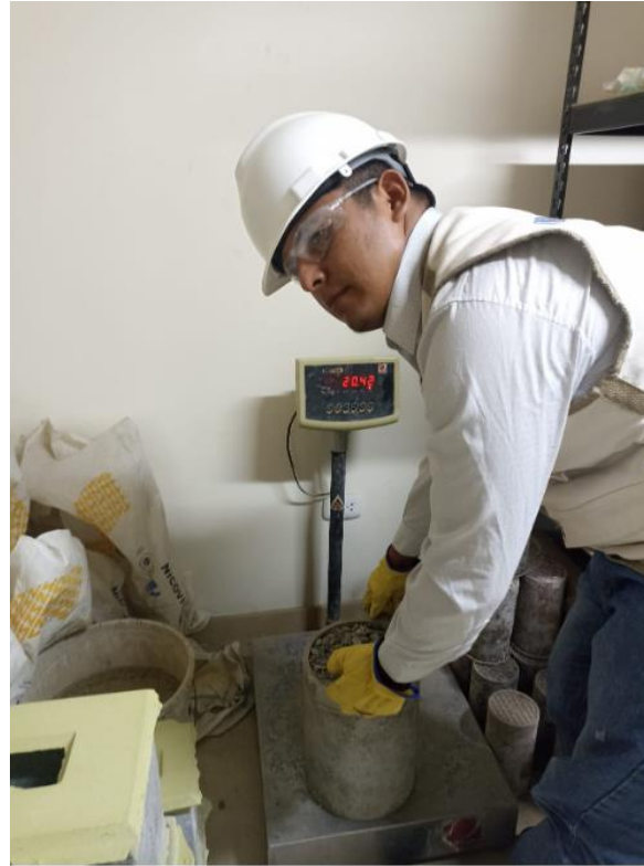
Figura 14. Peso del agregado grueso utilizado.
