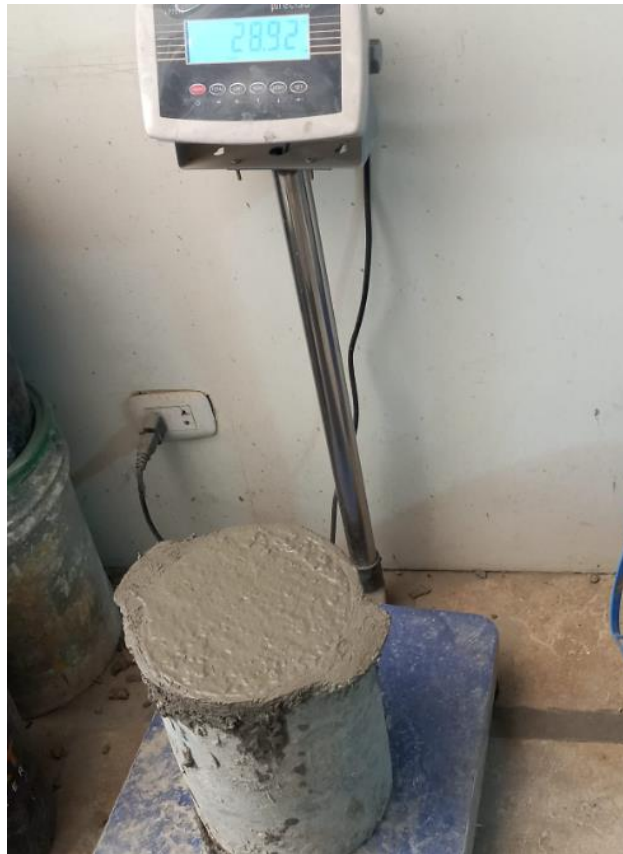
Figura 17. Vaciado de mezcla en probeta para verificación.
