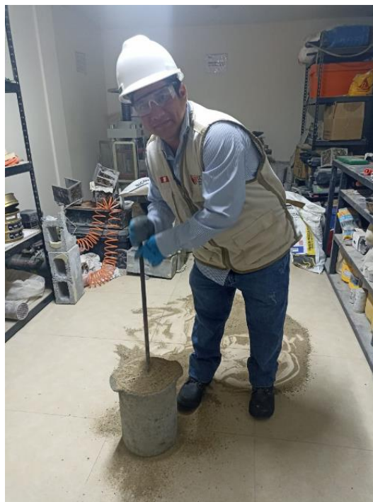
Figura 7. Compactación con la varilla para el agregado fino.
