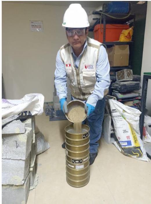
Figura 9. Realización del tamizado para el agregado fino.
