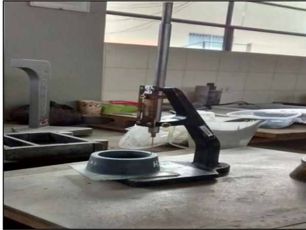
*Figura 26.* Ensayo de Tiempo de Fraguado con la aguja Vicat
