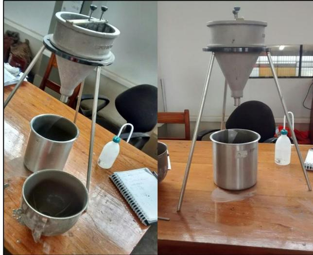
*Figura 25. Ensayo de Fluidez con el Cono Marsh*
