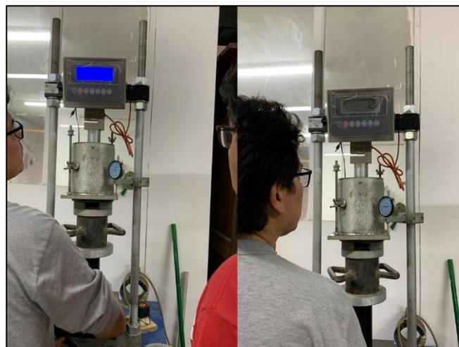
*Figura 21.* La muestra se penetra con un pistón
