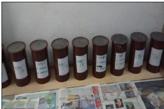
*Figura 27.* Probetas con lechada de cemento
