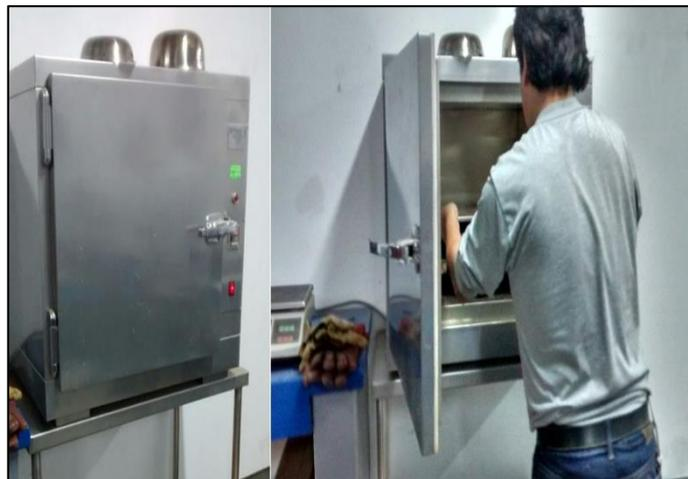
*Figura 17.* La muestra de suelo es secada en horno en el laboratorio
