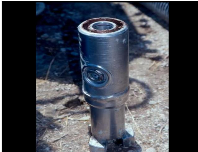
*Figura 10.* Monitor para Jet Grouting
