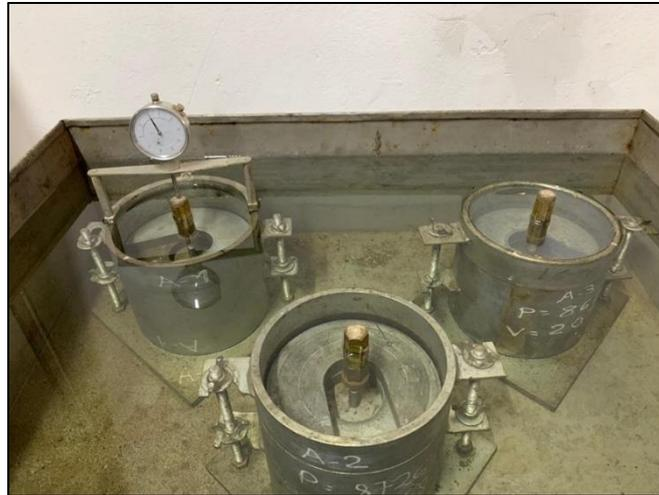
*Figura 20.* La muestra se sumerge durante 4 días según norma
