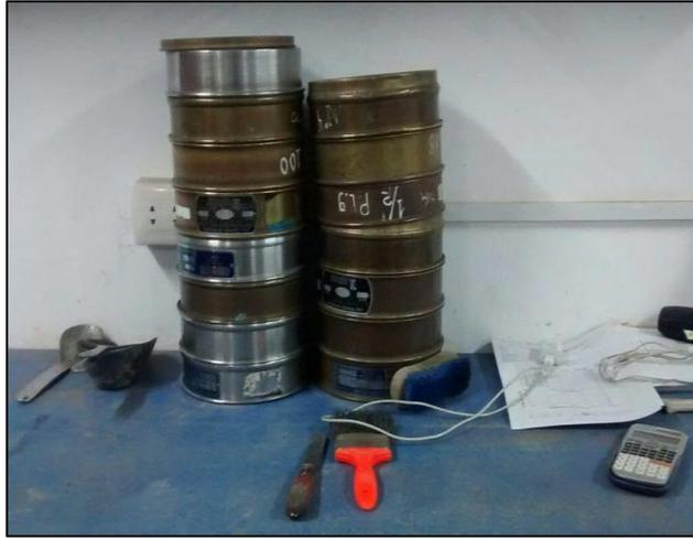
*Figura 18.* Los tamices a utilizar en el ensayo de granulometría
