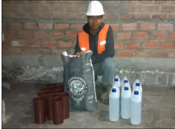
*Figura 22.* Materiales a usar para la lechada de cemento
