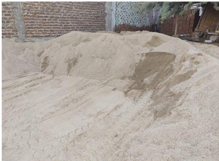
**Figura 6.** Agregado fino obtenido de la cantera “Sojo”
