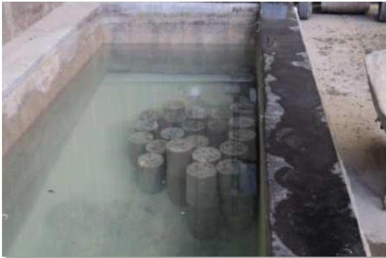
**Figura 11.** Probetas en estado de "curación"
