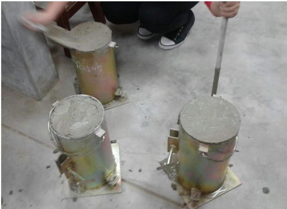
**Figura 10.** Moldes de probetas de concreto
