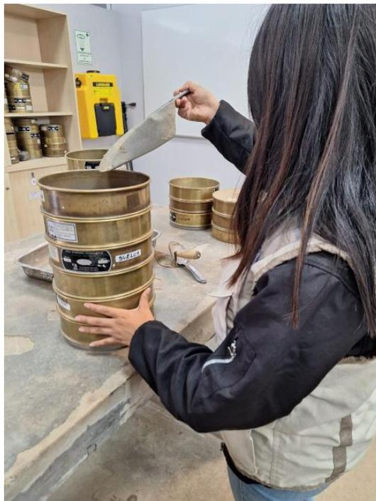
**Figura 8.** Tamizado de agregados
