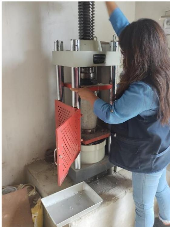
**Figura 12.** Rotura de probetas
