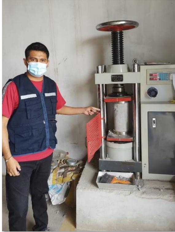
**Figura 13.** Rotura de probetas
