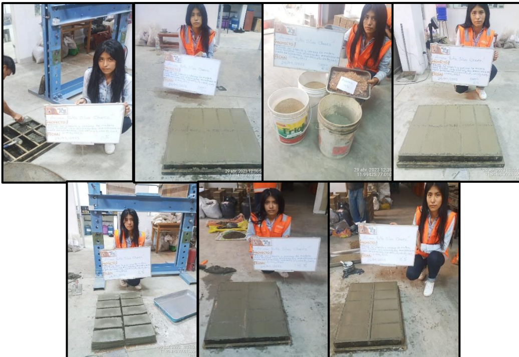
Elaboración del adoquín convencional, aserrín y cenizas de madera tornillo
