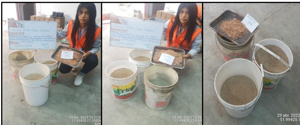
Materiales para la elaboración de adoquines con aserrín de madera tornillo (2%,4% y 6%)
