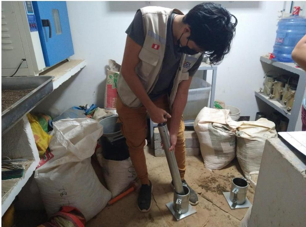
*Fotografía 19.* Proceso de Ensayo Proctor Modificado, compactación de la muestra a 25 golpes por capa.
