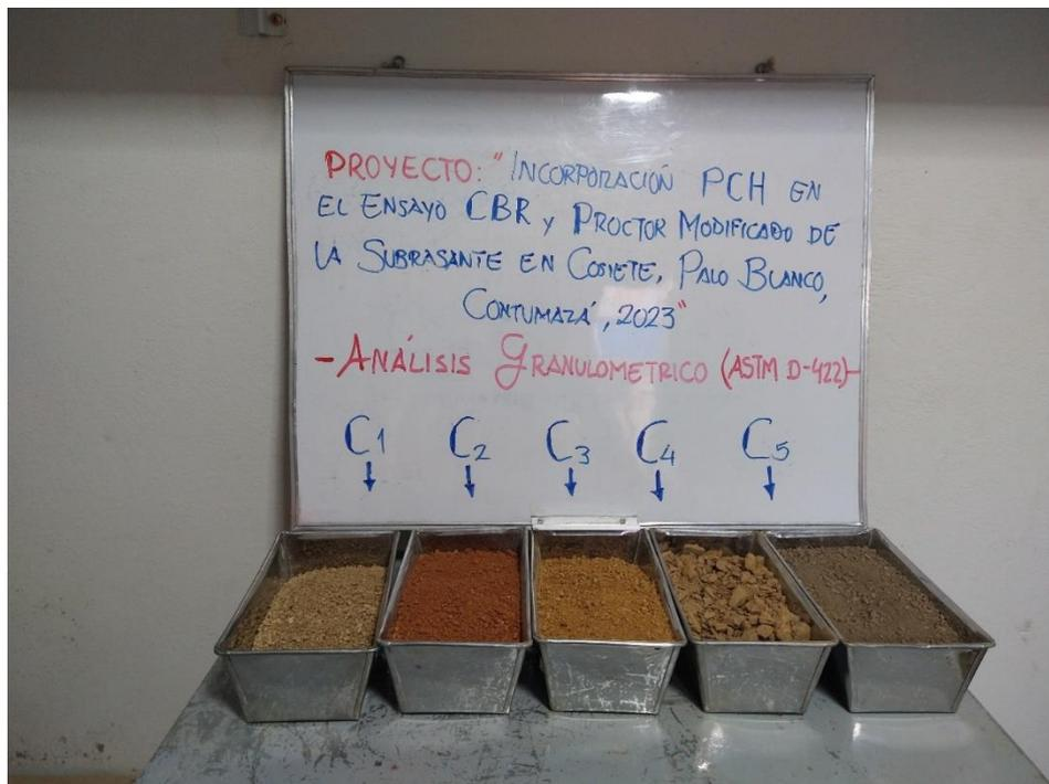
Fotografía 9. Preparación de calicatas para el Análisis Granulométrico en laboratorio "CRISAL Ingeniería y Arquitectura".
