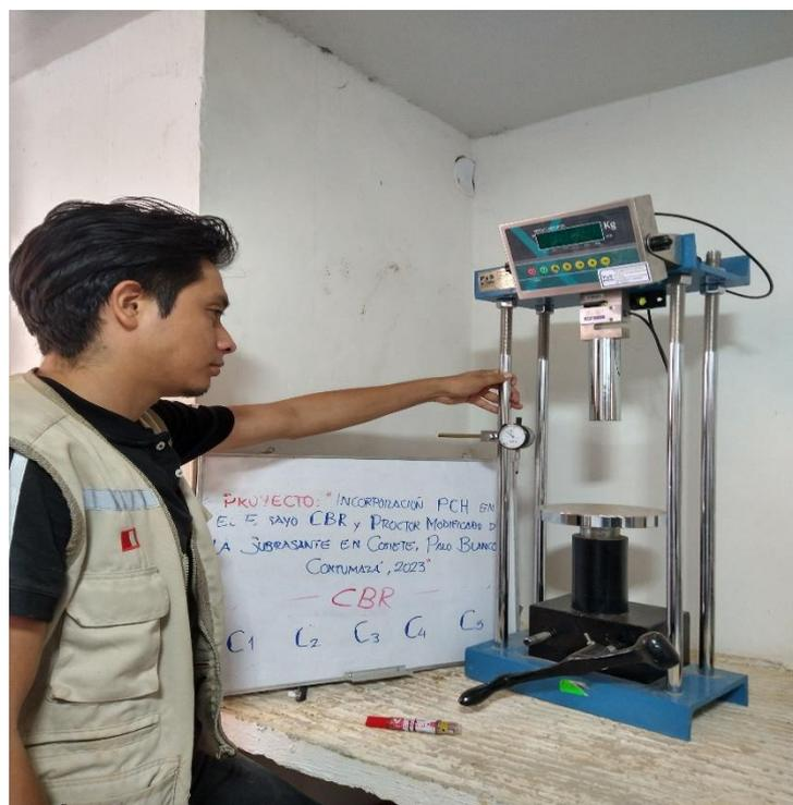
Fotografía 25. Proceso final en el Equipo de Ensayo CBR luego de 96hrs sumergidos en agua para determinar expansión y resistencia a la penetración, toma de datos y cálculos respectivos. Procesos similares en las demás calicatas y muestras (0%, 15%, 17% y 20%).
