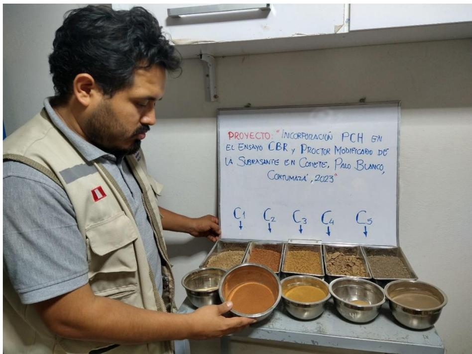
Fotografía 13. Selección de calicata para ensayo de Límites Consistencia.
