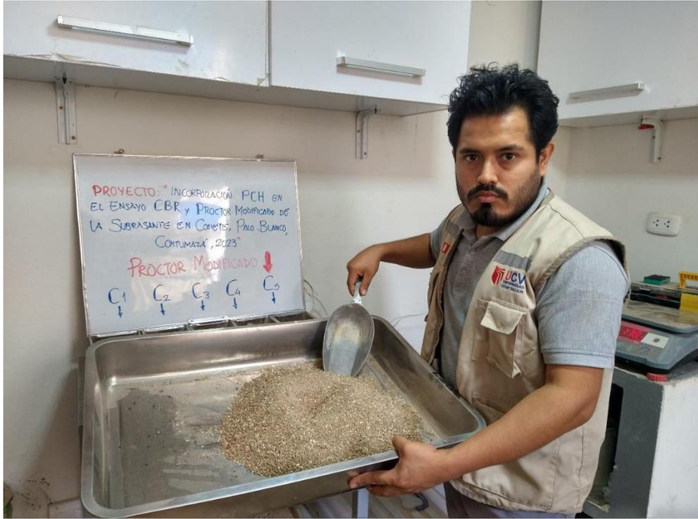
Fotografía 16. Proceso de Ensayo de Proctor Modificado con la incorporación de PCH en su respectivo porcentaje, similitud de desarrollo en las calicatas anteriores.
