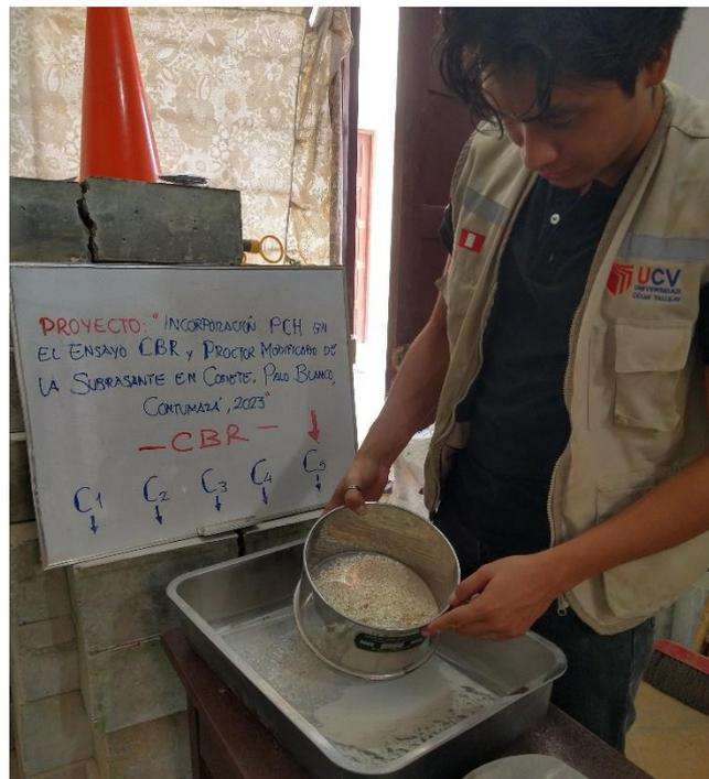
Fotografía 7. Con el tamiz N°200 se procedió a obtener el polvo de cascara de huevo y liberar de impuras para su óptimo uso.
