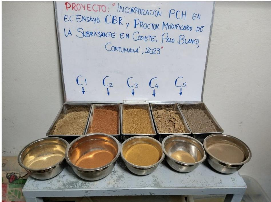
Fotografía 12. Obtención de finos en las respectivas calicatas para ensayos de Límites de Consistencia (LL, LP, IP).
