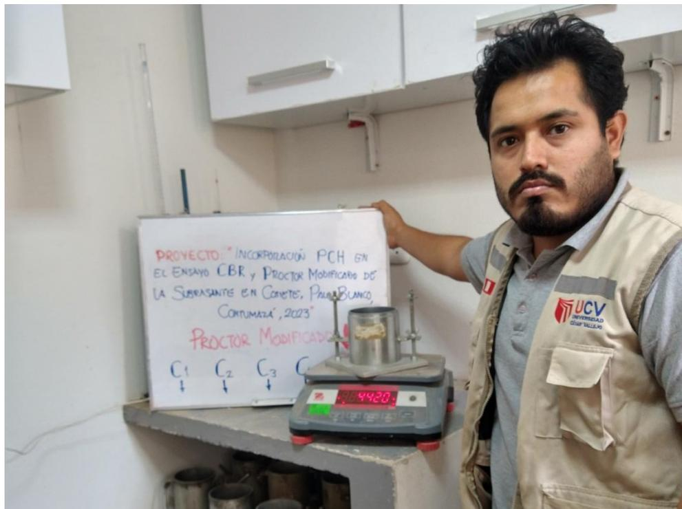
Fotografía 17. Proceso de Ensayo Proctor Modificado, recolectando datos de molde 4".
