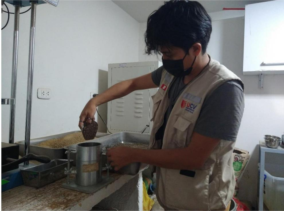
*Fotografía 18.* Procedimiento de Ensayo Proctor Modificado, llenado de la muestra por capas en el molde de 4".
