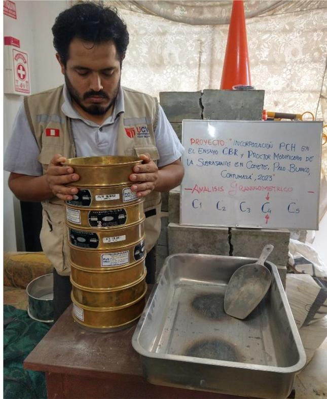
Fotografía 8. Preparando los materiales y equipos para el ensayo de Análisis Granulométrico en cada calicata.
