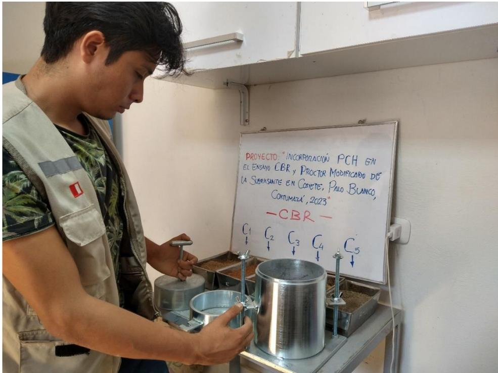
Fotografía 23. Preparación de equipos y materiales para el Ensayo CBR (California Bearing Ratio).
