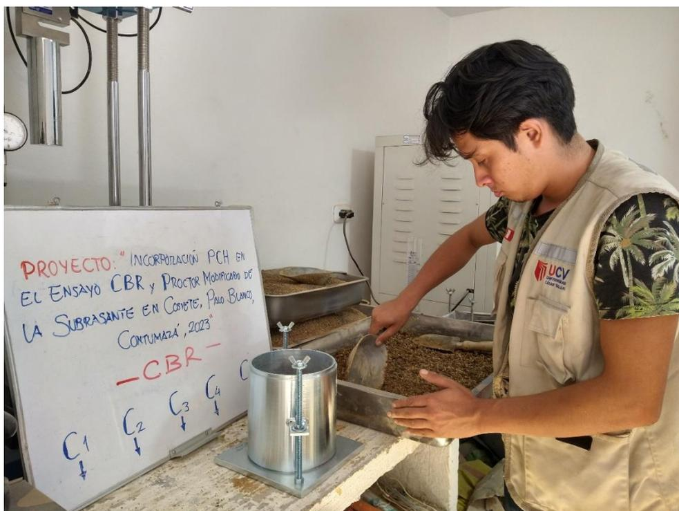
Fotografía 24. Procedimiento del Ensayo CBR con cada muestra de las calicatas respectivas.
