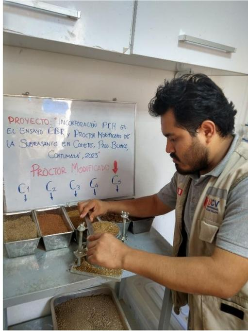
Fotografía 22. Proceso de Ensayo Proctor Modificado, rasado de la muestra en collarín para su respectivo peso.
