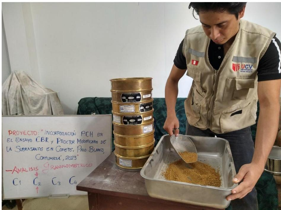
Fotografía 11. Proceso de Ensayo de Granulometría en la C-2 y demás calicatas.
