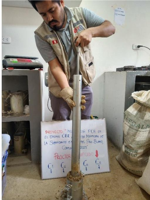
Fotografía 20. Similitud de procedimiento de Ensayo Proctor Modificado trabajos realizados en las respectivas calicatas (0%, 15%, 17% y 20%).
