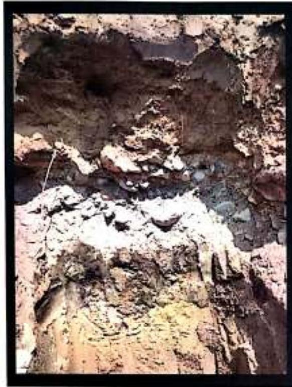
Calicata N° 01: Excavación de calicata, con una profundidad mínima 3.00 metros. Extracción de muestras para ser trasladadas y analizadas en laboratorio.
