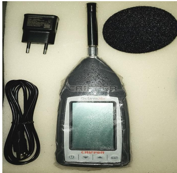
Figura 4. Sonómetro integrador tipo 1
