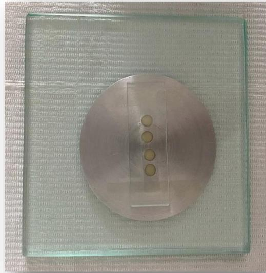
Con la lampara LED fotocuramos el disco de resina compuesta por 60 segundos.
