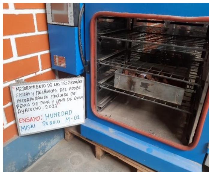
Figura 14. Ensayo de contenido de humedad.
