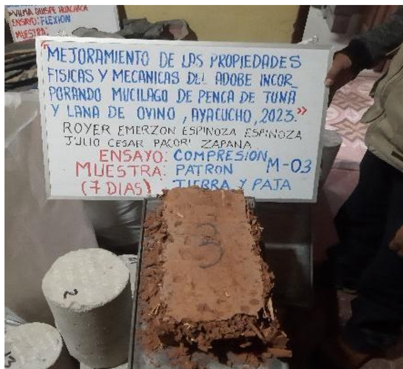
Figura 2.: Ensayo de compresión adobe hecho de tierra y paja
