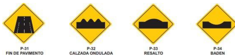
FIGURA N° 08: Señales preventivas debido a la superficie de rodadura
