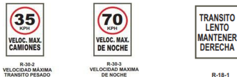
FIGURA N° 04: Señales de restricción (R – 30 – 2, R – 30 – 3 y R – 18 – 1).
