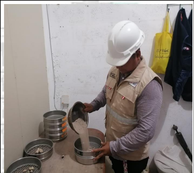
Fotos N° 01-02: En las imágenes se puede visualizar al personal técnico realizando el ensayo de análisis granulométrico.
