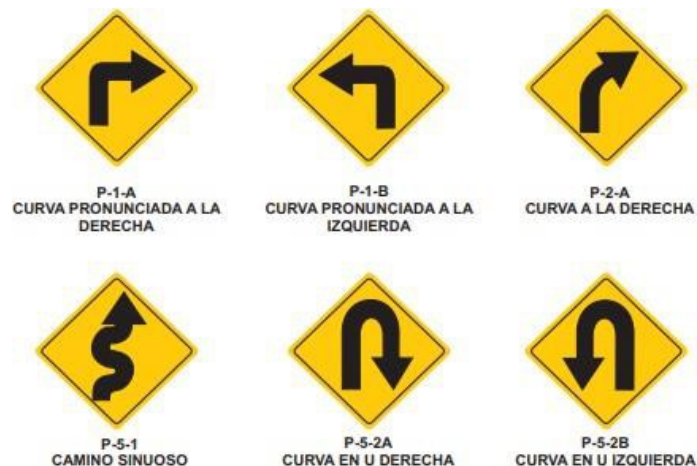
FIGURA N° 06: Señales de curvas horizontales
