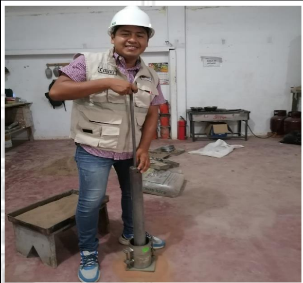
Fotos N° 05-06: En las imágenes podemos observar al personal realizando el ensayo de compactación (Proctor Estándar)
