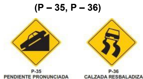
FIGURA N° 07: Señales preventivas por pendientes longitudinales.
