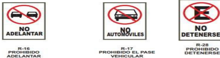
FIGURA N° 03: Señales de prohibición (R – 16, R – 17, R – 28).
