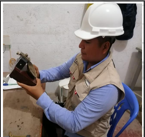
Fotos N° 07-08: En las imágenes podemos apreciar a nuestro personal realizando el ensayo de Límites de Atterberg.
