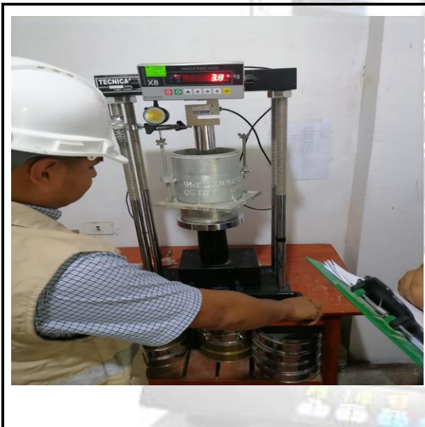
Fotos N° 11-12: En las imágenes podemos observar al personal técnico realizando el ensayo de C.B.R.
