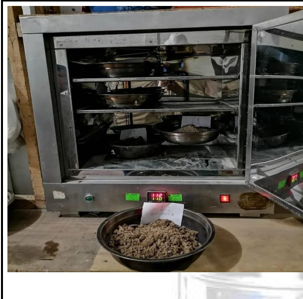
Fotos N° 09-10: En las imágenes podemos observar al personal técnico realizando el ensayo de contenido de humedad.
