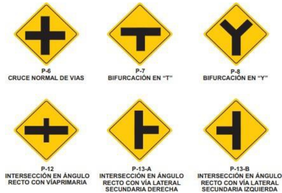
FIGURA N° 09: Señales preventivas debido a intersecciones
