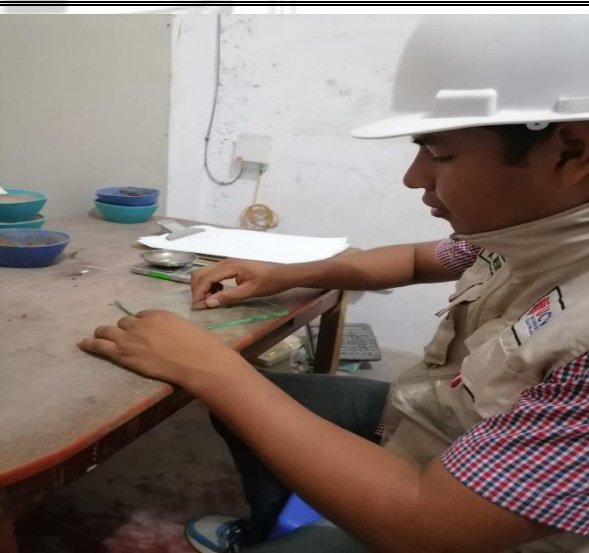
Fotos N° 07-08: En las imágenes podemos apreciar a nuestro personal realizando el ensayo de Límites de Atterberg.
