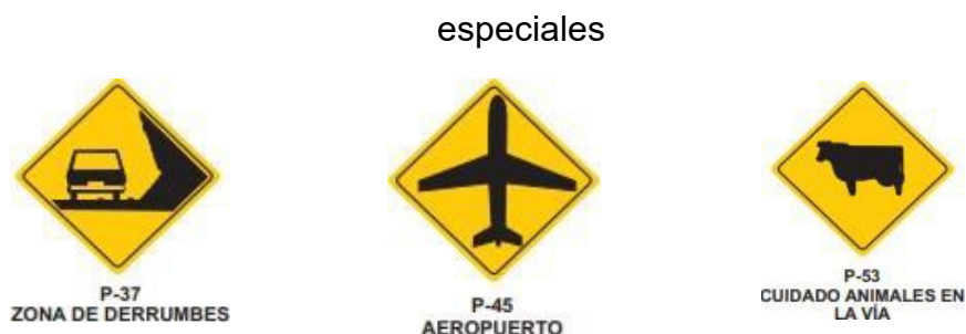
FIGURA N° 10: Señales preventivas para emergencias y otras situaciones
