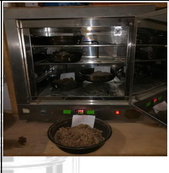
Fotos N° 09-10: En las imágenes podemos observar al personal técnico realizando el ensayo de contenido de humedad.
