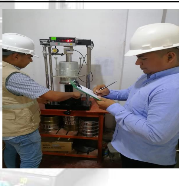
Fotos N° 11-12: En las imágenes podemos observar al personal técnico realizando el ensayo de C.B.R.
