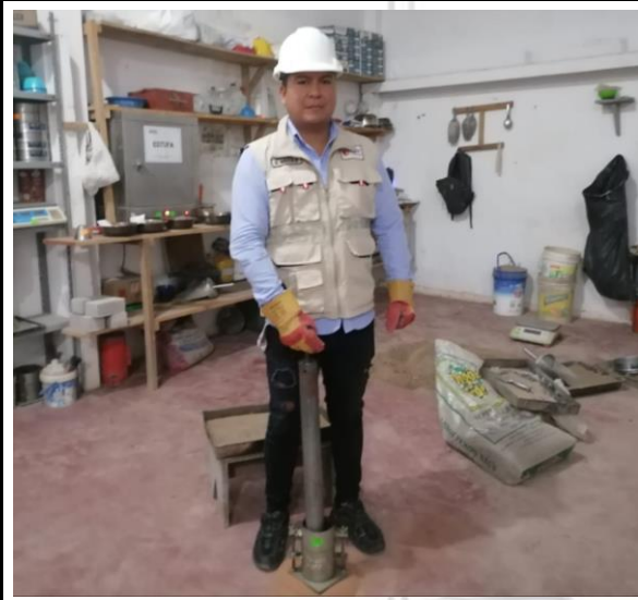
Fotos N° 05-06: En las imágenes podemos observar al personal realizando el ensayo de compactación (Proctor Estándar)
