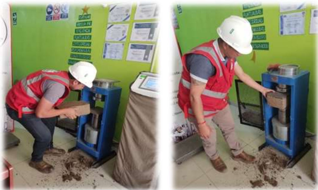
Figura 30 ensayo del del adobe con adición del 15% de asfalto bituminoso
