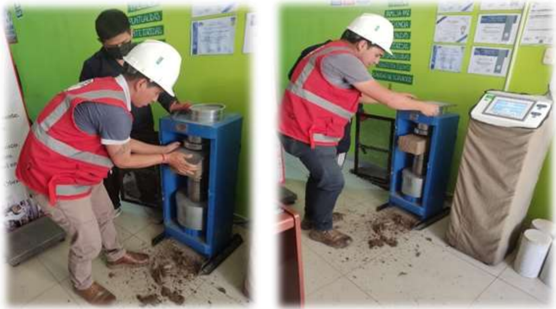
Figura 30 ensayo del del adobe con adición del 20% de asfalto bituminoso
