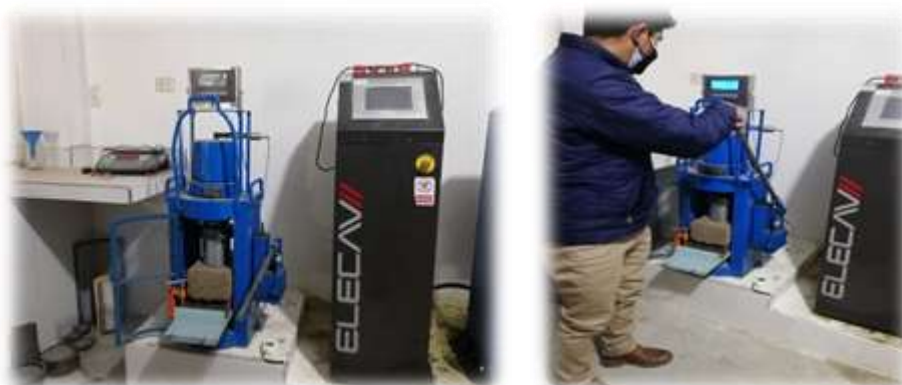
Figura 33 ensayo de resistencia a flexión de los adobes con adición del 15%
