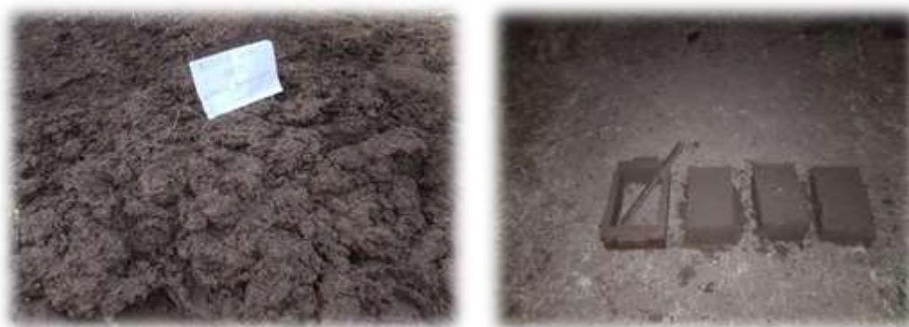
Figura 22 jalado de adobe con 20% de asfalto bituminoso
