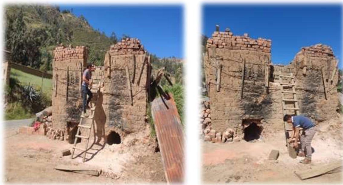
Figura 24 secado de los adobes en horno artesanal por 3 días
