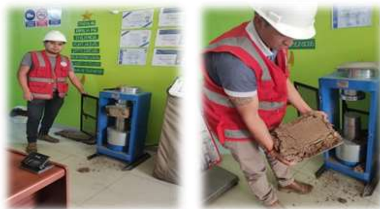
Figura 28 ensayo de resistencia a compresión del adobe patrón
