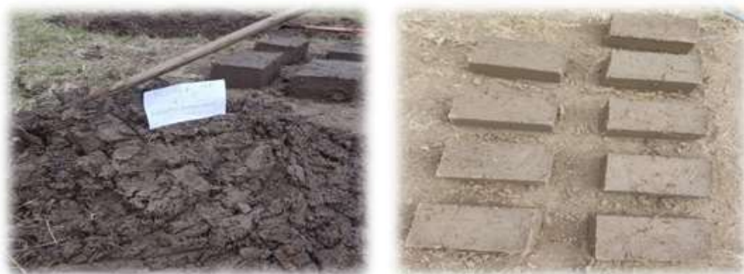
Figura 21 jalado de adobe con 15% de asfalto bituminoso
