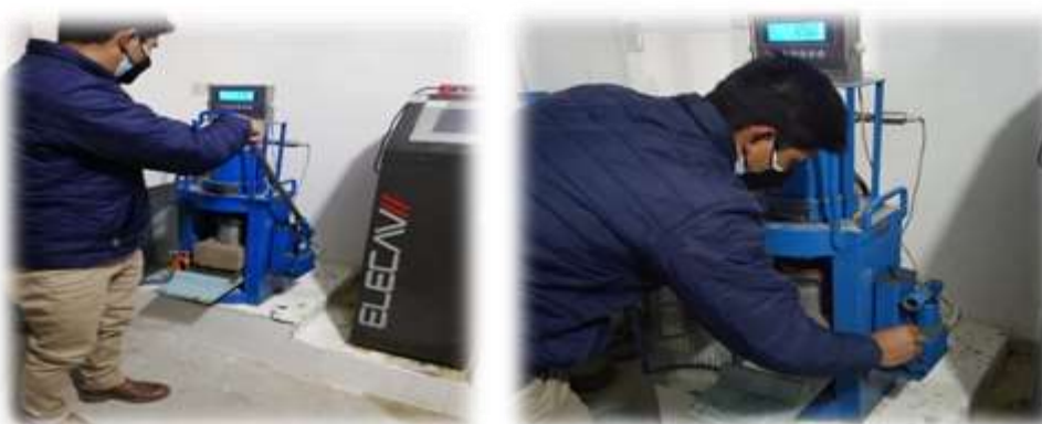
Figura 34 ensayo de resistencia a d flexión de los adobes con adición del 20%
