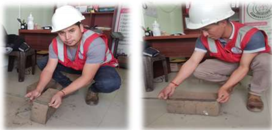
Figura 27 medición de las longitudes del adobe patrón y con aditivo
