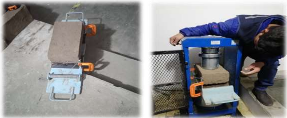
Figura 31 ensayo de resistencia a d flexión de los adobes patrones
