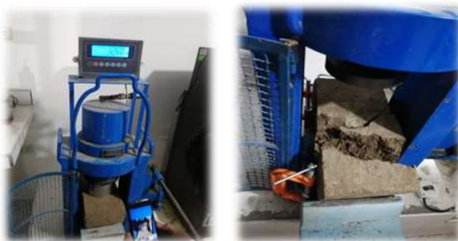
Figura 32 ensayo de resistencia a flexión de los adobes con adición del 10%
