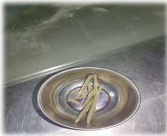
Figura 10 cortes de rollitos para limites liquido
