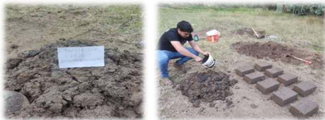
Figura 20 jalado de adobe con 10% de asfalto bituminoso
