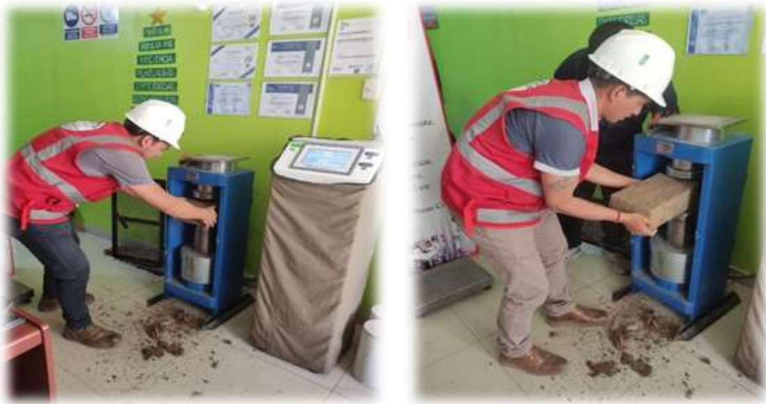
Figura 29 ensayo del del adobe con adición del 10% de asfalto bituminoso
