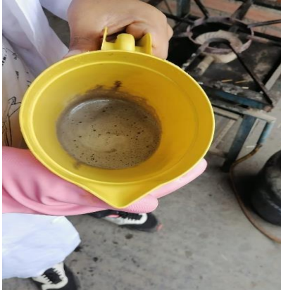
Imagen 84. Obtención de lignina a través de deslignización sódica
