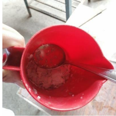
Imagen 80. Colocar 50 gramos de Hidróxido de Sodio en recipiente
