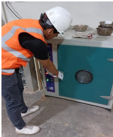
Imagen 57. Mezcla modificada resultante es colocada a un horno a 150 C°, 75 golpes por lado
