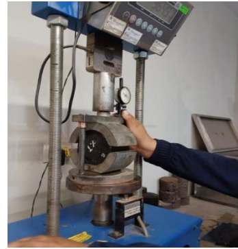
Imagen 74. determinar la estabilidad, índice de rigidez y resistencia a la compresión de las briquetas modificadas
