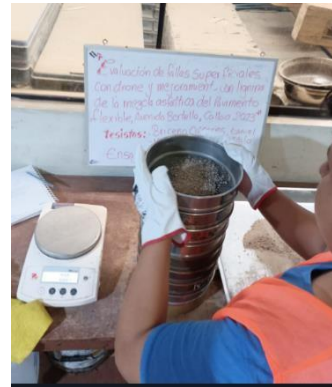
Imagen 50. Prueba de tamices de la arena de trituración
