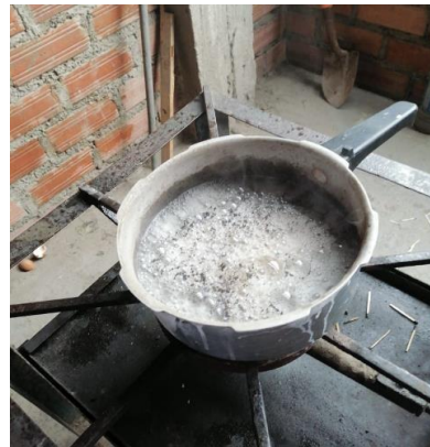
Imagen 82. Hervir durante 20 minutos el Hidróxido de sodio junto con los retasos de madera
