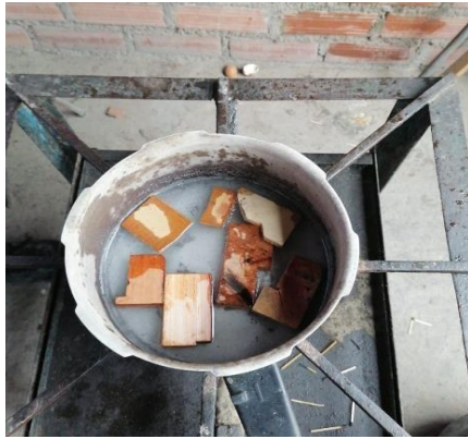
Imagen 79. Hervir los Retasos de madera para las impurezas del material
