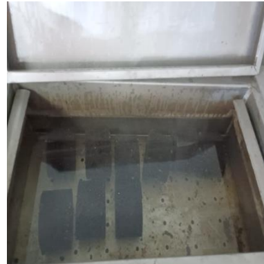
Imagen 70. Briquetas modificadas colocadas en baño de agua a 60 °C durante 30 minutos
