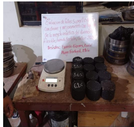
Imagen 58. Briquetas de mezcla asfáltica convencional de 4.6%,5.1%,5.6% y 6.1%
