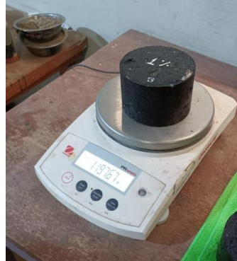
Imagen 62. Peso específico de cada briqueta de mezcla asfáltica modificada con lignina
