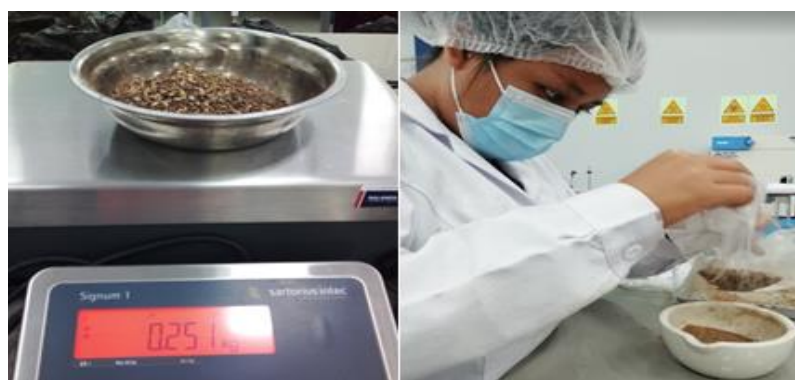
Figura 16. Pesado y tamizado de cáscaras de Cocos nucifera L.
