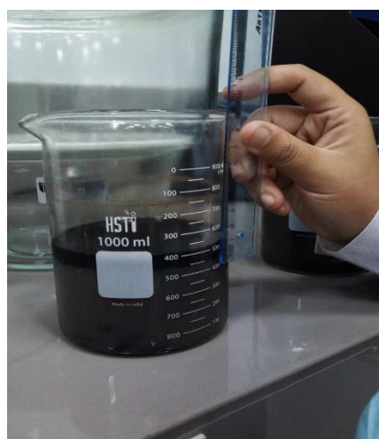
Figura 20. Medición de la cantidad de hidrocarburo presente en cada muestra
