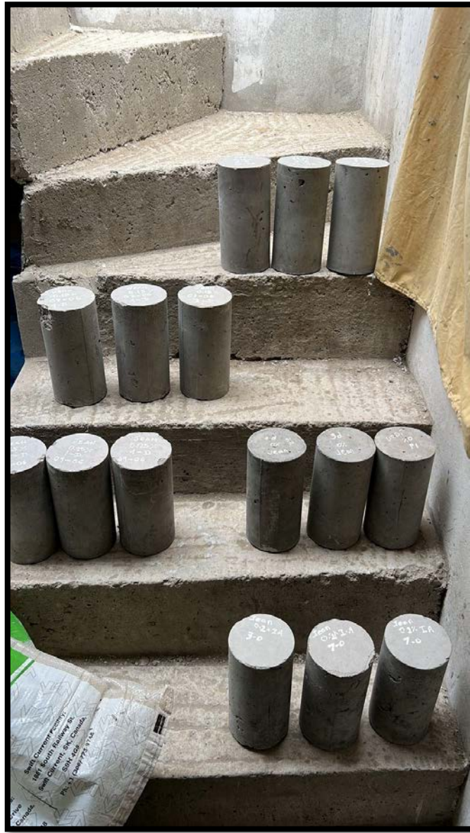
FOTOGRAFIA N°31 Especímenes para el ensayo de absorción
