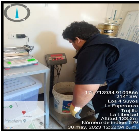
FOTOGRAFIA N°17 Pesaje del agregado fino
