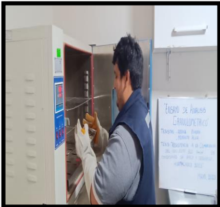
FOTOGRAFIA N°13 Secado de los materiales en el horno
