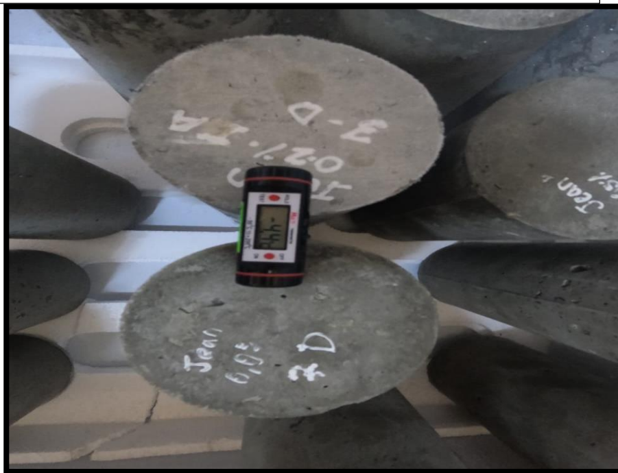
FOTOGRAFIA N°26 Primeros indicios de congelamiento en el concreto
