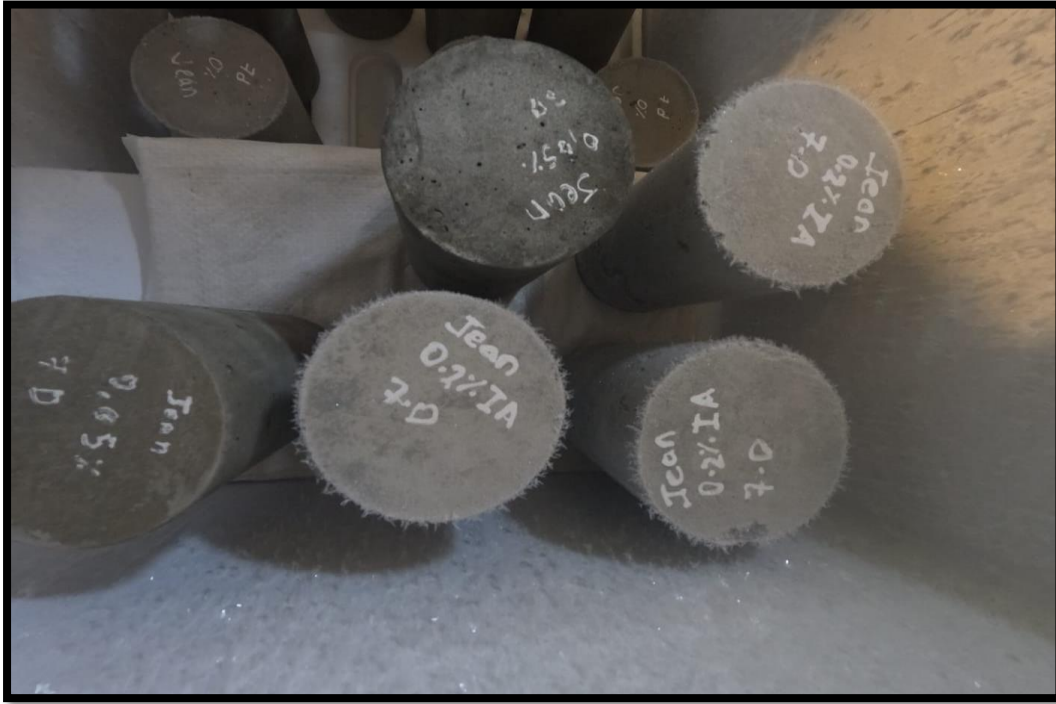
FOTOGRAFIA N°24 Colocación de las probetas al ciclo de congelamiento
