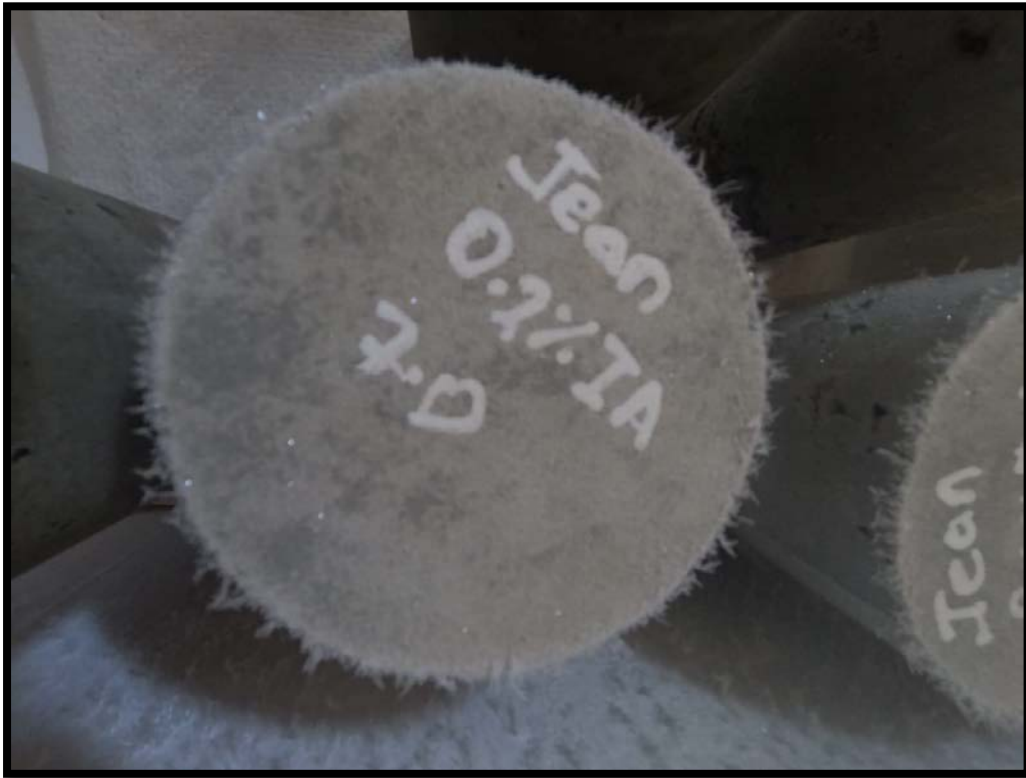
FOTOGRAFIA N°25 Primeros indicios de congelamiento en el concreto
