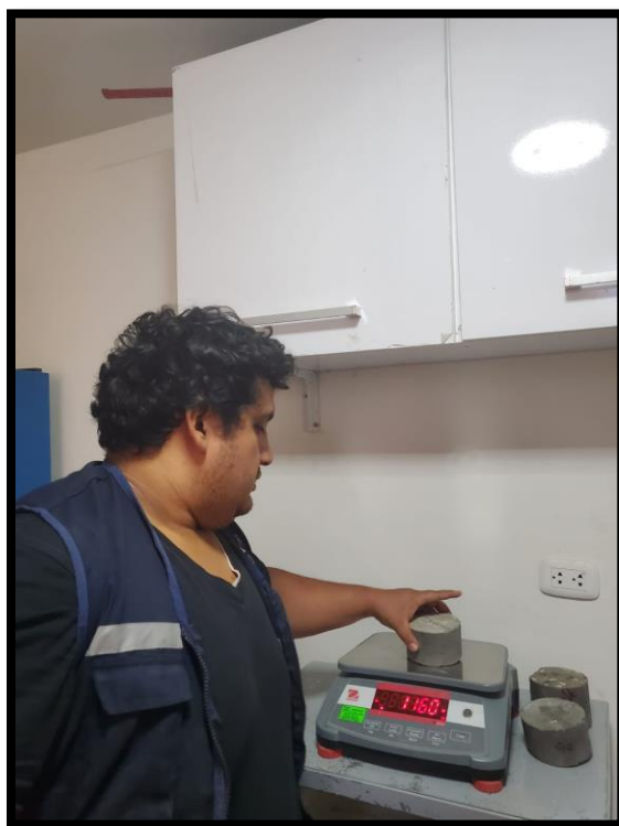
FOTOGRAFIA N°32 Especímenes cortados para el ensayo de absorción
