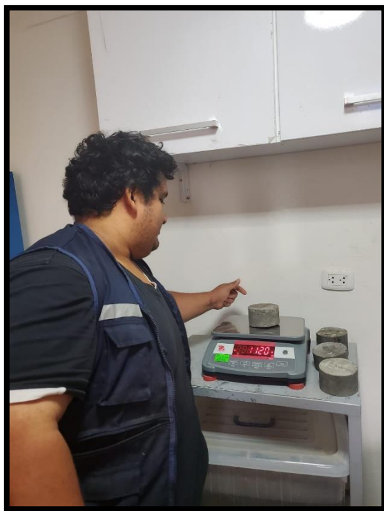
FOTOGRAFIA N°33 Revisando que los especímenes posean un peso mayor de 800g para ser analizados
