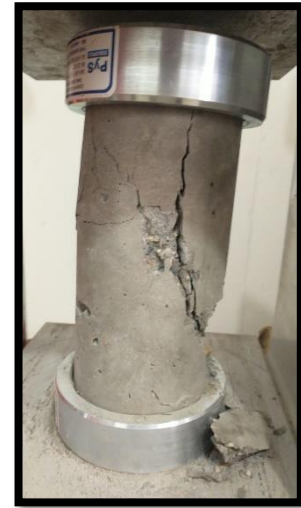
FOTOGRAFIA N°30 Rotura de las primeras probetas
