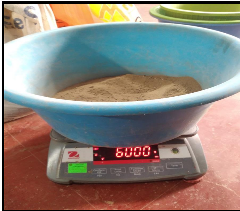
Peso de terreno natural, de 6 Kg para Proctor modificado.
