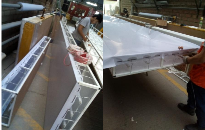
Figura 8: Instalación de sistema eléctrico y templado de lona
