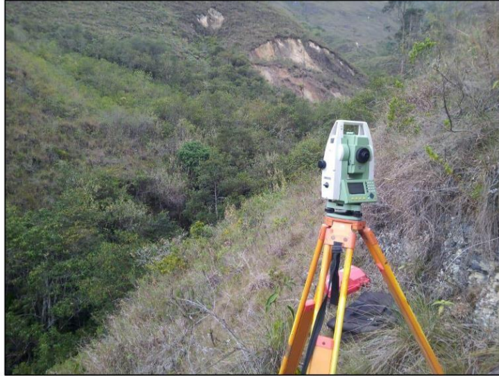
TOMA N° 03: Levantamiento topográfico de la franja de línea proyectada.
