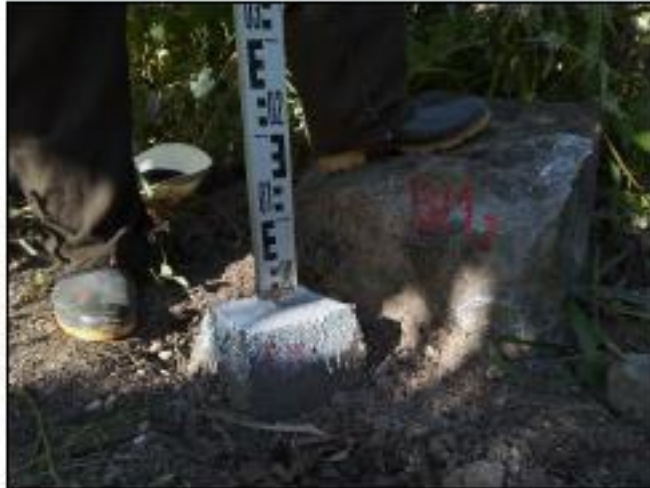
TOMA N° 04: Hito de referencia, nivelación de BMs.
