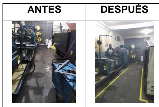
Figura 19: Señalización en el área de trabajo
