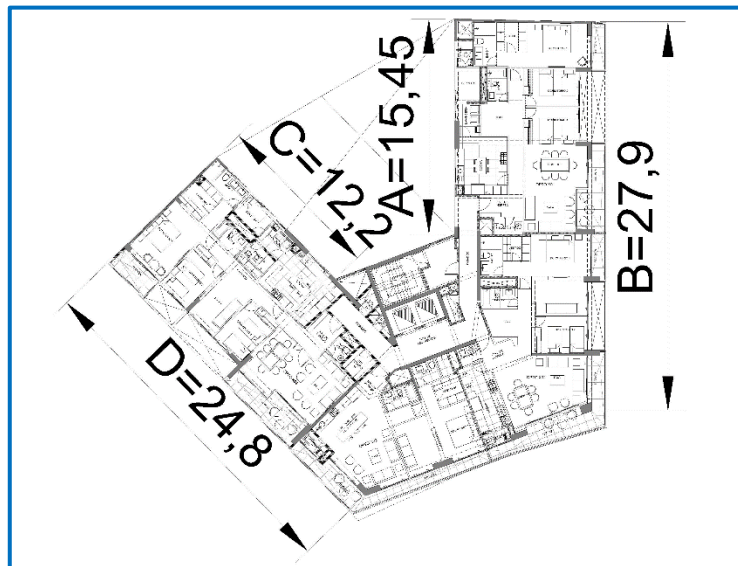
Figura 4.5. Vista en planta, esquinas entrantes
