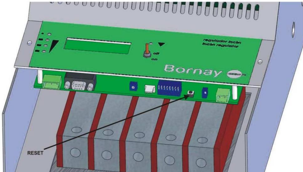
Figura 32. Ubicación de micro-pulsador de Reset de circuito impreso ubicado en la tarjeta de control del regulador
