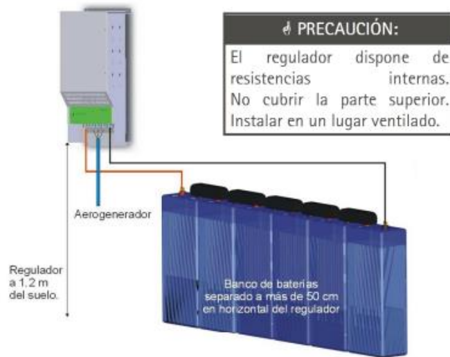
Figura 25. Instalación segura de Regulador y el Banco de Baterías
