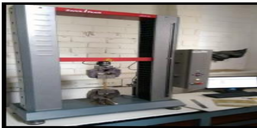
Foto N° 1 Prueba de Tracción
