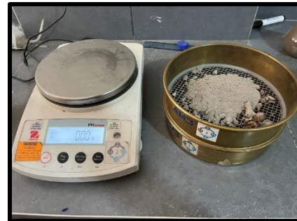
Pesando los agregados
