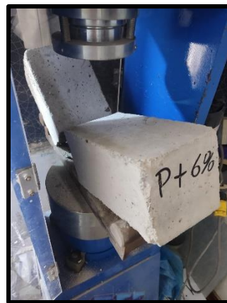
Se observa el quiebre de la viga
