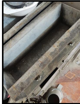
Molde rectangular para vigas
