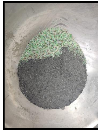
Mezcla de la ceniza volante de carbón y PET
