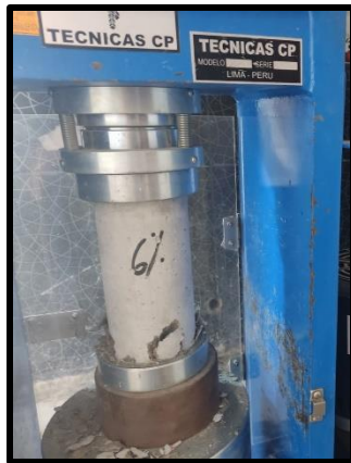
Se observa la ruptura
