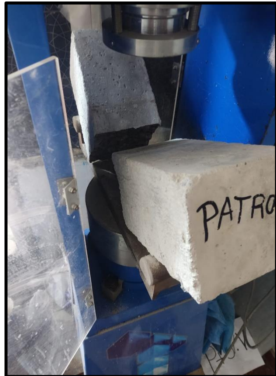
Figura 21. Viga de concreto flexionad.
