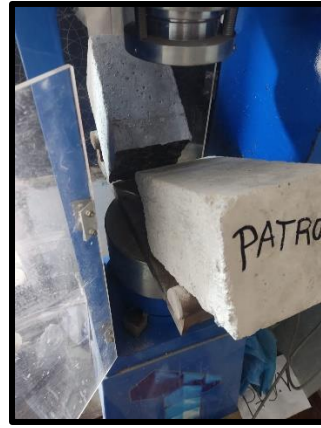
Se observa el quiebre de la viga
