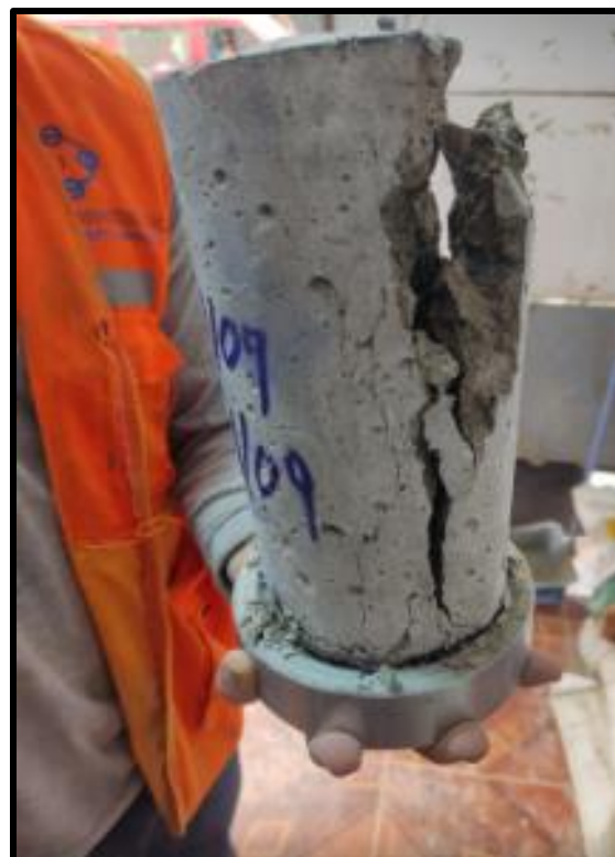
Figura 18. Probeta de concreto compactada.
