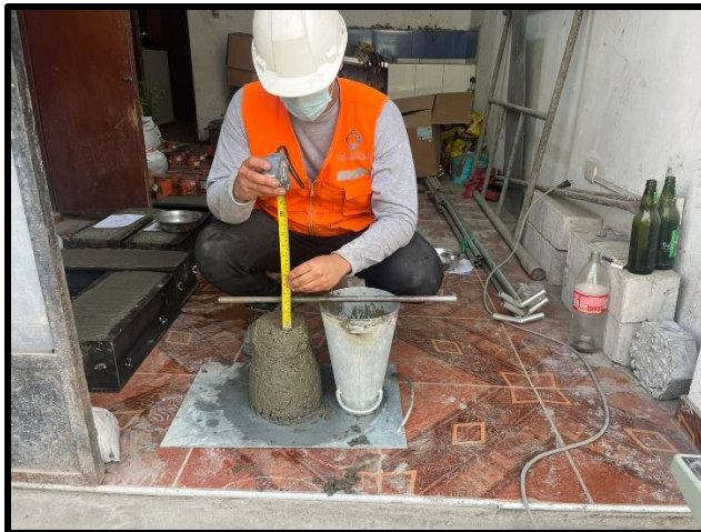
Figura 13. Medición del asentamiento del concreto de cemento portland.
