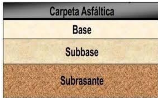
Figura 2. Capas estructurales del pavimento flexible
