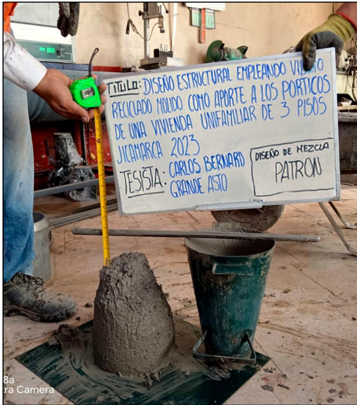
Asentamiento y elaboración de probetas cilíndricas y rectangulares.
