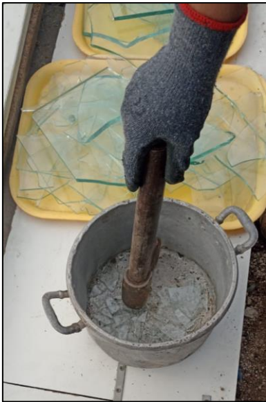
Trituración del vidrio flotado, embaces y botellas .
