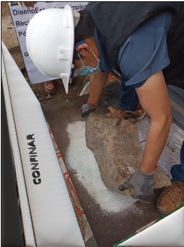
Molienda del vidrio flotado, embaces y botellas.
