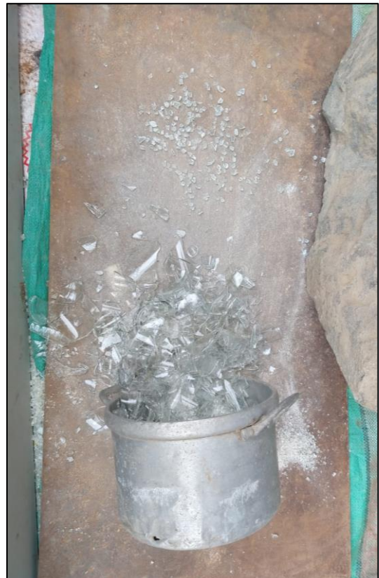
Molienda del vidrio flotado, embaces y botellas.
