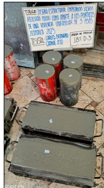
Asentamiento y elaboración de probetas cilíndricas y rectangulares.
