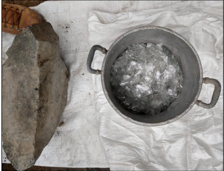
Trituración del vidrio flotado, embaces y botellas .
