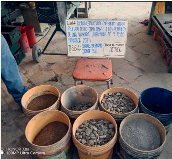
Dosificación para el diseño de mezcla patrón.
