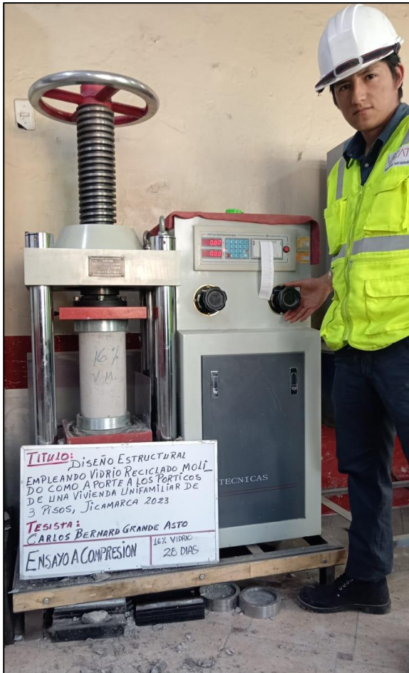
Resistencia a la compresión de las probetas del diseño con sustitución del 16% y 18% de VRM a los 28 días.
