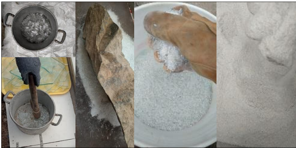
Figura 8. Proceso de trituración y molienda del vidrio. Fuente: Elaboración propia.
