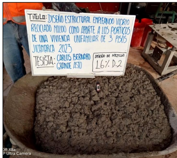
Dosificación para el diseño de sustitución por el 16% del volumen del agregado fino.
