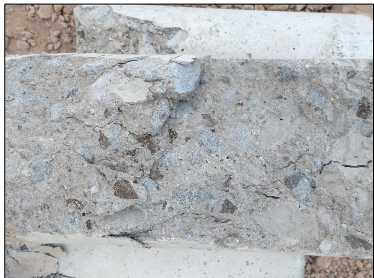
Vista transversal de la estructura del concreto con sustitución de VRM, a 7 días.
