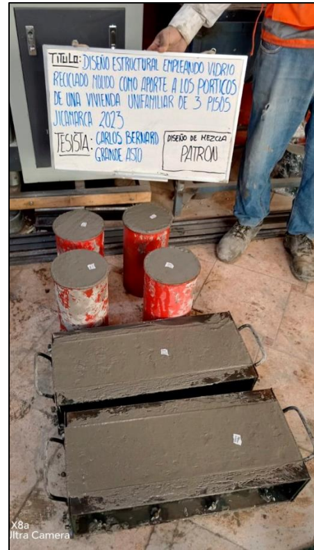
Asentamiento y elaboración de probetas cilíndricas y rectangulares.
