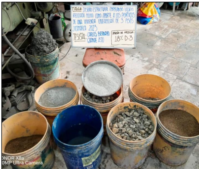
Dosificación para el diseño de sustitución por el 18% del volumen del agregado fino.
