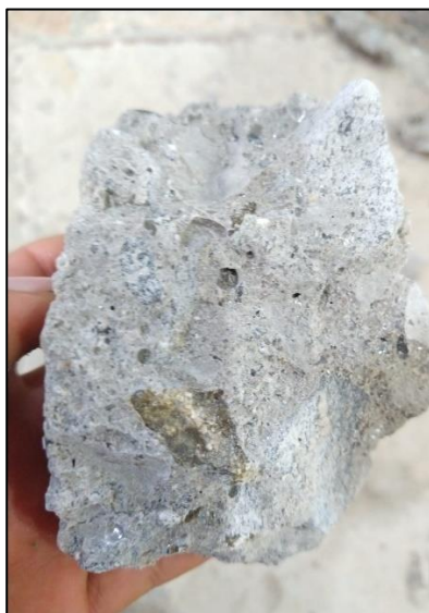
Vista transversal de la estructura del concreto con sustitución de VRM, a 7 días.
