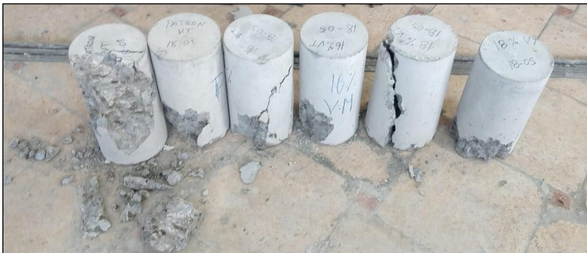
Tipos de fallas en el concreto con sustitución del 16% y 18 % de VRM, a los 28 días.
