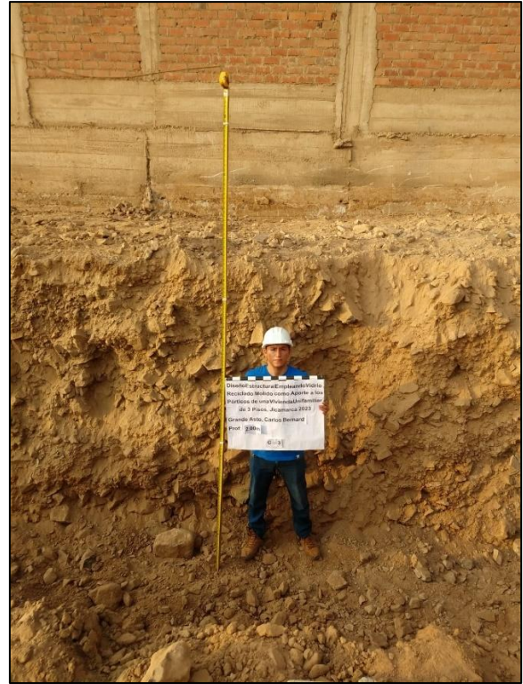
Profundidad de excavación de calicatas C-2 y C-3.
