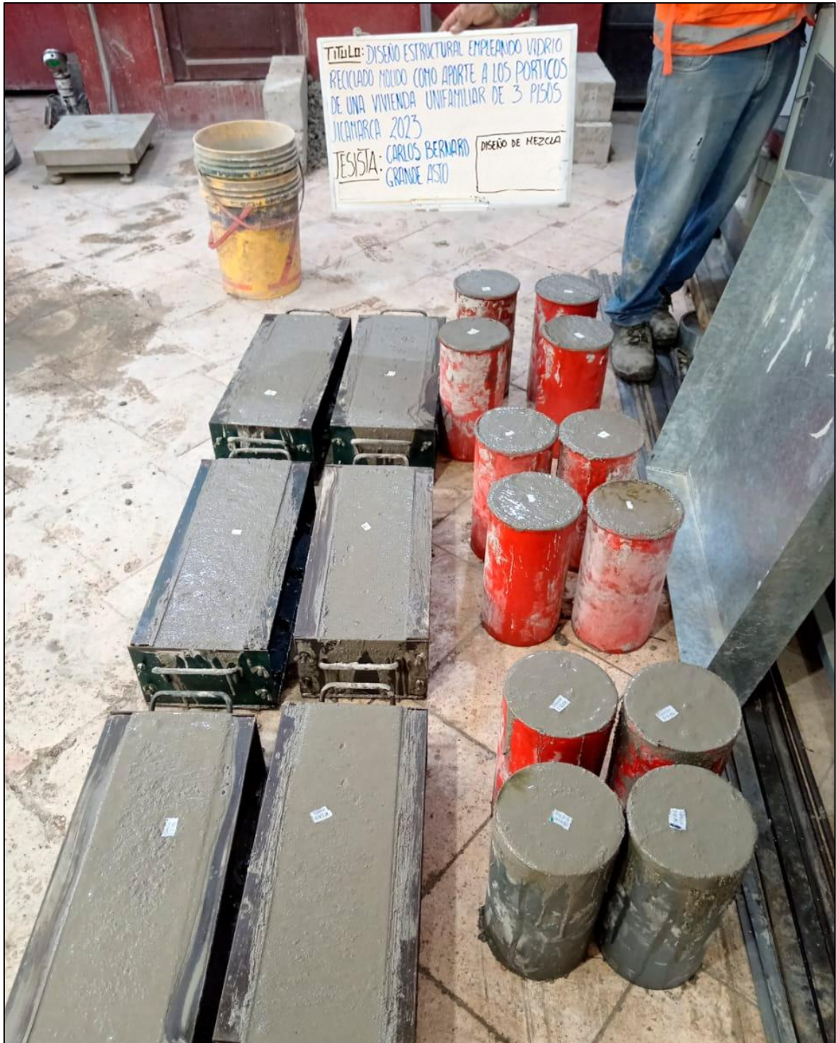
Probetas elaboradas para observar sus propiedades a los 7 y 28 días de curadas.
