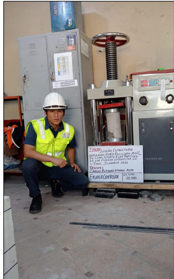
Resistencia a la compresión de las probetas del diseño con sustitución del 16% y 18% de VRM a los 28 días.
