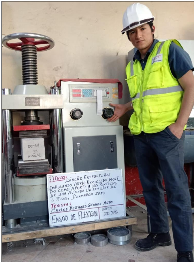
Resistencia a la flexion de las probetas rectangulares, diseño patrón a los 28 días.
