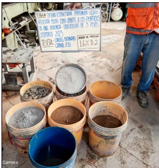
Dosificación para el diseño de sustitución por el 16% del volumen del agregado fino.
