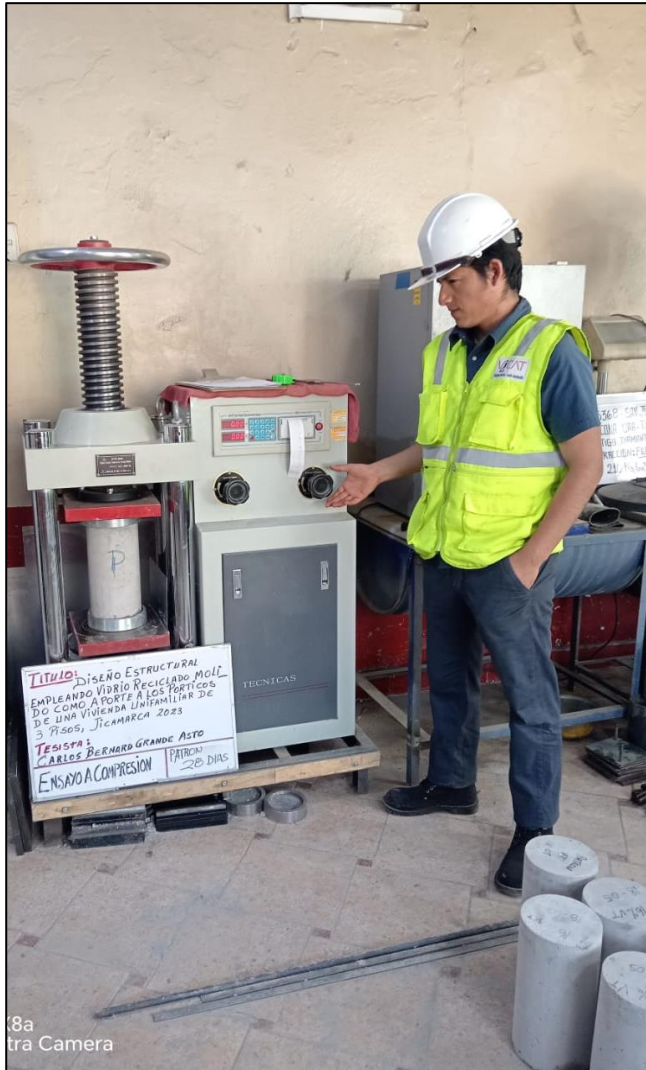
Resistencia a la compresión de las probetas del diseño patrón a los 28 días.
