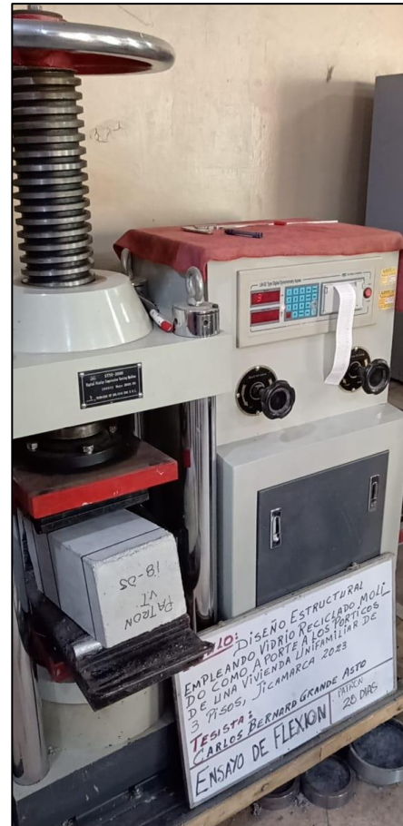
Resistencia a la flexion de las probetas rectangulares, diseño patrón a los 28 días.
