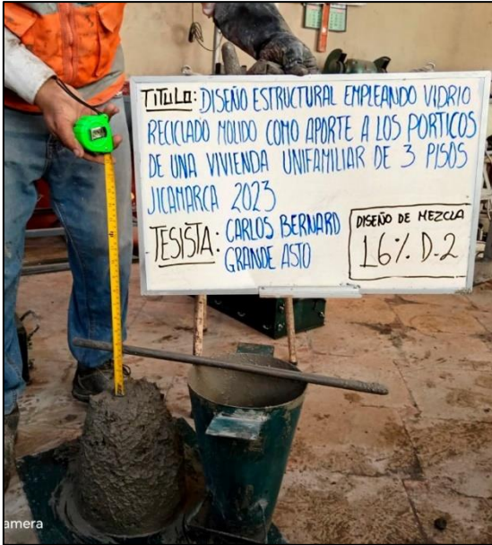
Asentamiento y contenido de humedad del concreto con 16% de VRM.
