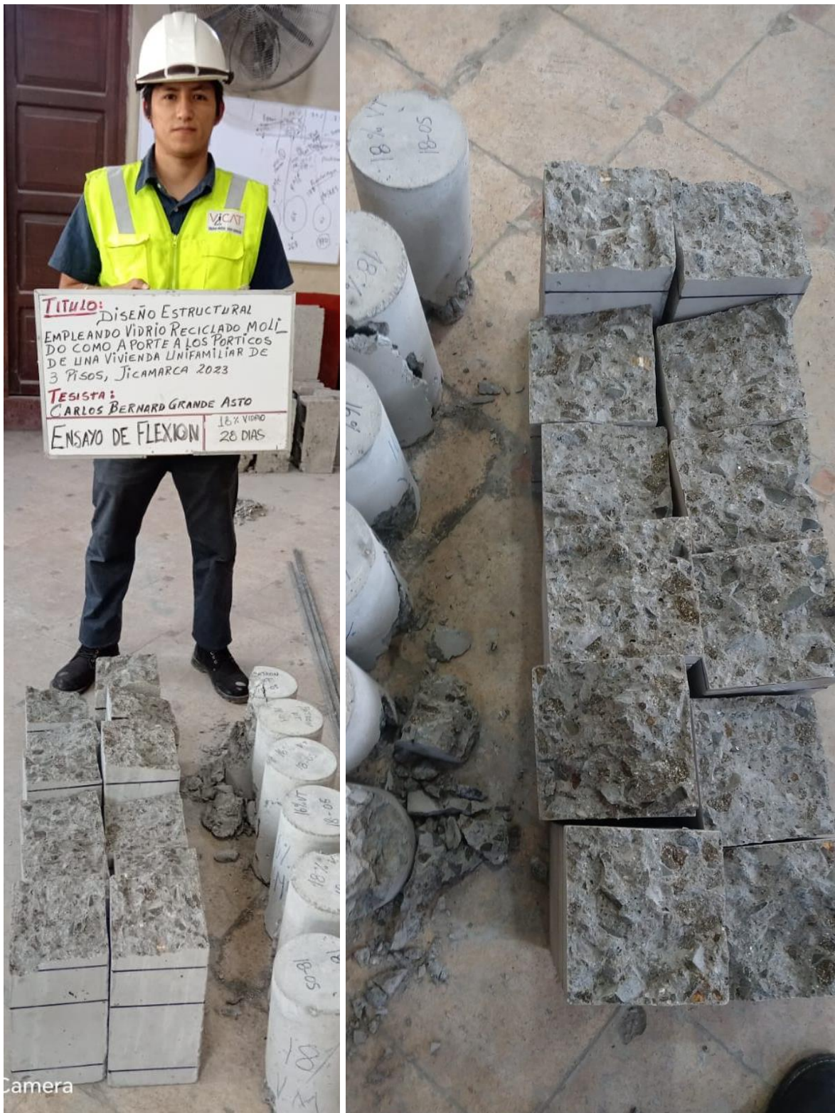
Estructura de las interfases del concreto de las probetas rectangulares a 28 días.
