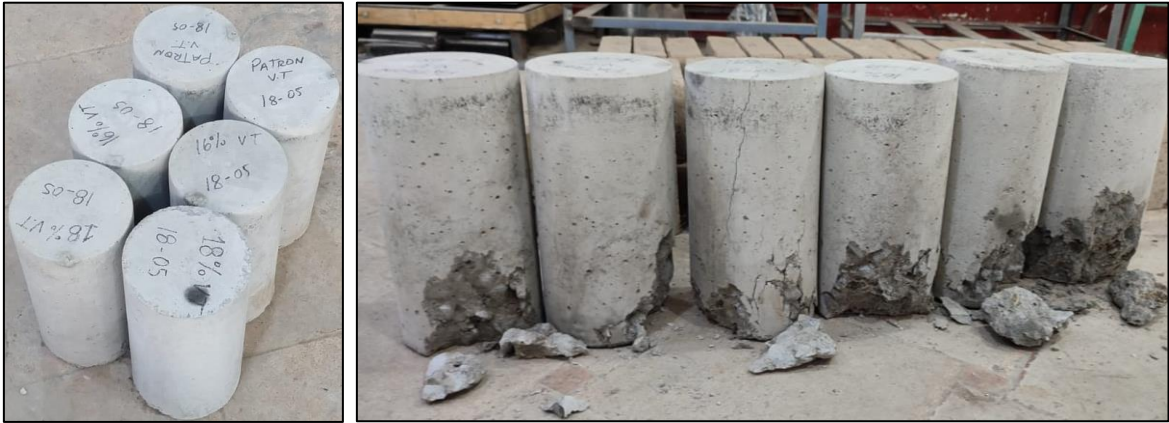
Ensayo de resistencia a la compresión a los 7 días de curado.
