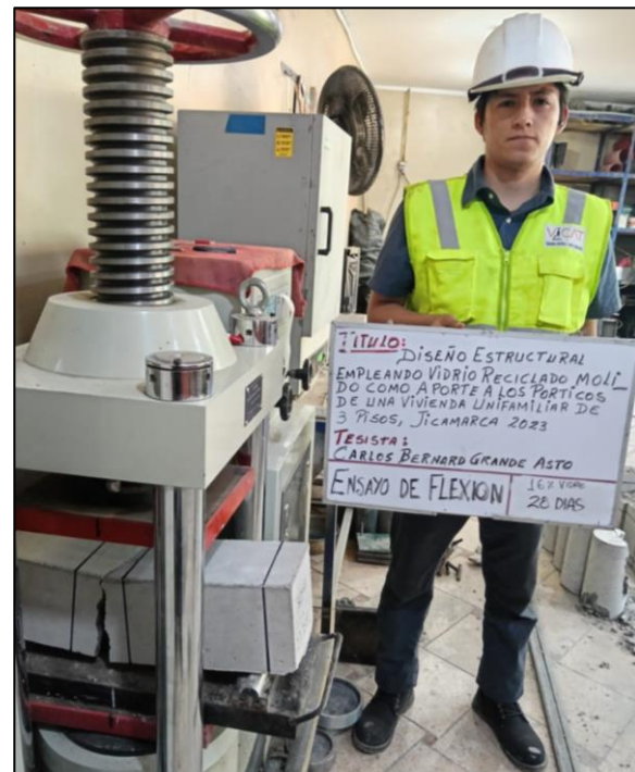
Resistencia a la flexion a los 28 días de los diseños de 16% y 18% de VRM.
