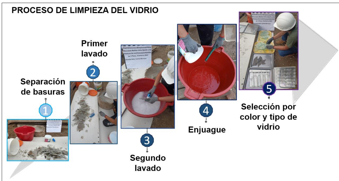
Figura 7. Flujograma de la limpieza del vidrio. Fuente: Elaboración propia.
