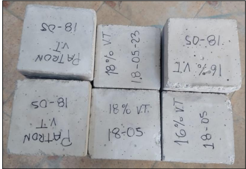
Ensayo de resistencia a la compresión y flexión a los 28 días de curado.
