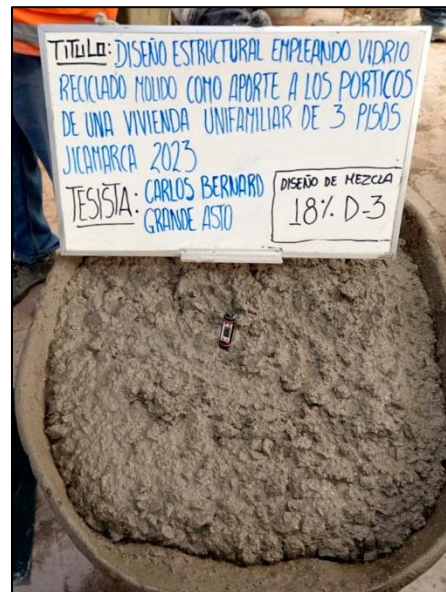
Dosificación para el diseño de sustitución por el 18% del volumen del agregado fino.
